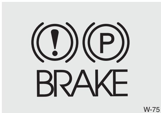
Vérifier le témoin de stationnement au moment de tourner le commutateur d'allumage à ON (ne pas démarrer le moteur). Ce témoin s'allume en engageant le frein de stationnement lorsque le commutateur d'allumage est en position START ou ON.
