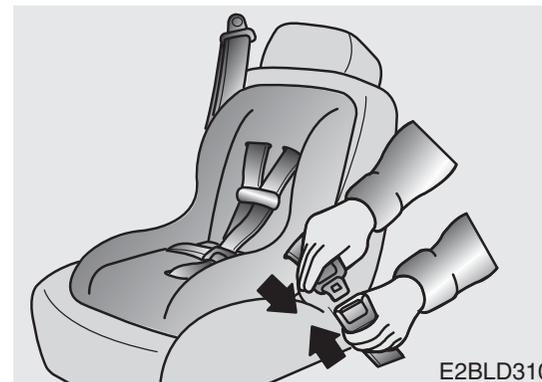
2. Insérer la languette de la ceinture ventrale/épaule dans la boucle. Un dé clic confirme le verrouillage.
