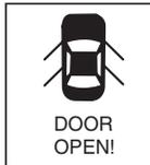
Cette lampe témoin s'allume lorsqu'une porte n'est pas bien fermée alors que la clé d'allumage est à n'importe quelle position. Et l'afficheur va allumer le témoin correspondant à la position de la porte qui n'est pas bien fermée.
