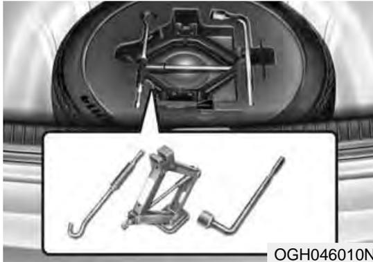
Le pneu de secours, le cric, la poignée du cric pour les écrous de roue sont rangés dans le coffre. Soulever la moquette pour atteindre les équipements.
