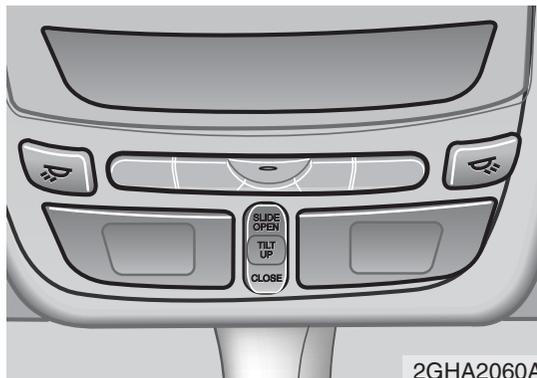
Ouvrir ou incliner le toit glissant/ dépliant des véhicules qui en sont équipés par le biais des commutateurs situés sur la console de plafond.
