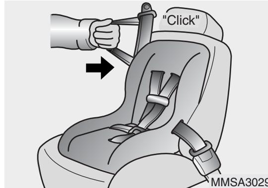
4. Laisser la ceinture se rétracter lentement en tirant vers le haut sur la sangle. Le cliquetis entendu indique que le rétracteur est maintenant en mode de verrouillage automatique. Si vous n'entendez aucun cliquetis, répétez les étapes 3 et 4.
