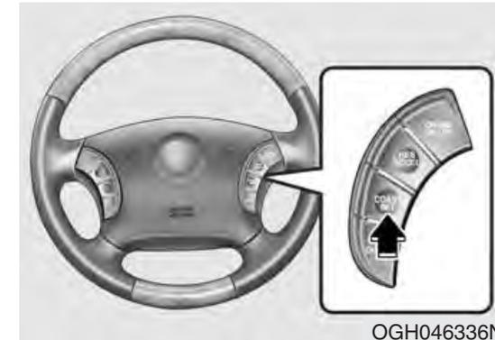
3. Appuyer sur l'interrupteur COAST/ SET situé sur le volant et le relâcher lorsque la vitesse désirée est atteinte. Le témoin lumineux "SET" du tableau de bord s'allume alors. Relâcher l'accélérateur au même moment. La vitesse désirée est maintenue automatiquement.
