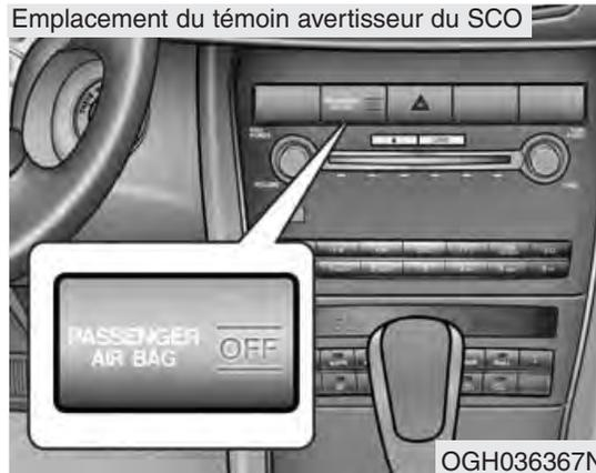
Si l'occupant du siège passager avant est de faible poids (par exemple un enfant), il est possible que le témoin du siège passager PASSENGER AIR BAG OFF s'allume (ON).
