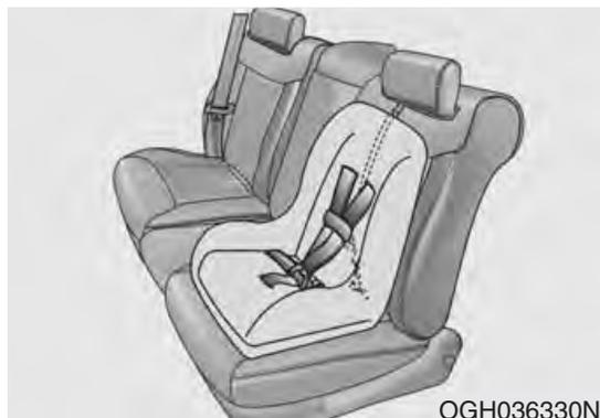
2. Passer la courroie du siège de retenue d'enfant par dessus le siège arrière.
