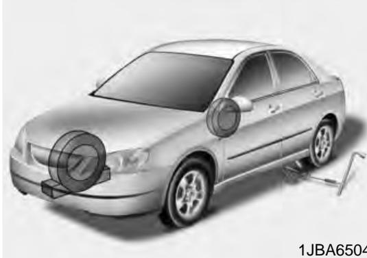
4. Retirer la clé d'écrou de roue, le cric, la poignée de cric et le pneu de secours du véhicule.
