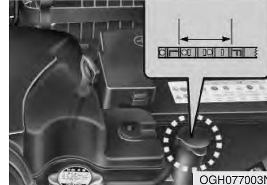
Vérifier l'état et les raccords de tous les tuyaux du système de refroidissement et de chauffage, et remplacer les tuyaux enflés ou endommagés.
