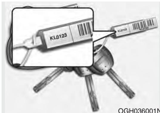
Le numéro de code de clé est estampillé sur la plaquette attachée au porte-clés. En cas de perte des clés, ce numéro permet à un concessionnaire Kia agréé d'en faire facilement des doubles. Retirer la plaquette et la ranger en lieu sûr. Relever également le numéro de code et le garder en un endroit sécuritaire et pratique, ailleurs que dans le véhicule.
