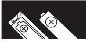
Montez les piles en respectant le sens des polarités (+/-) marquées sur les piles et sur le compartiment de piles. Un mauvais positionnement peut provoquer une fuite du liquide des piles et, dans les cas extrêmes, un incendie ou une explosion.
