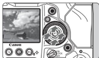
Vous pouvez utiliser l'appareil photo silencieusement en touchant simplement le haut, le bas, la gauche ou la droite de <**+**>. Pendant l'enregistrement vidéo, vous pouvez appuyer sur <**Q**> pour afficher l'écran de contrôle rapide et changer les réglages ci-dessous avec <**+**>.
