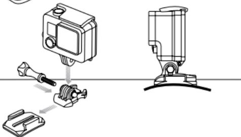
**ASTUCE :** Appliquez les supports adhésifs sur des surfaces propres et lisses à température ambiante uniquement, au moins 24 heures avant d'utiliser l'équipement. Pour les retirer, chauffez les supports à l'aide d'un sèche-cheveux puis détachez-les.
