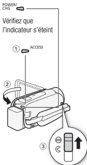
Assurez-vous que le caméscope a terminé d'écrire les scènes ou les photos sur la mémoire avant de mettre l'appareil hors tension.
