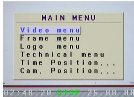
• Le menu vidéo est incrusté dans le moniteur lorsque le bouton "Menu" est activé. Un message d'alerte apparaît alors sur l'afficheur du VHR, signifiant que le menu principal est visible sur le moniteur (cf p 26).
