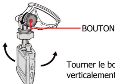
Tourner le bouton pour pivoter l'appareil verticalement
