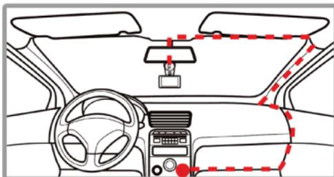
Conecte o adaptador veicular ao encaixe de alimentação da câmara, e então conecte a outra parte ao acendedor de cigarros do veículo. (Obs.: esta configuração é só uma recomendação. Você poderá optar por diferentes modos para instalar o cabo de alimentação em seu veículo.)
