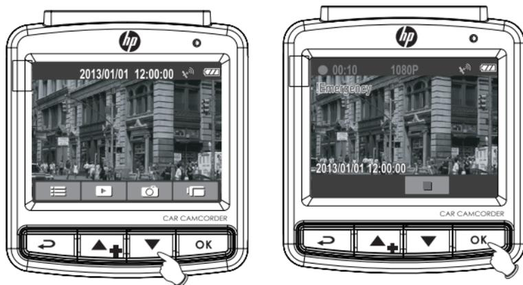
Durante a gravação de vídeo, pressione o botão OK para aceder ao modo de Gravação de Emergência. A mensagem "Emergência" será apresentada imediatamente no canto superior esquerdo do ecrã, e o ficheiro gravado será protegido. Se a função de Detecção de Colisão estiver activada e uma colisão for detectada, o equipamento accionará automaticamente o recurso de gravação de emergência.
