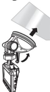
Con la ventosa en posición hacia abajo, coloque la ventosa sobre el parabrisas.
