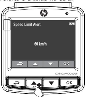
Pressione os botões ▲/▼ para ajustar a velocidade limite. Você poderá ajustar o limite de velocidade de 50 km/h a 200 km/h.
