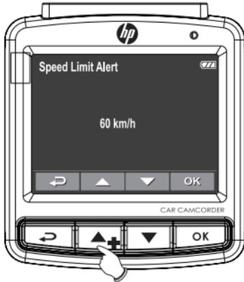
Hız limitini ayarlamak için ▲/▼ düğmelerini kullanınız. Hız limitini 50 km/s ile 200 km/s aralığında ayarlayabilirsiniz.
