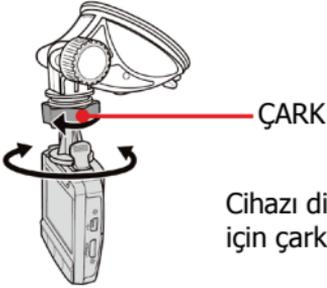
Cihazı dikey olarak 360° ye kadar döndürmek için çarkı çeviriniz.
