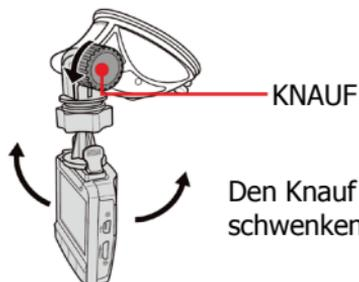
Den Knauf rotieren, um das Gerät vertikal zu schwenken.
