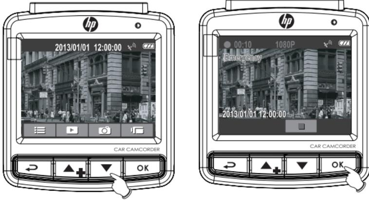
Video Kaydı sırasında, Acil Durum kaydı moduna girmek için düğmesine basınız, ekranın sol üst köşesinde "Acil Durum" mesajı gösterilecek ve kaydedilen dosya korunacaktır. Eğer Çarpışma Algılaması özelliği açık ise ve çarpışma algılandıysa, cihaz otomatik olarak acil durumu kaydı işlemini başlatacaktır.
