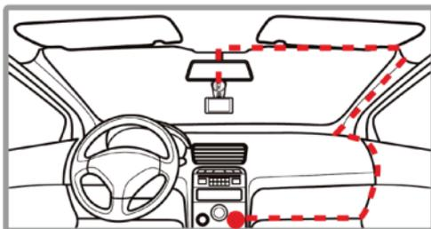
Podłącz zasilacz samochodowy do gniazda zasilania w kamerze, a następnie podłącz drugi koniec do gniazda zapalniczki pojazdu. (Uwaga: Przedstawiono konfigurację zalecaną. Możesz jednak wybrać inny sposób poprowadzenia kabla.)
