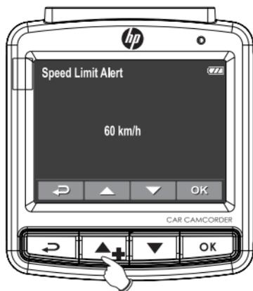
Pulse el botón ▲/▼ para fijar el límite de velocidad. Puede configurar el límite de velocidad desde 50 km/h a 200 km/h.
