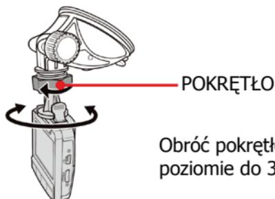
Obróć pokrętkę, aby obrócić urządzenie w poziomie do 360°.
