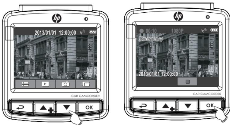
Tijdens een video-opname drukt u op de OK knop om naar de Noodopname Modus te gaan. De tekst "Emergency" zal meteen linksboven in het beeldscherm verschijnen. De opname wordt nu beveiligd. Indien de Botsingdetectie is geactiveerd en een botsing wordt waargenomen, zal het apparaat automatisch een noodopname beginnen.
