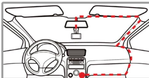
Συνδέστε τον αντάπτορα του αυτοκινήτου στο ρευματοδότη της Κινητής Κάμερας και έπειτα συνδέστε το άλλο άκρο στην υποδοχή του αναπτήρα του αυτοκινήτου.
