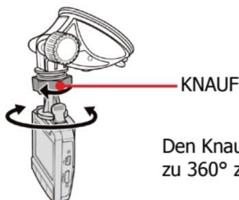
Den Knauf rotieren, um das Gerät horizontal bis zu 360° zu schwenken.
