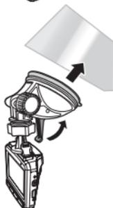
Atache o suporte ao equipamento. Deslize a câmara para dentro do fixador do suporte até ouvir o clique de encaixe.
