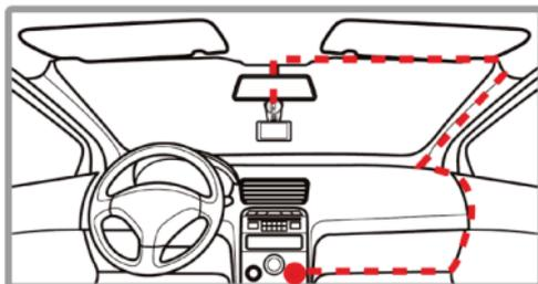
Raccordez l'adaptateur pour véhicule au connecteur d'alimentation de la caméra mobile, puis branchez l'autre extrémité dans la prise de l'allumecigare du véhicule.
