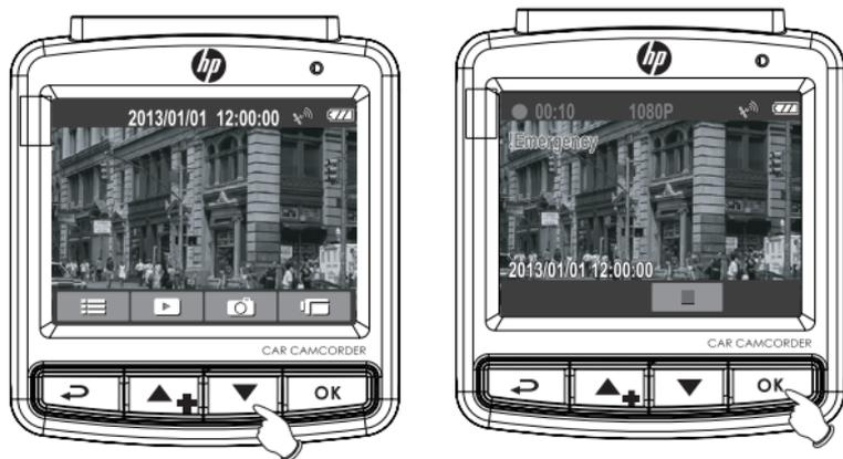
Lors de l'enregistrement vidéo, appuyez sur le bouton OK pour aller dans le mode enregistrement d'urgence. Le message "Urgence" s'affichera immédiatement sur le coin supérieur gauche de l'écran et le fichier enregistré sera protégé. Si la fonction Détection de collision est activée et qu'une collision est détectée, l'appareil déclenchera automatiquement la fonction d'enregistrement d'urgence.
