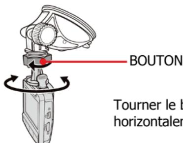
Tourner le bouton pour pivoter l'appareil horizontalement jusqu'à 360°
