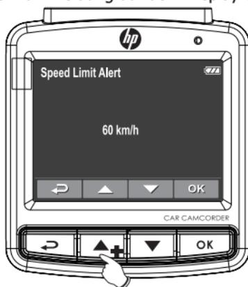
Zum Einstellen der Geschwindigkeitsgrenze auf die ▲/▼ -Taste drücken. Die Geschwindigkeitsgrenze kann zwischen 50 km/h und 200 km/h eingestellt werden.
