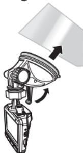
Attaccare il supporto al dispositivo. Farlo scivolare nel supporto della staffa fino a quando si sente un suono clic.
