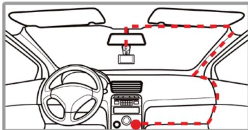
Verbind de auto adapter met de stroomaansluiting van de mobiele camera en plug het andere eind van de kabel in de sigarettenaansteker van het voertuig. *(Opmerking: Dit is slechts een aanbevolen configuratie. U kunt de camera ook op een andere wijze met een stroombron verbinden.)*
