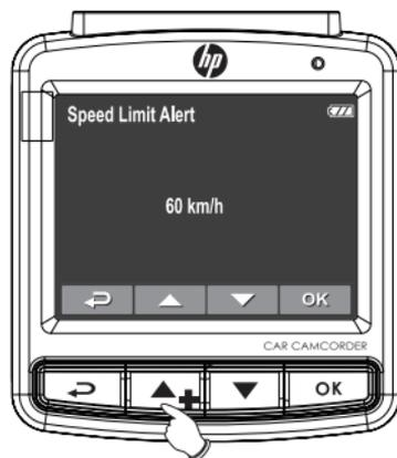
Premere il pulsante ▲/▼ per impostare il limite di velocità. Si può impostare il limite di velocità fra 50 km/h e 200 km/h.
