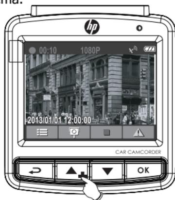
Pressione os botões ▲/+ para adicionar um ponto de radar de velocidade.
