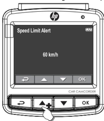
Appuyez sur le bouton ▲/▼ pour régler la limite de vitesse. Vous pouvez régler la limite de vitesse entre 50 km/h et 200 km/h.
