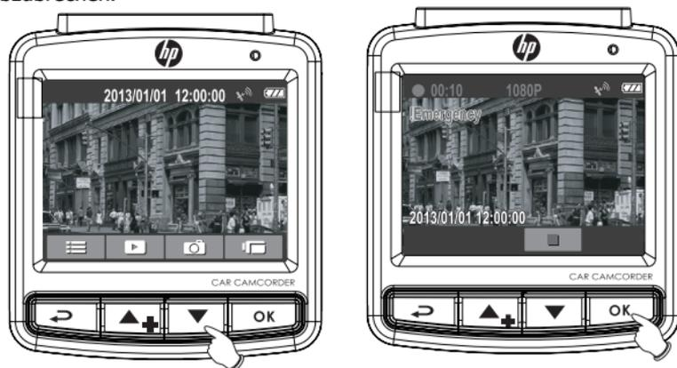
Während einer Videoaufzeichnung drücken Sie auf die OK-Taste, um den Modus zur Aufzeichnung eines Notfalls zu aktivieren, wobei die "Notfall"-Meldung unverzüglich in der oberen linken Ecke des Displays erscheint und dabei die aufgezeichnete Datei geschützt wird. Falls die Kollisionserkennungsfunktion aktiviert ist und eine Kollision wahrgenommen wird, löst das Gerät die Funktion zur Aufzeichnung des Notfalls automatisch aus.
