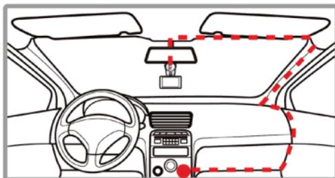
Conecte el adaptador de coche para el conector de alimentación de la leva de la era móvil y luego conecte el otro extremo a la toma del encendedor del vehículo.
