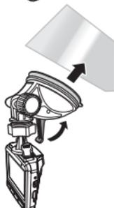
Επισυνάψτε το στήριγμα στη συσκευή. Σύρετε τη μέσα στο κράτημα του στηρίγματος μέχρι να ακούσετε ένα κλικ.
