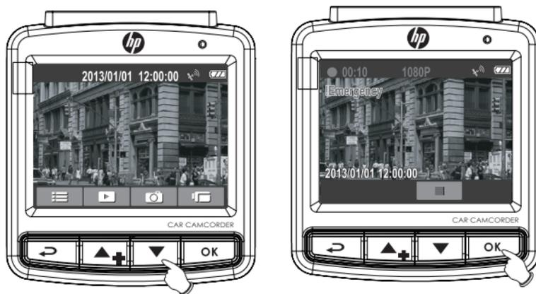
Under video-optagelse, tryk på OK knappen for at komme ind I akut-optagelsestilstand, "nødsituation" -meddelelsen vises straks I øverste venstre hjørne af skærmen, og den optagne fil vil blive beskyttet. Hvis kollisions-detektion-funktionen er aktiveret, og en kollision er opdaget, vil enheden automatisk udløse akut optagelses-funktion.
