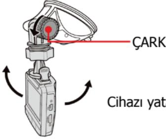
Cihazı yatay olarak döndürmek için çarkı çeviriniz.
