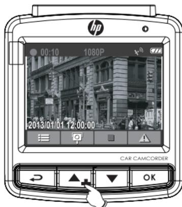
Zum Hinzufügen eines Standorts einer Geschwindigkeitskamera auf die ▲/+ -Taste drücken.
