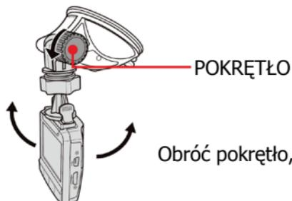
Obróć pokrętkę, aby obrócić urządzenie w pionie.
