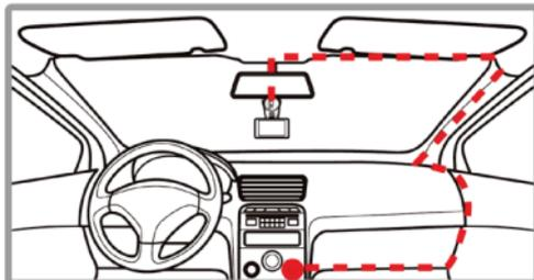
Den Auto-Adapter an den Stromanschluss der Mobilkamera und danach das andere Ende an den Zigarettenanzünder im Fahrzeug anschließen.
