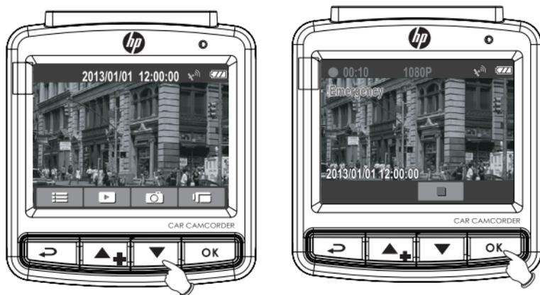
Durante la registrazione del Video, premere il pulsante OK per accedere alla modalità Registrazione di Emergenza, immediatamente viene mostrato il messaggio "Emergency" nell'angolo sinistro in alto dello schermo e il file registrato sarà protetto. Se è attivata la funzione Rilevamento Collisione e viene rilevata una collisione, il dispositivo automaticamente fa scattare la funzione di registrazione di emergenza.
