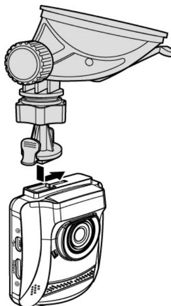
2. Avec la ventouse posée à plat, positionnez-la sur le pare-brise.
