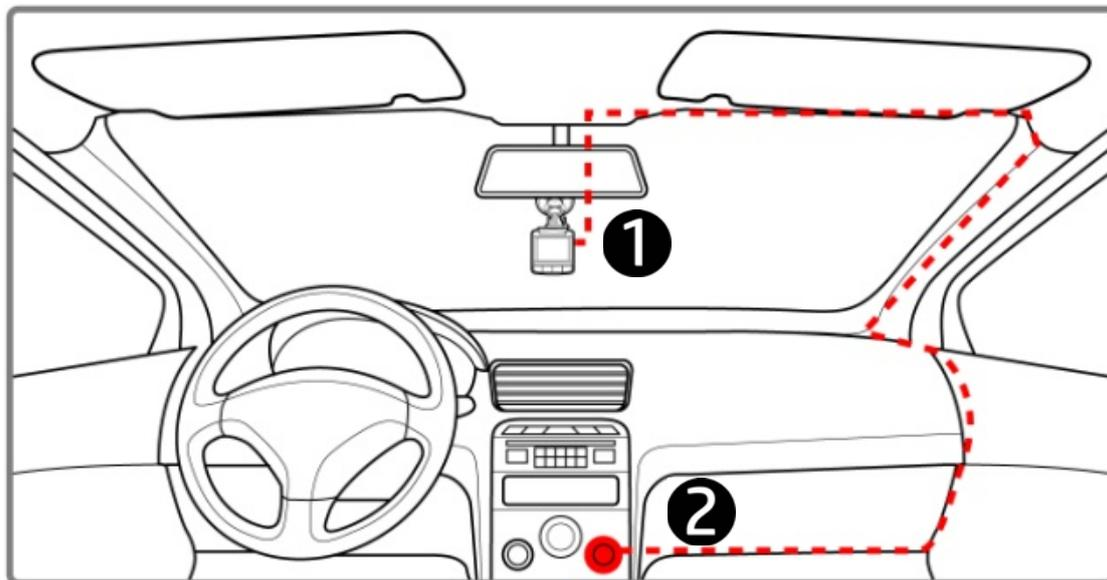
1. Branchez une extrémité de l'adaptateur de voiture sur la prise USB de l'appareil.
