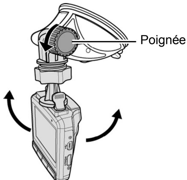
2. Desserrez le bouton pour faire pivoter l'appareil horizontalement jusqu'à 360°.
