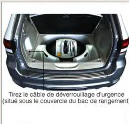
Tirez le câble de déverrouillage d'urgence (situé sous le couvercle du bac de rangement)
