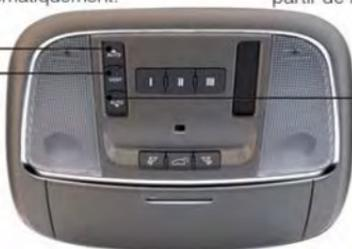
Les commutateurs du toit ouvrant à commande électrique se trouvent sur la console au pavillon.
