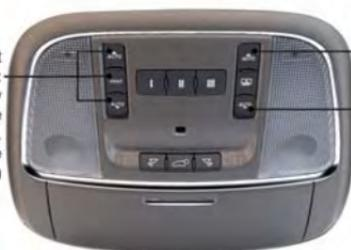
Fermeture rapide du pare-soleil à commande électrique : Appuyez sur le commutateur vers l'avant puis relâchez-le. Le toit se ferme automatiquement à partir de n'importe quelle position.
