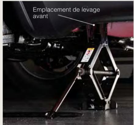
5. Pour un pneu arrière, placez le cric dans la fente du support d'arrimage arrière, juste devant le pneu arrière (comme il est indiqué par le pictogramme de point de levage triangulaire sur la moulure de seuil).
