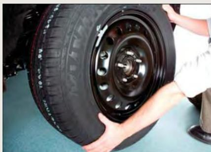
10. Finissez de serrer les écrous de roue. Appuyez sur la clé en la prenant par son extrémité pour augmenter la force de levier. Serrez les écrous de roue en étoile jusqu'à ce que chacun d'entre eux ait été serré deux fois. Le couple de serrage approprié des écrous de roue est de 150 N.m (110 lb-pi). Si vous n'êtes pas certain d'avoir bien serré les écrous, faites-les vérifier par un concessionnaire autorisé ou une station-service au moyen d'une clé dynamométrique.
