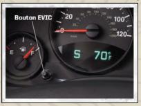
Appuyez sur le bouton du centre d'information électronique (EVIC), situé sous l'indicateur de vitesse, jusqu'à ce que les réglages personnalisés soient affichés au centre électronique d'information. Utilisez le bouton EVIC pour choisir une des options suivantes, puis appuyez dessus et maintenez-le pour choisir « ON » (en fonction) ou « OFF » (hors fonction).
