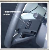
Les commandes de la chaîne audio à distance sont situées sur la surface arrière du volant.
