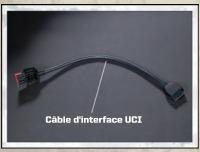
Un connecteur à 16 broches permet de raccorder un iPod<sup>MD</sup> au système audio de votre véhicule au moyen d'un câble d'interface fourni.
