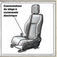
Le commutateur du siège à commande électrique est situé sur le côté extérieur du siège, près du plancher. Utilisez le levier pour obtenir la position voulue : monter, descendre, avancer, reculer ou basculer le siège.
