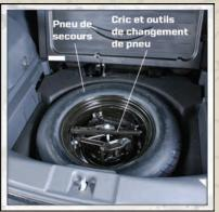
Le cric et le levier de manœuvre sont rangés sous le plancher de chargement du coffre.
