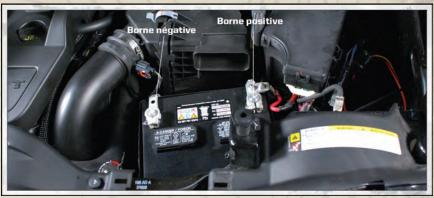
Branchez l'autre câble, d'abord à la borne négative de la batterie d'appoint, puis à la masse du moteur (-) du véhicule dont la batterie est déchargée. Assurez-vous de la qualité du contact électrique à la masse du moteur.
