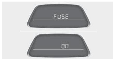
Ce voyant s'allume si l'interrupteur-fusibles dans la boîte à fusibles est désactivé.
