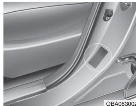
L'étiquette de certification du véhicule fixée au montant central du côté conducteur (ou passager avant) indique le numéro d'identification du véhicule (VIN).
