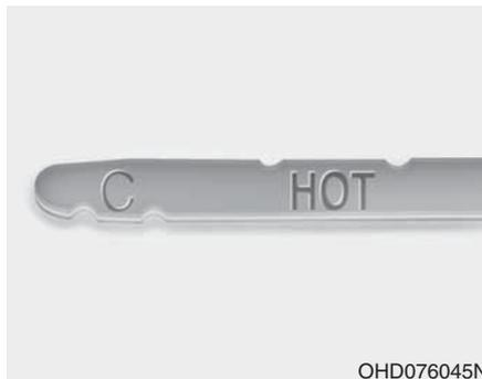
3. Contrôlez que le niveau de liquide est sur la plage "HOT" de la jauge de niveau. Si le niveau est plus bas, ajoutez le liquide spécifié par l'orifice de remplissage. Si le niveau est plus élevé, purgez le liquide par l'orifice de vidange.
