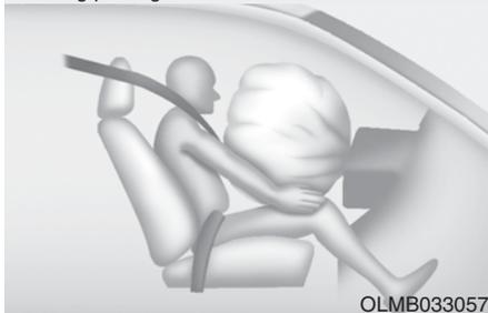
Une fois le gonflage terminé, l'airbag se met à se dégonfler immédiatement, ce qui assure la visibilité avant du conducteur et lui permet de braquer ou d'actionner d'autres commandes.
