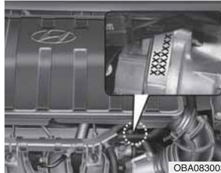
Le numéro de moteur est poinçonné sur le bloc moteur comme le montre le schéma.
