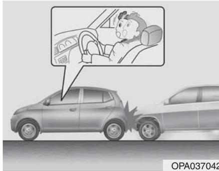
Les airbags frontaux ne sont pas conçus pour se déclencher lors de chocs par l'arrière car les occupants sont projetés vers l'arrière par la force du choc. Dans ce cas, les airbags déployés n'apporteraient aucune protection supplémentaire.
