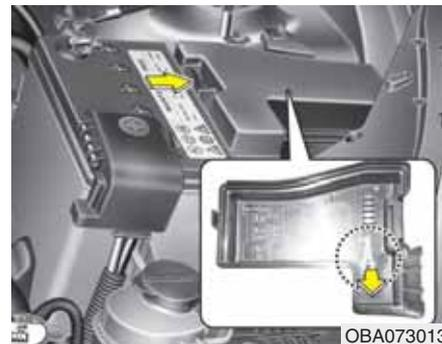
3. Retirez le fusible suspect. Faites usage de l'outil de dépose fourni dans le boîtier de fusibles du compartiment moteur.
