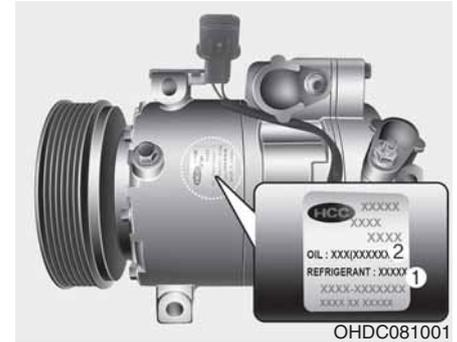
L'étiquette du compresseur vous renseigne sur le type de compresseur de votre véhicule en indiquant le modèle, le fournisseur, le numéro de pièce, le numéro de production, le fluide réfrigérant (1) et l'huile du réfrigérant (2).
