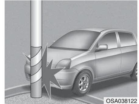
Les airbags ne se déploient pas en cas de collision du véhicule avec des objets tels que des poteaux électriques ou des arbres, où le point d'impact est concentré et l'énergie de collision est absorbée par la structure du véhicule.
