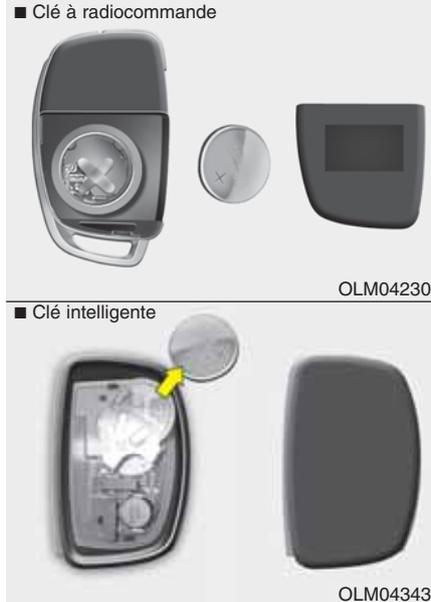
2. Remplacez par une nouvelle pile. Lorsque vous remplacez la pile, assurez-vous que le symbole positif "+" de la pile est tourné vers le haut, comme indiqué sur le schéma.
