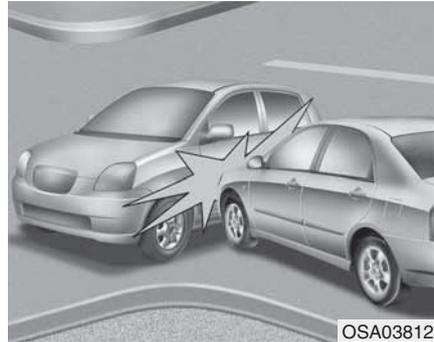
Lors de chocs latéraux, il est possible que les airbags frontaux ne se déclenchent pas car les occupants sont projetés dans la direction de la collision, et dans le cas de chocs latéraux, le déploiement des airbags frontaux n'apporterait aucune protection supplémentaire.
