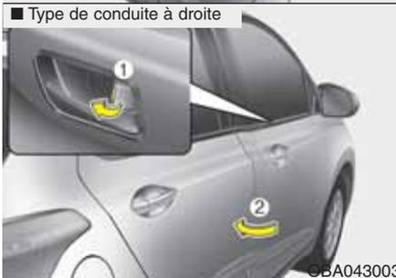
Pour verrouiller une porte sans la clé, placez le bouton de verrouillage des portes intérieur (1) en position "verrouillage" et fermez la porte (2). (Si non équipé du système de verrouillage centralisé des portes)
