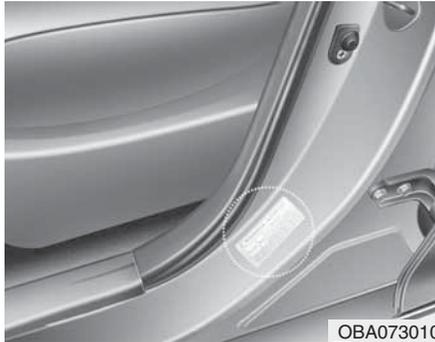
Les pneus fournis sur votre nouveau véhicule sont choisis pour offrir les meilleures performances pour une conduite normale. L'étiquette relative aux pneus située du côté conducteur (panneau extérieur du montant central) indique la pression des pneus recommandée pour votre véhicule.
