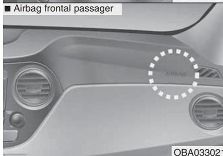
Le but du SRS est de fournir une protection supplémentaire au conducteur du véhicule et aux passagers avant à celle proposée par le système de ceinture de sécurité seul en cas de choc frontal violent.
