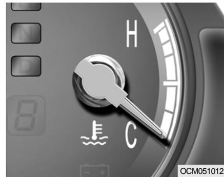
L'aiguille sur la jauge de température du liquide de refroidissement du moteur doit rester dans la gamme normale. Si elle se déplace à travers le cadran vers "H" (Chaud), arrêtez-vous dès que possible et coupez le moteur.
