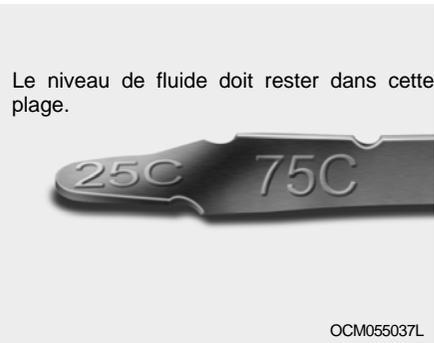
3. Assurez-vous que le niveau de liquide se situe dans la partie "75°C" sur la jauge de liquide. Si le niveau de liquide est plus bas, ajoutez le liquide spécifié dans l'orifice de remplissage. Si le niveau de liquide est plus haut, videz le liquide par l'orifice de vidange.
