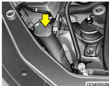
Le réservoir du lave-glace alimente en liquide le système du lave-glace. Utiliser un liquide de lave-glace de bonne qualité pour remplir le réservoir. Le niveau du liquide doit être vérifié plus fréquemment par mauvais temps ou chaque fois qu'il est utilisé plus souvent qu'à l'accoutumée. Le réservoir du lave-glace a une contenance de 4,6 litres.
