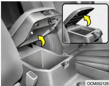
Le boîtier de la console centrale est utilisé pour stocker des cassettes ou des petits objets. Pour utiliser le boîtier de la console centrale, tirez le bouton et soulevez le couvercle pour l'ouvrir.
