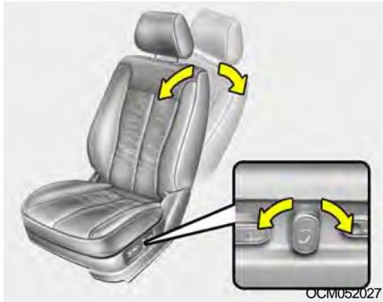
Tirez la partie supérieure du bouton de commande vers l'avant ou l'arrière pour incliner le dossier de siège à la position souhaitée. Relâchez le bouton de commande et le dossier de siège demeure dans cette position.
