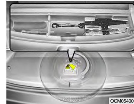
Un espace de rangement multi-usage est prévu sous le tapis du coffre. Avant de l'utiliser, retirez le tapis du coffre. Soulevez le couvercle du compartiment à l'aide de la poignée.
