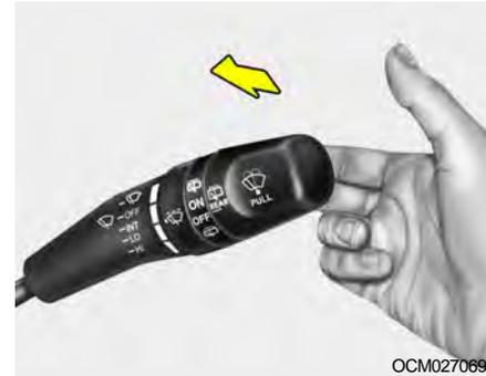
Pour utiliser le lave-glace, tirer le levier de commande des essuie-glaces vers le volant. Quand il est encienché, les balais passent automatiquement deux fois sur le pare-brise et ne s'arrêtent que lorsque le levier est relâché.
