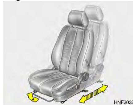
Pour coulisser le siège vers l'avant ou l'arrière, actionner le bouton de déverrouillage en le soulevant vers le haut. Le siège se débloque pour vous permettre de le déplacer d'avant en arrière dans la position désirée. Le réglage terminé, relâchez le bouton et poussez le siège vers l'avant ou l'arrière pour qu'il se bloque dans la position choisie et ne puisse plus bouger.
