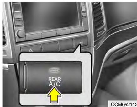
Vous pouvez sélectionner l'interrupteur ON/OFF (ACTIVATION/DESACTIVATION) de la climatisation arrière situé dans le siège avant. Lorsque vous l'actionnez, le témoin indicateur s'allume et la climatisation arrière se met à fonctionner.
