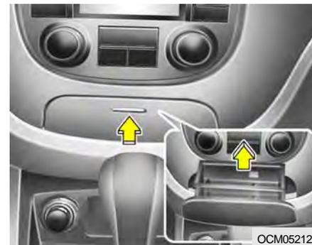
Le cendrier avant peut être ouvert en enfonçant et en relâchant le couvercle du cendrier. Pour retirer le cendrier pour le vider ou le nettoyer, levez le réceptacle métallique et sortez-le. L'éclaireur de cendrier ne s'allume que quand les feux externes sont allumés.
