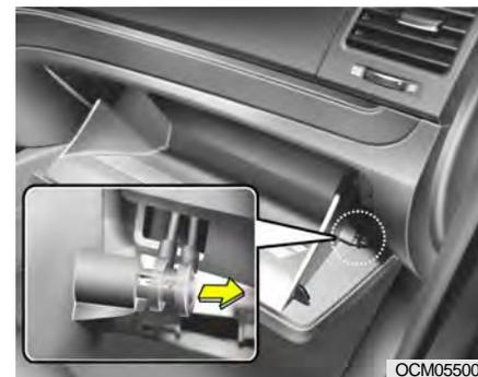
2. Sortez la sangle d'amortisseur du côté droit sur la boîte à gants par l'orifice.
