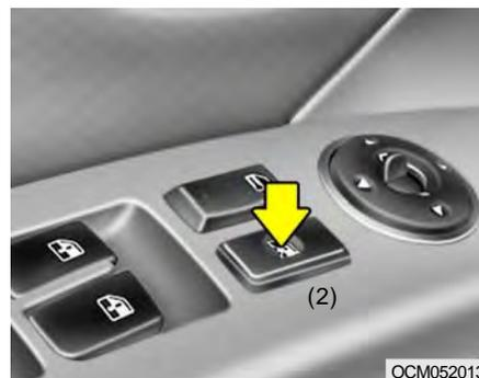
Afin d'empêcher l'activation des vitres par les passagers arrière, le commutateur de verrouillage des vitres (2) se trouve sur l'accoudoir côté conducteur. Pour désactiver les vitres électriques arrière, actionnez le commutateur de verrouillage des vitres. Pour revenir au fonctionnement normal, actionnez de nouveau le commutateur de verrouillage des vitres.
