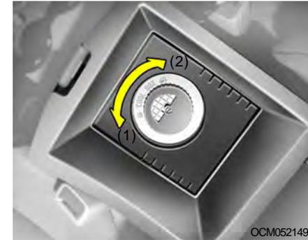
Vous pouvez maintenir des boissons au frais ou non à l'aide de la molette d'ouverture/de fermeture du diffuseur d'air situé dans le compartiment de la console centrale.
