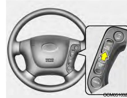
Le véhicule reprend automatiquement la vitesse définie avant l'annulation lorsque vous actionnez le commutateur de commande «RESUME (ACCEL)» (reprise) (au-dessus de 40 km/h).
