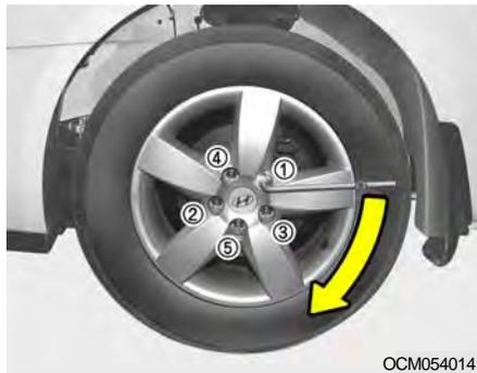
Placez alors la clé comme indiqué sur le dessin et serrez les boulons de la roue. Assurez-vous que la douille est bien enfoncée sur le boulon. Ne grimpez pas sur la clé et n'utilisez pas d'allonge pour serrer excessivement.
