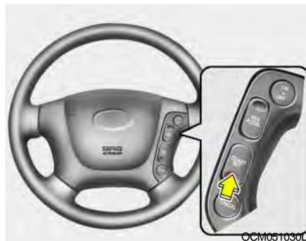
1. Actionnez le bouton de commande « SET (COAST) ». Le véhicule ralentit. Lorsque le commutateur de commande est actionné, la vitesse du véhicule diminue progressivement.
