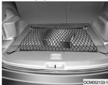
Certains objets peuvent être placés dans le filet dans le coffre à bagages. Utilisez le filet à bagages sur le plancher du coffre à bagages pour éviter que des objets ne glissent.
