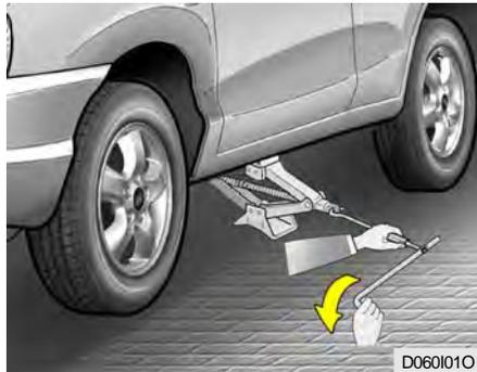
Abaissez le véhicule au sol en tournant la clé pour écrous de roue dans le sens inverse des aiguilles d'une montre.
