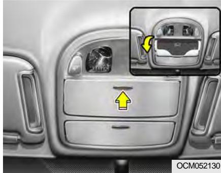
Le compartiment à lunettes est situé à l'avant de la console du plafond. Poussez sur l'extrémité du couvercle pour ouvrir ou fermer le compartiment à lunettes.
