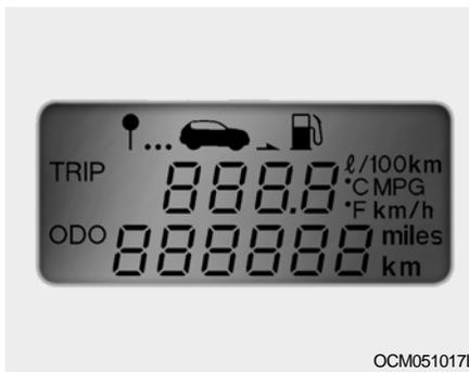
L'ordinateur de route est un dispositif d'information du conducteur commandé par micro-ordinateur qui, sur l'écran LCD, fournit à ce dernier des informations sur la conduite.
