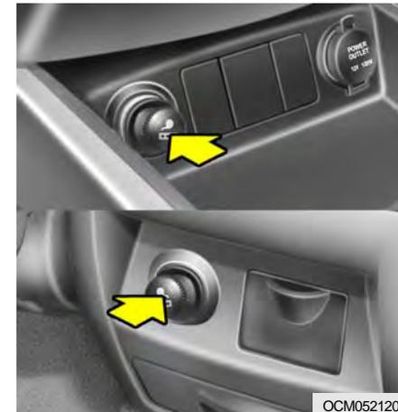
L'allume-cigare ne peut fonctionner que si la clé de contact est en position "ON" ou "ACC".
