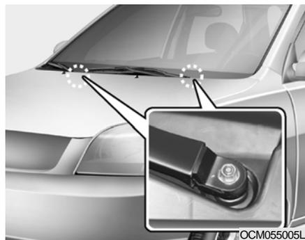
Les balais d'essuie-glace doivent être inspectés attentivement et nettoyés de temps en temps pour enlever les dépôts de poussière et autres. Pour nettoyer les balais et bras d'essuie-glace, utiliser une éponge ou un chiffon propre avec de l'eau et du savon ou un détergent doux. Si les balais continuent à tracer des stries ou à souiller le pare-brise, les remplacer par des balais d'origine Hyundai ou leur équivalent.
