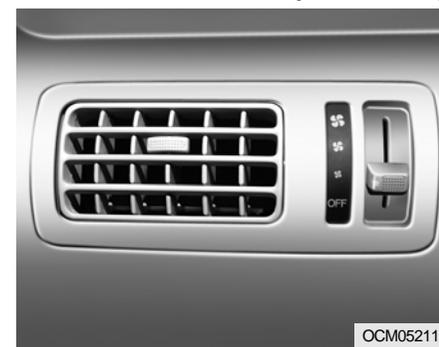
Les ventilateurs arrière sont situés dans la garniture intérieure. Pour changer le sens de circulation de l'air, déplacez le bouton au centre de l'ouverture d'un côté à l'autre. La vitesse du ventilateur de soufflerie peut être contrôlée en réglant le levier de commande à la position souhaitée.
