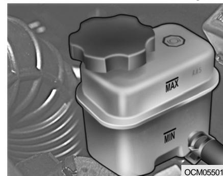
Il est normal que le niveau du liquide de frein baisse légèrement lorsque les plaquettes de frein s'usent.
