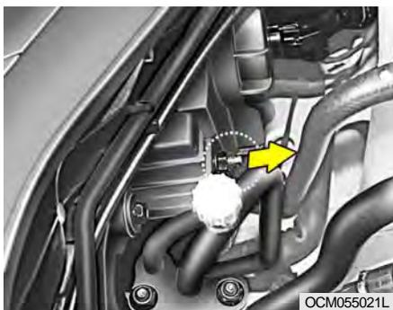
4. Retirez les boulons et écrou de fixation de l'ensemble de phare en utilisant une clé.
