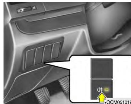
Afin d'activer les phares antibrouillards arrière, actionnez le commutateur. Ils s'allument lorsque l'interrupteur des projecteurs est en seconde position ou lorsque l'interrupteur du projecteur antibrouillard avant et la clé sont en position "ON".
