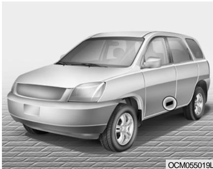
L'étiquette des pneus située sur le tableau du pilier central côté conducteur donne les pressions de gonflage des pneus recommandées pour votre véhicule.
