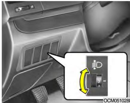
Pour régler le niveau du faisceau des phares selon le nombre de passagers et la charge, tourner l'interrupteur de réglage des phares.
