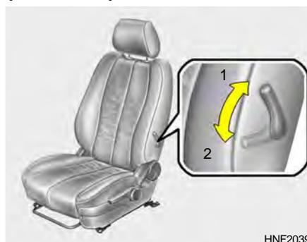
Pour régler le soutien lombaire, tournez la poignée sur le côté extérieur du siège. Pour augmenter le soutien lombaire, tirez le levier vers l'avant. Pour le diminuer, enfoncez le levier vers l'arrière.
