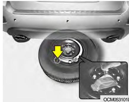
1. Posez la roue sur le sol avec la tubulure de valve en haut.
