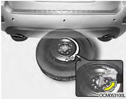
4. Sortez le pneu de secours et retirez l'arrêtoir du centre du pneu de secours.
