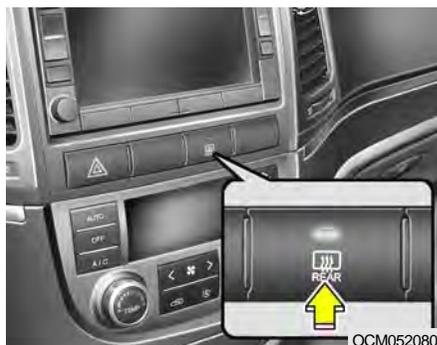
Le dégivrage de la vitre arrière est actionné en appuyant sur l'interrupteur. Pour arrêter la manoeuvre, réappuyer sur l'interrupteur. Le dégivrage de la vitre arrière s'arrête de lui-même après environ 20 minutes pour recommencer l'opération, appuyer de nouveau de l'interrupteur. Il fonctionne au moment où vous actionnez le dégivreur de pare-brise avant.
