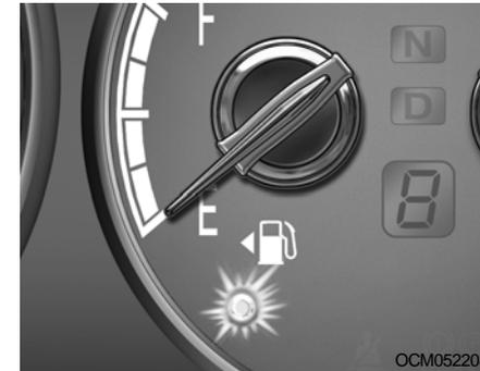
Ce témoin s'allume lorsque le réservoir à carburant est presque vide. Dès qu'il s'allume, vous devez ajouter de l'essence aussi rapidement que possible. Conduire lorsque le témoin est allumé ou lorsque l'aiguille de la jauge à carburant est sur le graduation "E" peut provoquer des ratés d'allumage et endommager le convertisseur catalytique équipant votre voiture.
