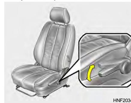
Pour lever ou abaisser le siège, levez ou abaissez le levier de commande à la hauteur souhaitée.
