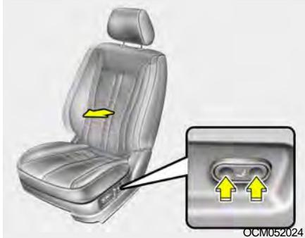
Pour régler le soutien lombaire, appuyez sur le commutateur de commande sur le côté extérieur du coussin de siège. Pour augmenter le soutien lombaire, appuyez sur la partie avant du commutateur. Pour le diminuer, appuyez sur la partie arrière du commutateur.
