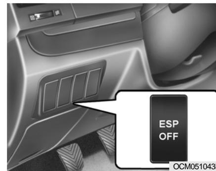
Le système de contrôle dynamique de stabilité (ESP) est conçu pour stabiliser le véhicule dans les virages. L'ESP vérifie où vous braquez et où se rend le véhicule.
