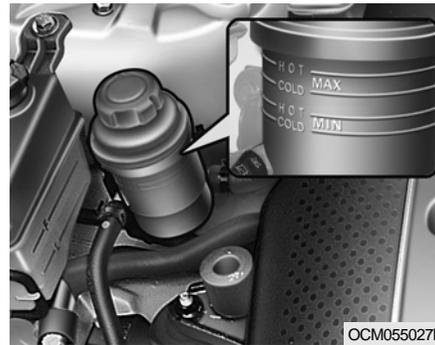
Le niveau du liquide de la servodirection devrait être vérifié quotidiennement. Cependant, assurez-vous au préalable que l'allumage est coupé (contact sur "OFF"), puis vérifiez si le niveau du liquide se situe entre les repères "MAX" et "MIN" sur le réservoir.
