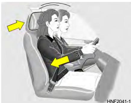
L'appuie-tête actif est conçu pour se déplacer vers l'avant et vers l'arrière lors d'un impact arrière. Cela évite que la tête du conducteur et du passager avant ne soit projetée vers l'arrière et empêche donc les blessures au cou.
