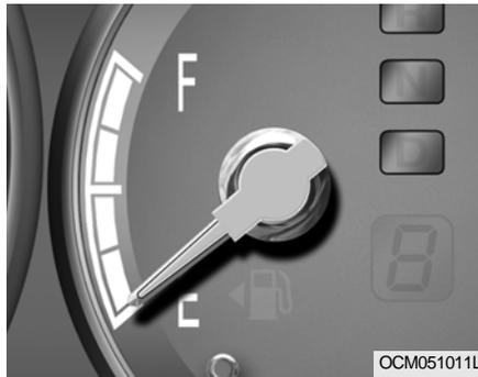
L'aiguille de la jauge à carburant indique le niveau de carburant dans le réservoir. La capacité du réservoir est mentionnée à la section 9.
