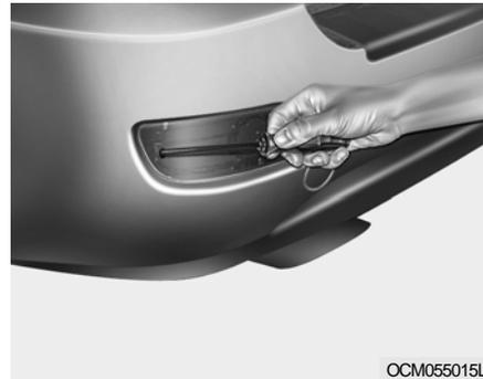
1. Déposez les vis de montage du couvercle du projecteur antibrouillard arrière à l'aide d'un tournevis Phillips.
