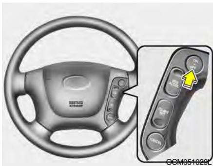
1. Actionnez le bouton ON/OFF du régulateur de vitesse constante. Le témoin indicateur "CRUISE" dans le combiné d'instruments s'allume. Cela active le système.
