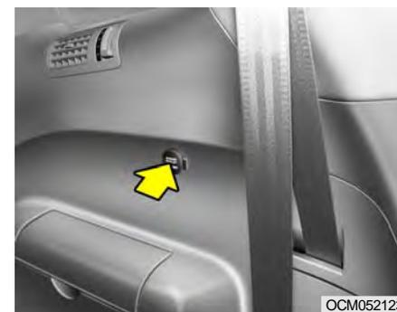
Elle délivre un courant électrique de 12V pour faire marcher l'équipement ou les accessoires électriques uniquement lorsque la clé se trouve dans la position "ON" ou "ACC".
