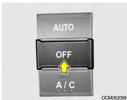
Appuyez sur le bouton "OFF" pour arrêter le système de chauffage et de refroidissement.
