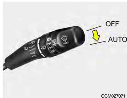
Si le commutateur de l'essuie-glace avant est placé en position "AUTO", le capteur de pluie situé sur l'extrémité supérieure du pare-brise capte la densité de pluie et commande l'intervalle correct entre les passages de l'essuie-glace.
