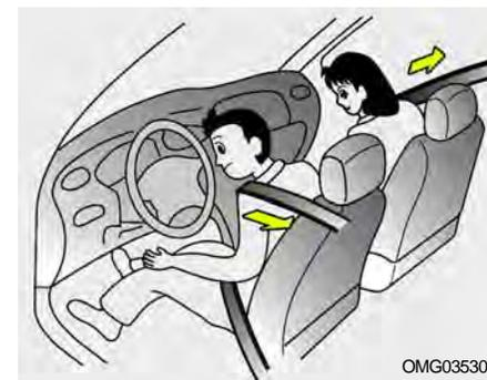
Lorsque le véhicule s'arrête brusquement ou si l'occupant essaie de se pencher vers l'avant trop rapidement, le rétracteur de ceinture de sécurité se verrouille en position. Toutefois, en cas de collisions frontales, le pré-tendeur est activé et tend la ceinture de sécurité contre le corps de l'occupant.
