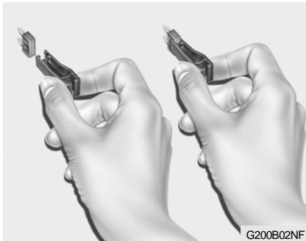
4. Remplacer le fusible fondu en introduisant à sa place un fusible en bon état. Le fusible doit s'adapter sans aucun jeu. Dans le cas contraire, faire réparer le porte-fusible par un distributeur Hyundai. Si vous n'avez pas de fusible de rechange sous la main, utilisez le fusible d'un accessoire dont vous pouvez vous passer momentanément, par exemple le
