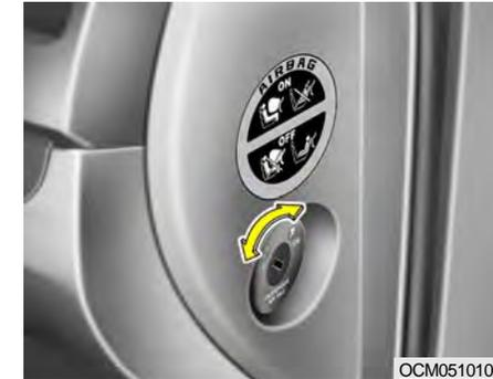
L'air bag avant du passager peut être désactivé grâce à l'interrupteur ON/OFF de l'air bag avant du passager si un système de retenue pour enfants est mis en place sur le siège du passager avant ou si le siège du passager avant n'est pas occupé par une personne.
