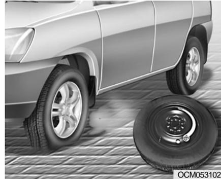
La procédure décrite dans les pages peut servir à remplacer une roue dont le pneu est crevé, mais aussi pour permuter les roues de temps à autre (afin que les pneus puissent s'user de manière uniforme). Avant de changer un pneu à plat, s'assurer que le sélecteur est sur "P" (boîte automatique) ou que le levier de vitesse est en marche arrière (boîte manuelle). Ensuite:
