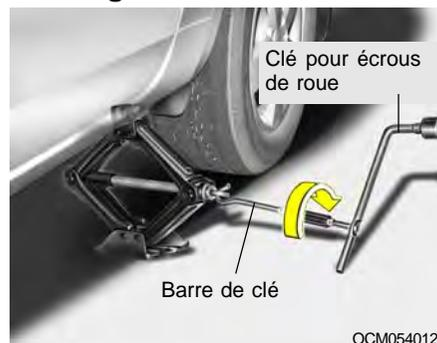
Après avoir inséré une barre de clé dans la clé pour écrous de roues, placez la barre de clé dans le cric comme indiqué dans le croquis. Pour lever le véhicule, tournez la manivelle dans le sens des aiguilles d'une montre.
