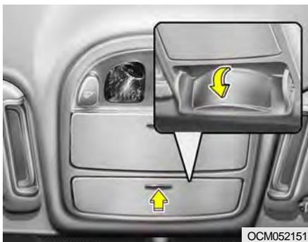
Le rétroviseur est pratique pour permettre au passager du siège avant de converser avec ceux qui occupent les sièges arrière sans avoir à tourner la tête ou le corps vers l'arrière. Pour utiliser le rétroviseur, poussez son cache et ouvrez-le. Réglez l'angle du rétroviseur à la position souhaitée. Fermez le cache après utilisation.
