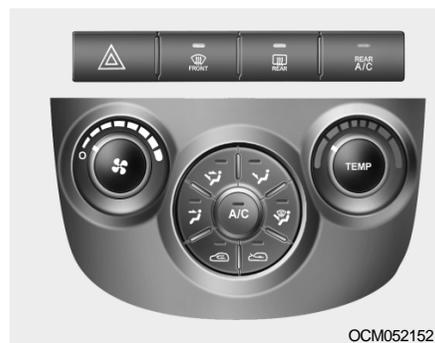
Pour chauffer normalement, placer la commande d'air d'admission sur la position "Air frais (
