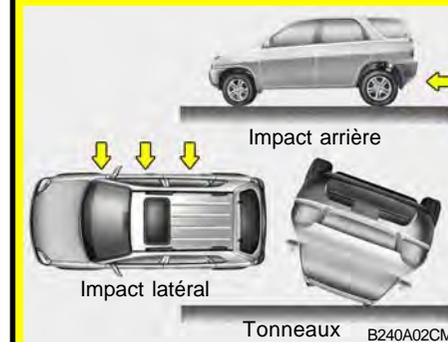
o Les airbags avant ne sont pas conçus pour se déployer en cas de collisions à impact latéral, à impact arrière ou en cas de tonneaux. De plus, les airbags ne se déploient pas en cas de collisions frontales en dessous de la vitesse du seuil de déploiement.
