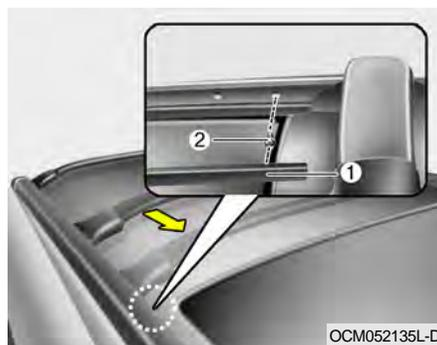
Vous pouvez positionner la barre transversale avant plus vers l'avant du véhicule pour transporter du matériel de ski ou d'autres affaires. Après avoir retiré la moulure du pare-chocs ① et le boulon de montage ②, déplacez la barre transversale vers l'avant du véhicule et fixez-la à l'aide d'un boulon introduit dans le trou correspondant. Réinstallez ensuite la moulure du pare-chocs.
