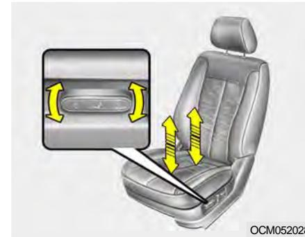
Pour lever ou baisser l'avant du coussin, déplacez l'avant de la commande vers le haut ou vers le bas. Pour en lever ou baisser l'arrière, déplacez l'arrière de la commande vers le haut ou vers le bas.
