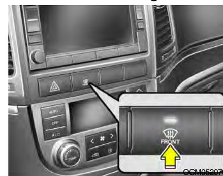
Lorsque le bouton "Defrost" ("Dégivrage") est actionné, le mode "☁" ("Frais") est sélectionné automatiquement et l'aération est effectuée par le gicleur du dégivreur de pare-brise, le gicleur du dégivreur latéral et l'aérateur latéral. Lorsque ce bouton est actionné, le climatiseur se met en marche si la température ambiante est inférieure à 3,5°C et s'éteint lorsque le mode "☁" est sélectionné.
