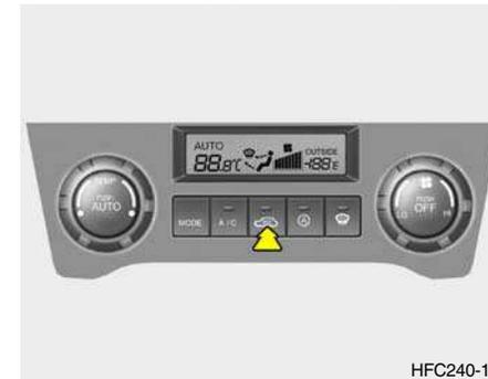
Ceci est utilisé pour sélectionner l'air extérieur frais ou l'air intérieur de recirculation et pour éviter que les gaz d'échappement ne pénètrent dans le véhicule.
