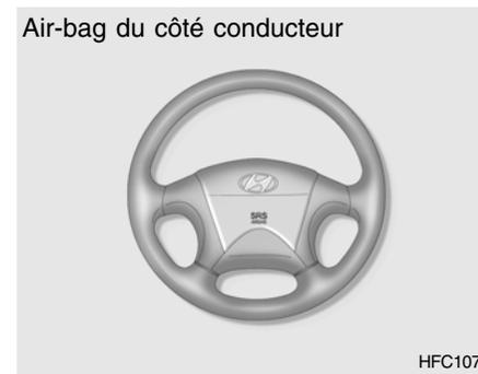
Votre Hyundai est équipée d'un système de retenue supplémentaire (SRS). Pour l'indiquer, le rembourrage du volant de direction et la planche de bord, côté du passager, portent l'inscription «SRS Air Bag».
