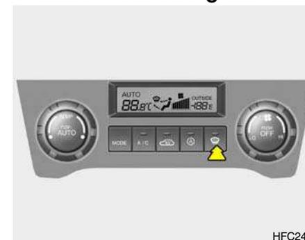
Lorsque le bouton "Defrost" ("Dégivrage") est actionné, le mode "Fresh" ("Frais") est sélectionné automatiquement et l'aération est effectuée par le gicleur du dégivreur de pare-brise, le gicleur du dégivreur latéral et l'aérateur latéral. Lorsque ce bouton est actionné, le climatiseur se met en marche si la température ambiante est supérieure à 3.5°C et s'éteint si la température ambiante est inférieure à 3.5°C.
