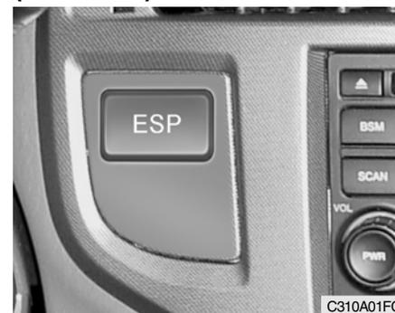
Le système de contrôle dynamique de stabilité (ESP) est conçu pour stabiliser le véhicule dans les virages.
