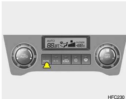
Cette commande est utilisée pour diriger le flux de l'air. L'air peut être dirigé vers le sol, les sorties d'air du tableau de bord ou le pare-brise. Quatre symboles sont utilisés pour représenter les positions niveau visage, deux niveaux, sol et sol-dégel.
