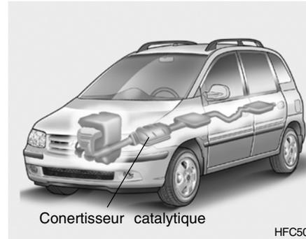
Le convertisseur catalytique fait partie du système de contrôle des gaz d'échappement. Son but est d'éliminer certaines substances des gaz d'échappement. Il a l'apparence d'un silencieux et se trouve sous la voiture. Il est intégré au système d'échappement.
