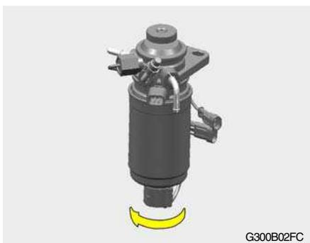
1. Desserrez le bouchon de vidange en bas du filtre à carburant.
