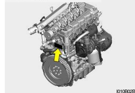
Le numéro du moteur est estampé sur le bloc moteur, à l'endroit indiqué dans l'illustration.
