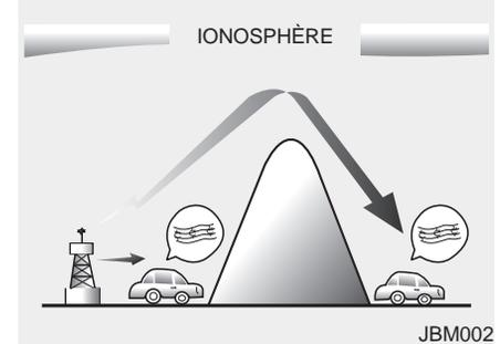
Les signaux de diffusion AM (MW, LW) offrent une zone de réception plus étendue que les signaux de diffusion FM. En effet, les ondes radio AM (MW, LW) sont émises à des fréquences basses. Ces ondes radio basse fréquence peuvent épouser la courbure de la terre au lieu de se propager en ligne droite dans l'atmosphère. De plus, elles contournent les obstacles offrant ainsi une meilleure couverture des signaux.
