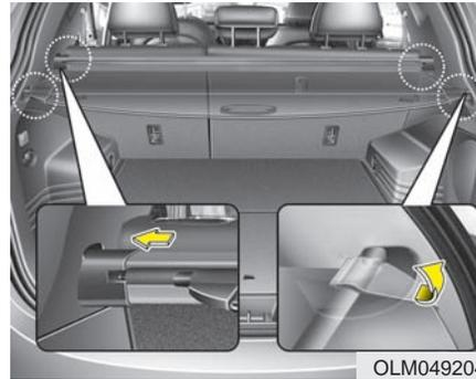
Pour utiliser le cache bagage du coffre, tirez la poignée vers l'arrière et insérez les bords dans les fentes.
