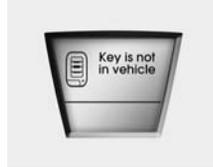
Si la clé intelligente ne se trouve pas dans le véhicule et si une porte est ouverte ou fermée alors que le bouton
