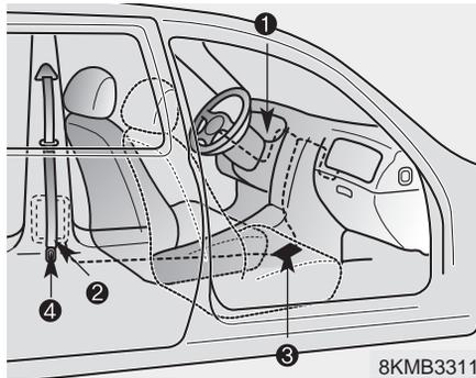
Le système de ceinture de sécurité à prétension est constitué principalement des composants suivants.
