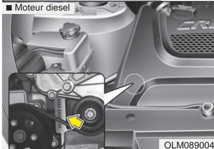
Le numéro de moteur est poinçonné sur le bloc moteur comme le montre le schéma.
