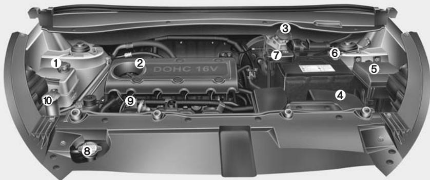
1. Réservoir du liquide de refroidissement
