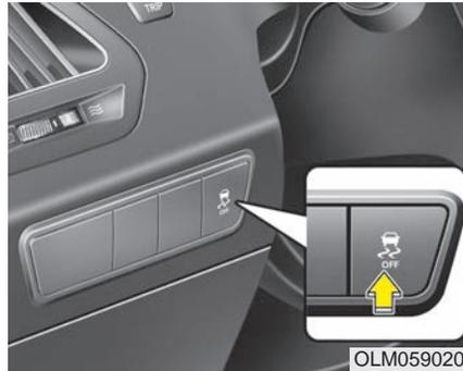
**Système ESP (Electronic Stability Program : dispositif électronique de stabilité programmé)
