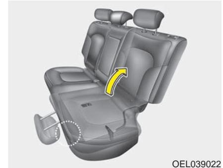
5. Pour utiliser le siège arrière, levez le dossier et tirez-le vers l'arrière. Tirez fermement le dossier vers l'arrière jusqu'à ce qu'il s'enclenche. Assurez-vous que le dossier est verrouillé en place.
