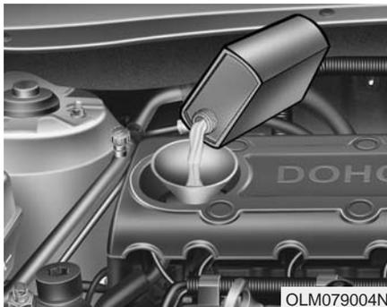
Si le niveau est proche ou sur le L, ajouter de l'huile pour rapprocher le niveau du F. **Ne pas verser trop d'huile.**
