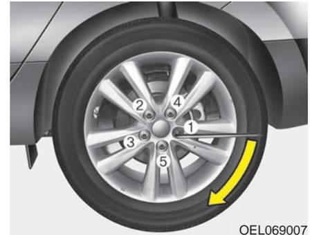
Puis positionnez la clé comme l'indique le schéma et serrez les écrous de roue. Assurez-vous que la douille repose complètement sur l'écrou. Ne vous tenez pas debout sur la clé à pipe ou n'utilisez pas de raccord sur la clé à pipe.
