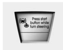
Si le volant ne se débloque pas comme prévu lorsque le bouton DEMARRAGE/ARRET DU MOTEUR est
