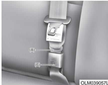
2. Pour rétracter la ceinture de sécurité arrière centrale, insérez la boucle dans l'orifice de libération en tissu (C). Tirez sur le tissu de la ceinture de sécurité vers le haut (A) et laissez la ceinture se rétracter automatiquement.
