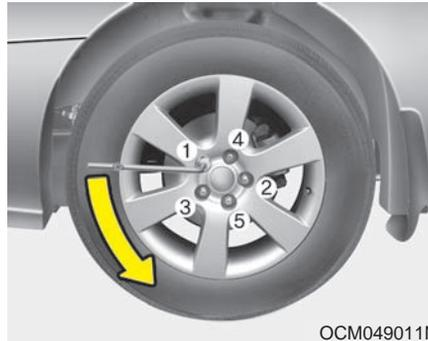
6. Desserrez d'un tour les écrous de roue dans le sens contraire des aiguilles d'une montre, mais n'en enlevez aucun avant que la roue n'ait été soulevée du sol.
