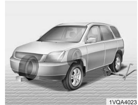
4. Sortez la clé d'écrous de roues, le cric, la poignée du cric, et la roue de secours du véhicule.
