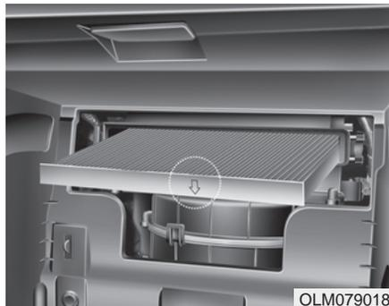
4. Remplacez le filtre à air de la climatisation.
