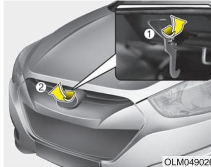
2. Allez à l'avant du véhicule, soulevez légèrement le capot, tirez légèrement le loquet de sécurité (1) situé au centre du capot, puis soulevez le capot (2).
