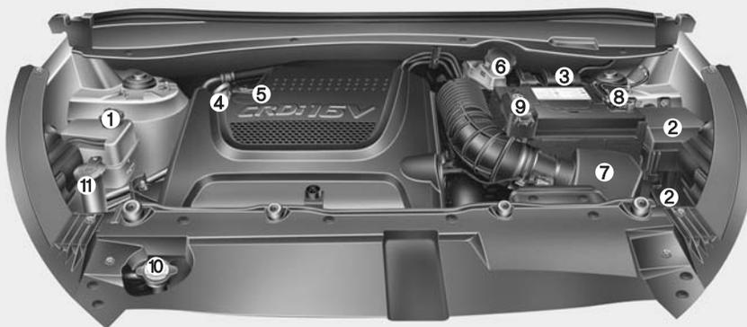
1. Réservoir du liquide de refroidissement
