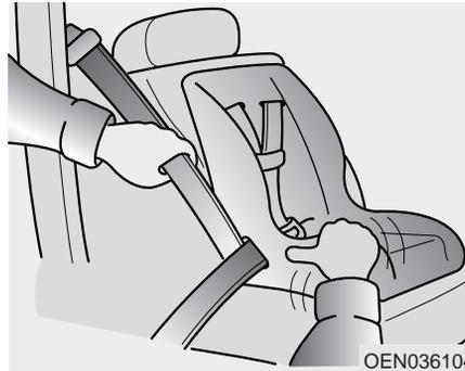
3. Bouclez la ceinture de sécurité et laissez la ceinture se mettre en place et réduire le jeu. Une fois le système de retenue pour enfant installé, essayez de le remuer dans tous les sens afin de vous assurer que le système de retenue est correctement fixé.
