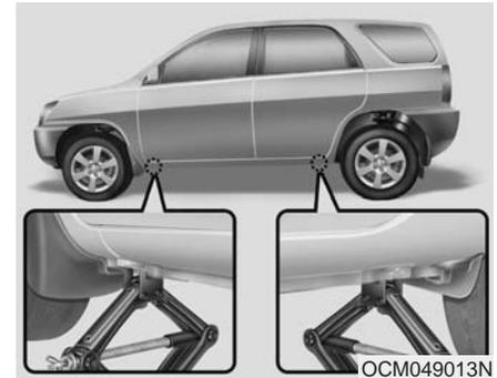
7. Placez le cric à la position avant ou arrière la plus proche de la roue que vous changez. Placez le cric aux endroits indiqués sous le châssis. Les positions du cric sont constituées de plaques soudées au châssis avec deux pattes et un repère saillant qui doit correspondre au cric.
