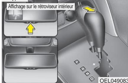
La caméra de recul est activée lorsque le feu de recul s'allume, le contact mis et que le levier de vitesses est en position R.
