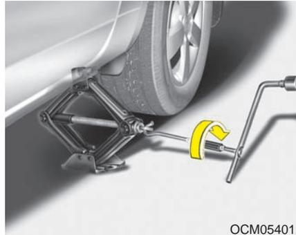
8. Engagez la poignée du cric dans le cric et faites la tourner dans le sens horaire en soulevant le véhicule juste assez pour que la roue quitte le sol. Cette hauteur est d'environ 30 mm (1,2 pouces). Avant de retirer les écrous de roue, assurez-vous que le véhicule est stable et qu'il n'existe aucun risque de mouvement ou de glissement.
