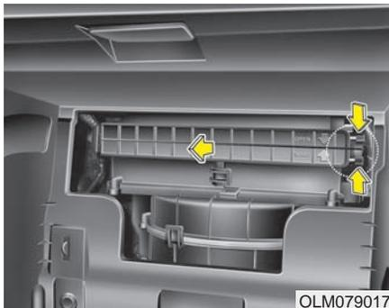
3. Retirez le boîtier du filtre à air du climatiseur tout en appuyant sur le verrou à droite du capot.
