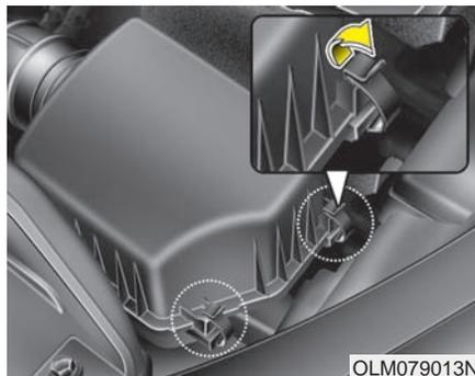
1. Desserrez les fixations du couvercle du filtre à air, puis ouvrez le couvercle.
