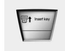
Si vous appuyez sur le bouton DEMARRAGE/ARRET DU MOTEUR alors que le témoin « Key is not detected » (Clé non détectée) s'allume sur l'écran LCD, le témoin « Insert key » (Insérer la clé) s'allume pendant environ 10 secondes. De plus, le témoin d'anti démarrage et le témoin du support de la clé clignotent pendant environ 10 secondes.
