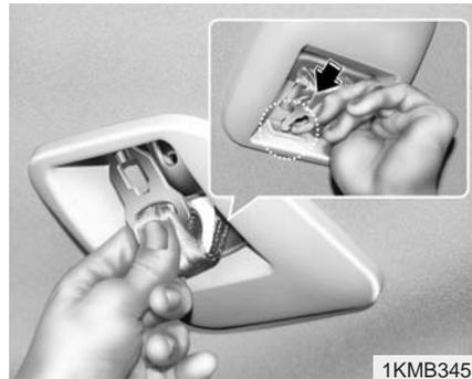
3. Insérez la plaque métallique (A) dans la fente du compartiment à ceinture.
