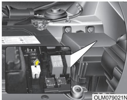
3. Retirez le fusible suspecté. Utilisez l'outil d'extraction placé dans le boîtier de fusibles du compartiment moteur.
