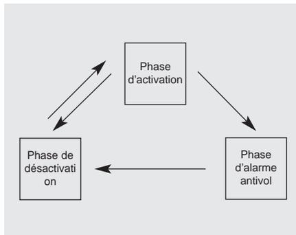
Ce système est conçu pour protéger la voiture contre toute intrusion. et se décompose en trois temps : la phase d'activation, la phase d'alarme antivol et la phase de désactivation. Une fois déclenché, le système émet une alarme sonore et les feux de détresse se mettent à clignoter.
