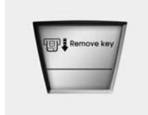
Lorsque vous arrêtez le moteur alors que la clé intelligente se trouve dans son support, le témoin s'allume sur l'écran LCD pendant environ 10 secondes. De plus, le témoin du support de clé intelligente clignote pendant environ 10 secondes. Pour retirer la clé intelligente, appuyez une fois sur la clé intelligente et retirez-la de son support.
