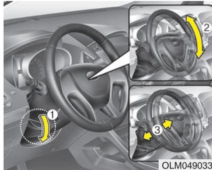
Pour modifier l'inclinaison du volant, abaissez le levier de déblocage (1), réglez le volant à la profondeur (2) et à la hauteur (3, le cas échéant) souhaités, puis relevez le levier de déblocage pour verrouiller le volant. Assurez-vous d'avoir réglé le volant à la position souhaitée avant de commencer à conduire.
