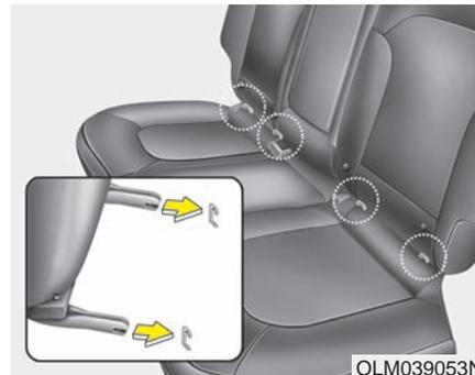
Les deux sièges latéraux arrière sont équipés d'une paire d'ancrages ISOFIX ainsi que d'un ancrage à sangle supérieur correspondant, à l'arrière du dossier. Les ancrages ISOFIX sont situés entre le coussin et le dossier du siège et portent le logo ISOFIX.
