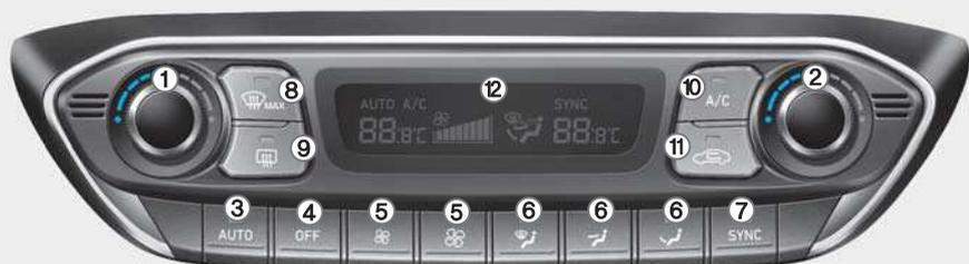
1. Molette de réglage de la température côté conducteur
