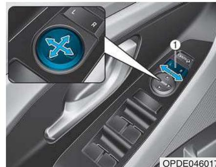
1. Appuyez sur le bouton L (côté gauche) ou R (côté droit) (1) pour sélectionner le rétroviseur extérieur à régler.
