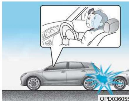
Les airbags frontaux ne sont pas conçus pour se déployer dans les collisions par l'arrière. En effet, ce type d'impact projette les occupants vers l'arrière et les airbags n'apporteraient aucune protection supplémentaire.
