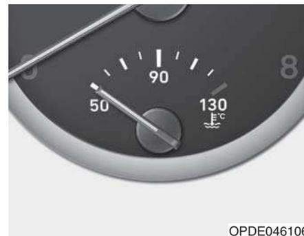
Cette jauge indique la température du liquide de refroidissement moteur lorsque le contact est en position ON.
