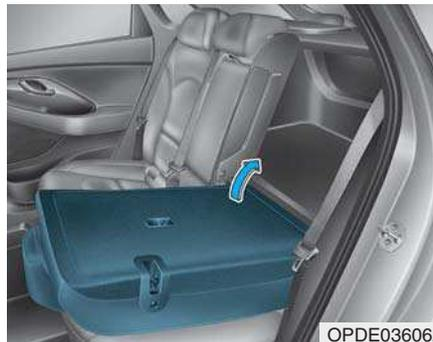
5. Pour utiliser le siège arrière, levez et tirez le dossier du siège vers l'arrière.
