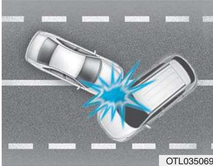
Lors d'une collision angulaire, la force de l'impact peut projeter les occupants dans une direction dans laquelle les airbags ne présenteraient aucun avantage, et les capteurs peuvent donc ne pas les déployer.
