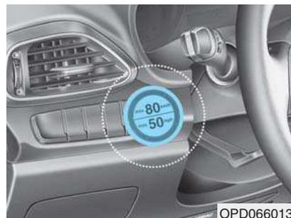
Enlevez l'étiquette de limitation de vitesse (0) de la bouteille de produit d'étanchéité (1) et placez-la à un endroit très visible du véhicule (tel que le volant) afin que le conducteur se souvienne de ne pas conduire trop vite.
