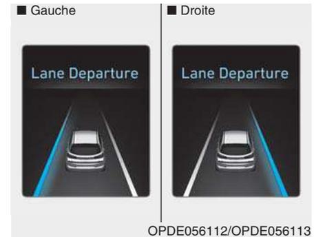
Un avertissement visuel s'affiche sur l'écran LCD du combiné. La ligne de voie gauche ou droite clignote sur l'écran LCD du combiné, selon la direction dans laquelle le véhicule se déporte.
