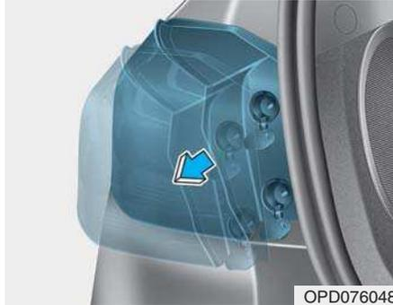
5. Retirez le bloc optique arrière de la carrosserie du véhicule.
