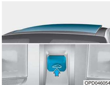
Si vous poussez le levier de commande du toit ouvrant vers le haut, le pare-soleil coulisse pour s'ouvrir, puis le toit s'incline.
