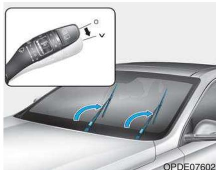
Pour remplacer un balai d'essuie-glace, suivez la procédure décrite pour lever un bras d'essuie-glace.
