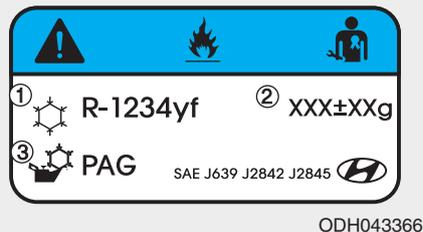
L'étiquette du fluide réfrigérant de climatisation de votre véhicule peut différer de celle présentée dans l'illustration.
