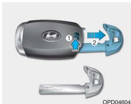
Déplacez le levier de déverrouillage dans le sens de la flèche (1) et sortez la clé mécanique (2). Insérez la clé mécanique dans la serrure de la porte.
