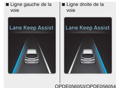
Si toutes les conditions d'activation du système LKAS ne sont pas réunies, le système LDWS s'active et alerte le conducteur uniquement lorsqu'il franchit une ligne.
