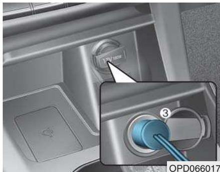
7. Branchez le cordon d'alimentation du compresseur (3) à la prise électrique du véhicule.
