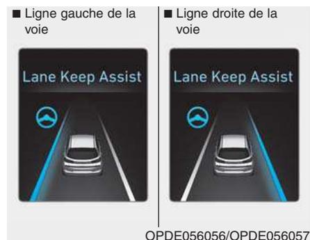
Un avertissement visuel s'affiche sur l'écran LCD du combiné. La ligne de voie gauche ou droite clignote sur l'écran LCD du combiné, selon la direction dans laquelle le véhicule se déporte.
