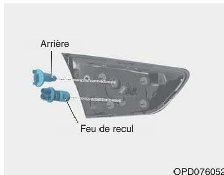
4. Retirez la douille du bloc en la tournant dans le sens antihoraire jusqu'à ce que ses pattes soient alignées avec les encoches du bloc.
