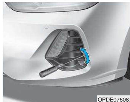
Vous pouvez régler l'orientation des feux antibrouillard avant de la même façon que les phares. L'état des feux antibrouillard avant et de la batterie doit être normal. Pour orienter les feux antibrouillard avant vers le haut ou le bas, tournez le tournevis horaire ou antihoraire.
