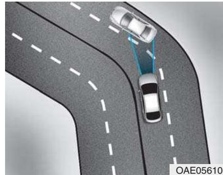
La vitesse de votre véhicule peut être réduite en présence d'un véhicule sur la voie adjacente.
