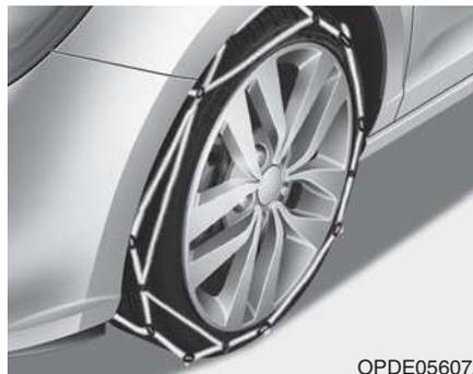
Étant donné que flancs des pneus radiaux sont plus fins que ceux des autres types de pneus, l'installation de certains types de chaînes peut les endommager.
