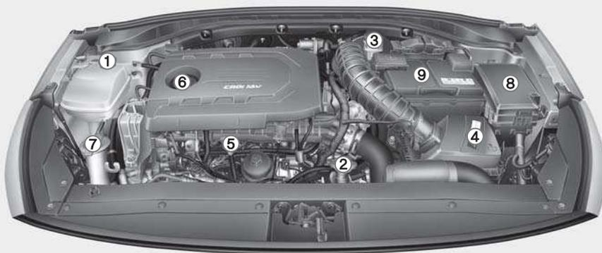
1. Réservoir de liquide de refroidissement moteur
