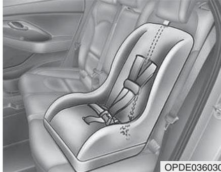
1. Faites passer la sangle supérieure du dispositif par-dessus le dossier. Placez la sangle supérieure conformément aux instructions du fabricant du dispositif.
