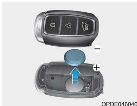
Si la clé intelligente ne fonctionne pas correctement, essayez de remplacer la pile.
