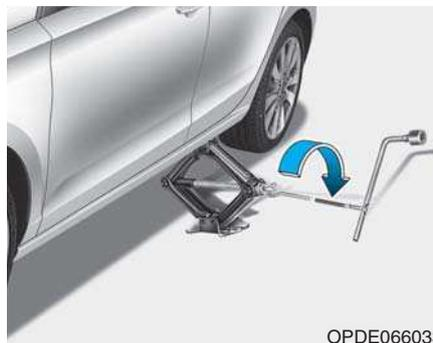
8. Introduisez la manivelle dans le cric et tournez-la dans le sens horaire jusqu'à ce que la roue ne touche plus le sol. Vérifiez que le véhicule est stable sur le cric.
