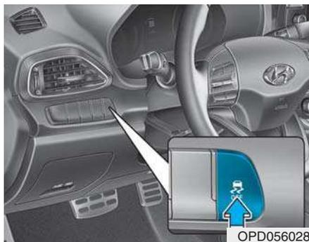
Le système de contrôle électronique de stabilité (ESC) assure la stabilité de votre véhicule dans les virages. L'ESC vérifie l'angle de braquage et la trajectoire du véhicule.
