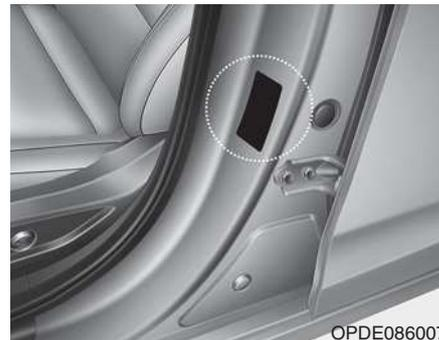
L'étiquette d'homologation du véhicule est apposée sur le pilier central latéral côté conducteur (ou côté passager avant). Elle indique par ailleurs le numéro VIN du véhicule.
