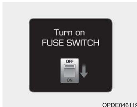
Ce message d'avertissement s'affiche si le commutateur de fusibles situé sur le boîtier de fusibles, sous le volant, est en position OFF.
