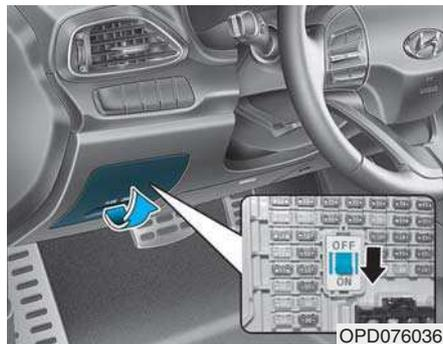
Placez toujours l'interrupteur à fusibles en position ON.
