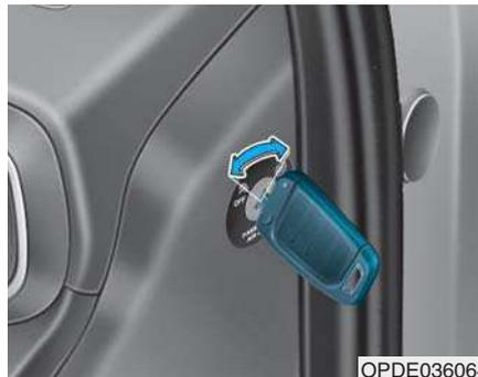
Interrupteur ON/OFF de l'airbag passager avant (le cas échéant)
