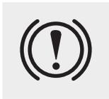
Pour vérifier le témoin du frein de stationnement, mettez le contact en position ON (sans démarrer le moteur).
