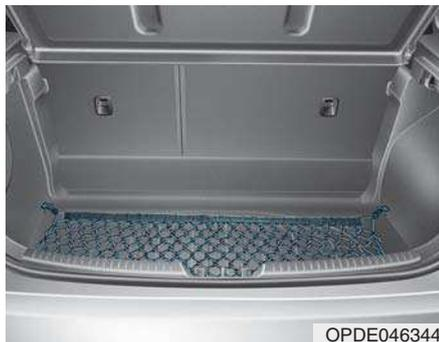
Pour éviter que les objets dans le hayon ne se déplacent, vous pouvez utiliser les 4 attaches situées dans le hayon afin d'installer le filet à bagages.
