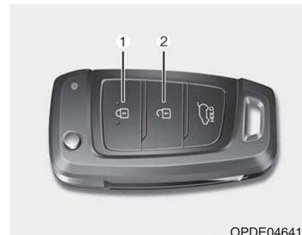
Pour verrouiller les portes, appuyez sur le bouton de verrouillage des portes (1) de l'émetteur.
