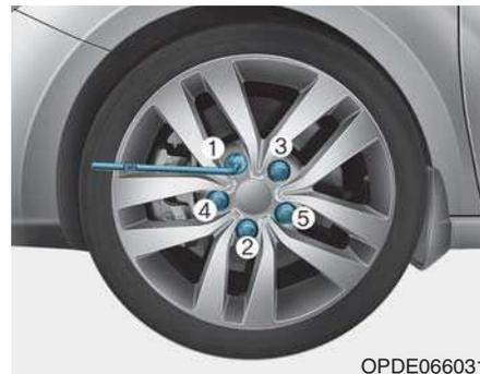
6. Desserrez les écrous de roue d'un tour dans le sens antihoraire en suivant l'ordre indiqué ci-dessus, mais ne les retirez pas tant que le pneu n'est pas surélevé.
