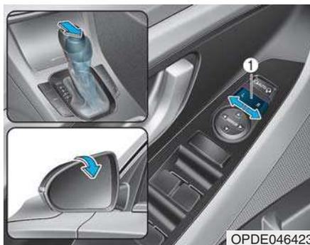
Lorsque vous placez le levier de vitesses en position R (Marche arrière), les rétroviseurs extérieurs sont orientés vers le bas pour faciliter la manœuvre.
