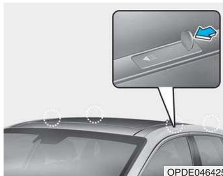
Pour monter ou déposer la barre de toit, vous pouvez utiliser le support de fixation et le couvercle du toit.
