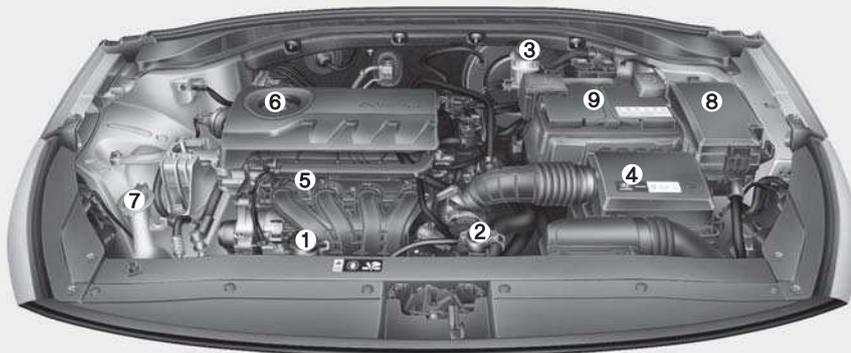
1. Réservoir de liquide de refroidissement moteur
