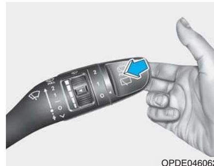
En position O, tirez doucement le levier vers vous pour pulvériser du liquide lave-glace et activer les essuie-glaces sur 1 à 3 cycles. La pulvérisation de liquide et le balayage sont maintenus jusqu'à ce que vous relâchiez le levier.
