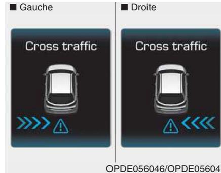
Si le véhicule détecté par les capteurs s'approche de vous, l'alarme retentit, le témoin du rétroviseur extérieur clignote et un message s'affiche sur l'écran LCD.
