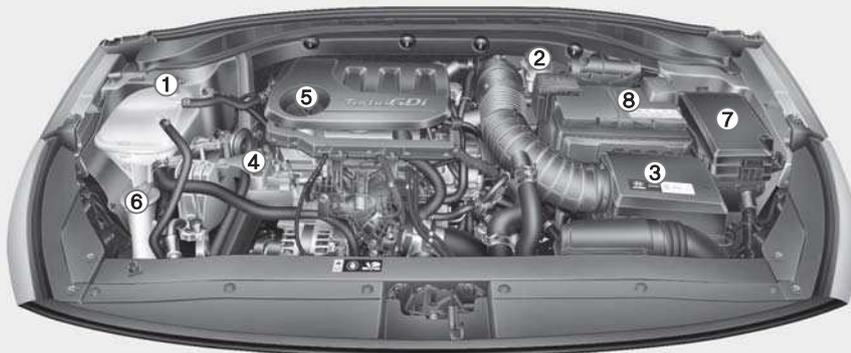
1. Réservoir de liquide de refroidissement moteur/
