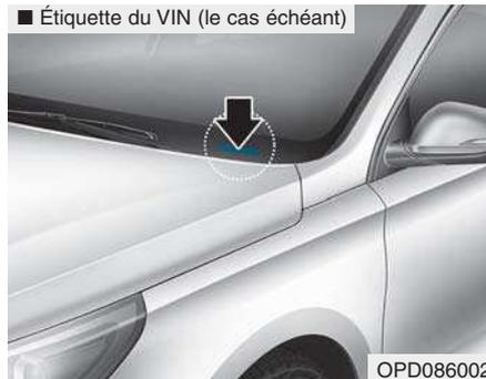
Le VIN apparaît également sur une plaque fixée sur la partie supérieure du tableau de bord. Ce numéro est parfaitement lisible depuis l'extérieur, à travers le pare-brise.
