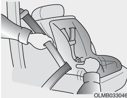
Pour retirer le dispositif de retenue enfant, appuyez sur le bouton de déverrouillage de la ceinture, puis tirez sur la ceinture trois points pour la dégager du dispositif et laissez-la se rétracter entièrement.
