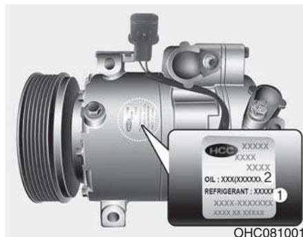
Une étiquette indique le type du compresseur de votre véhicule, notamment le modèle, la référence fournisseur, le numéro de production, le réfrigérant (1) et l'huile réfrigérante (2).
