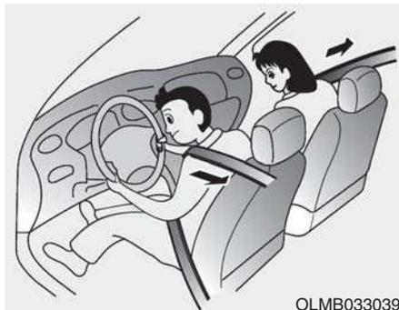
Votre véhicule est équipé de ceintures de sécurité à prétension (prétensionneur de rétracteur) au niveau du siège conducteur, du siège passager avant et des sièges arrière (sur véhicule équipé). Le prétensionneur permet de s'assurer que la ceinture de sécurité plaque l'occupant contre son dossier lors de certaines collisions frontales ou latérales. Ces ceintures peuvent s'activer en même temps que les airbags lors d'un accident si la collision frontale ou latérale est très violente.
