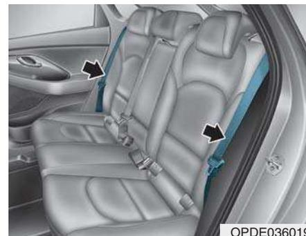
3. Placez la ceinture de sécurité sur le côté extérieur du siège avant de replier le dossier pour éviter qu'elle gêne la manœuvre.
