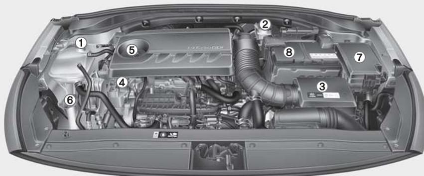
1. Réservoir de liquide de refroidissement moteur/Bouchon du réservoir de liquide de refroidissement moteur
