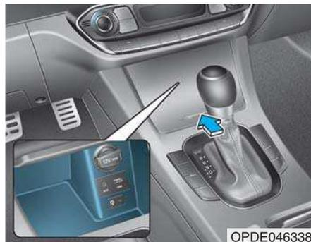
Pour ouvrir lentement le cache, poussez la baguette vers l'avant. Pour le fermer, poussez sur la baguette et relâchez-la. Le cache se referme lentement.
