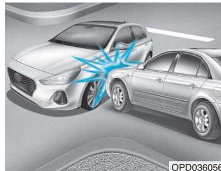
Les airbags frontaux peuvent ne pas se déployer lors d'impacts latéraux, car les occupants étant projetés dans la direction de la collision, ils n'apporteraient aucune protection supplémentaire.
