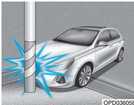
Les airbags peuvent ne pas se déployer en cas de collision avec des objets tels que des poteaux ou des arbres, lorsque le point d'impact est réduit et que l'énergie du choc est absorbée par la structure du véhicule.
