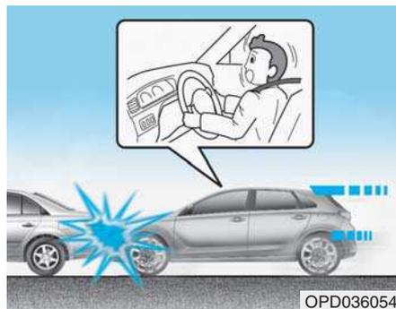
Lors de certaines collisions à vitesse réduite, les airbags peuvent ne pas se déployer. Les airbags sont conçus pour ne pas se déployer dans ce genre de collisions, car ils n'apporteraient pas de sécurité supplémentaire par rapport à celle offerte par les ceintures de sécurité.
