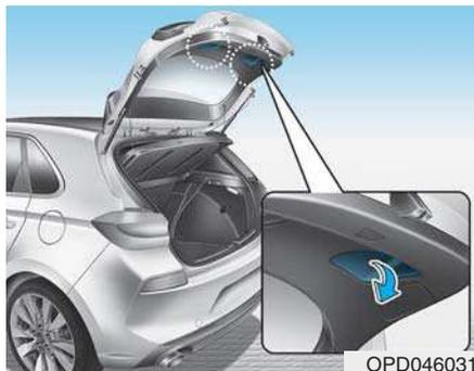
Abaissez le hayon et appuyez jusqu'au verrouillage. Pour vous assurer que le hayon est correctement fermé, essayez toujours de le relever.
