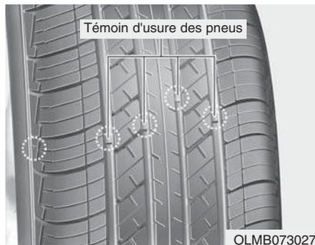
Si l'usure des pneus est régulière, vous pouvez apercevoir un témoin d'usure qui se présente sous la forme d'une barre sur la bande de roulement. Ce témoin indique qu'il reste moins de 1,6 mm de bande de roulement et que le pneu doit être remplacé.
