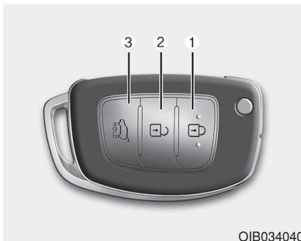
Pour verrouiller les portes, appuyer sur le bouton de Verrouillage de la Porte (1) sur la clé télécommandée.
