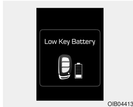
Ce message d'avertissement s'affiche si la batterie smartkey est déchargée, lorsque le bouton de Démarrage/Arrêt du Moteur passe en position OFF.
