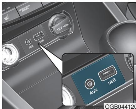
Vous pouvez utiliser un port AUX pour connecter des appareils audio et un port USB pour brancher un port USB et aussi un port iPod®.
