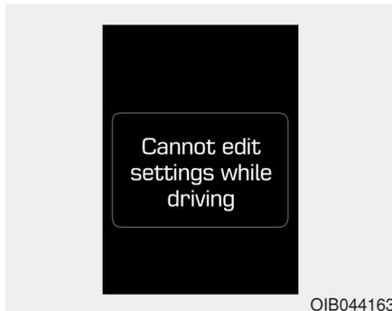
Ce message d'alerte s'allume lorsque vous essayez de sélectionner un autre Paramètres Utilisateur en conduisant.
