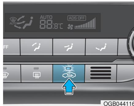
Ce bouton est utilisée pour sélectionner la position air extérieur (frais) ou air recyclé.
