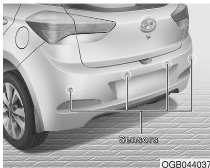
Le Système d'aide au Stationnement Arrière émet un signal sonore lorsqu'il détecte un obstacle situé à moins de 120 cm à l'arrière du véhicule. Ce système est un système supplémentaire qui détecte uniquement des objets dans la zone de détection et à proximité des capteurs, il ne peut pas détecter d'objets dans les zones où les capteurs ne sont pas installés.
