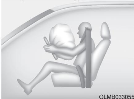
Au cours du déploiement, les coutures moulées sur les enveloppes du coussin lâchent sous la pression de déploiement des airbags. Ensuite, l'ouverture des enveloppes permet aux airbags de se gonfler totalement. Un airbag totalement gonflé associé à une ceinture de sécurité correctement attachée ralentit le mouvement vers l'avant du conducteur ou du passager frontal et réduit le risque de blessure à la tête et au thorax.
