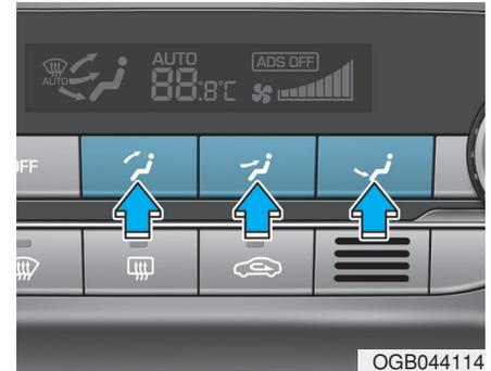
Le bouton de sélection de mode commande le sens de circulation de l'air dans le système de ventilation.
