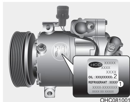
L'étiquette du compresseur vous renseigne sur le type de compresseur dont votre véhicule est équipé tel que le modèle, les références du fournisseur, le numéro de série, le réfrigérant (1) et l'huile frigorigène (2).
