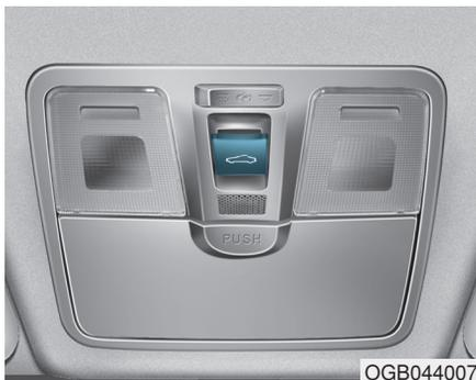
Si votre véhicule est muni d'un toit ouvrant, vous pouvez le faire coulisser ou l'incliner à l'aide du levier de commande situé sur la console au plafond.
