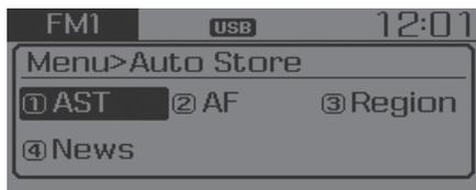
La sauvegarde automatique permet d'enregistrer des fréquences avec une réception supérieure et de les associer aux touches de présélection **1** ~ **6**.
