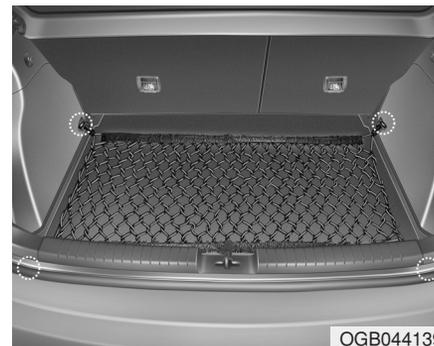
Pour éviter que les objets dans le coffre (sous le panneau du plancher) ne se déplacent, vous pouvez utiliser les 4 attaches situées dans le coffre afin d'installer le filet à bagages.
