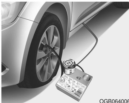
4. Insérez la bouteille de produit d'étanchéité dans le logement (4) du compresseur afin que la bouteille soit en position verticale.
