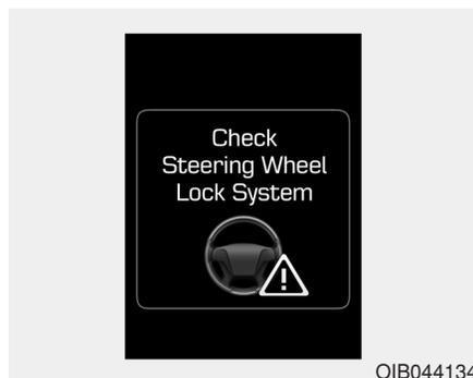
Ce message d'avertissement s'affiche si le volant ne se verrouille pas normalement lorsque le bouton de Démarrage/Arrêt du Moteur passe en position OFF.
