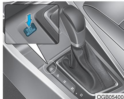
1. Appuyer sur le bouton de déverrouillage du levier de vitesse.
