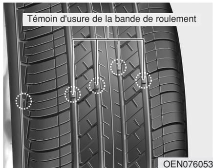
Si le pneu présente une usure homogène, un témoin d'usure de la bande de roulement apparaît comme une bande solide en travers de la sculpture. L'épaisseur de la bande de roulement du pneumatique est alors inférieure à 1,6 mm (1/16 pouce). Dans ce cas, remplacez le pneu.
