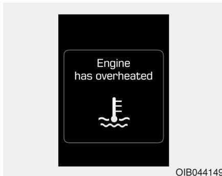
Ce message d'avertissement s'allume lorsque la température du liquide de refroidissement du moteur est supérieure à 120°C. Cela signifie que le moteur est en surchauffe et risque d'être endommagé.
