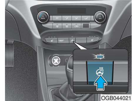
Lorsque le contact est mis ou lorsque le moteur est tourné, en appuyant sur le bouton du volant chauffant permet de chauffer le volant. Le voyant du bouton s'allume. Pour désactiver le chauffage du volant, appuyer une nouvelle fois sur le bouton. Le voyant du bouton s'éteint.
