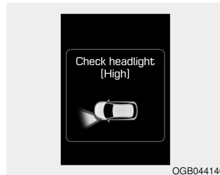
Ce message d'avertissement s'allume s'il ya un dysfonctionnement (ampoule grillée, sauf LED ou dysfonctionnement du circuit) avec des lumières extérieures (phares, feux stop, feux de brouillard, etc). Dans ce cas, nous vous conseillons de faire vérifier votre véhicule par un concessionnaire HYUNDAI agréé.
