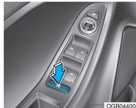
Le conducteur peut désactiver les interrupteurs de lève-vitres électriques sur les portes des passagers arrière en appuyant sur l'interrupteur de verrouillage (lock).
