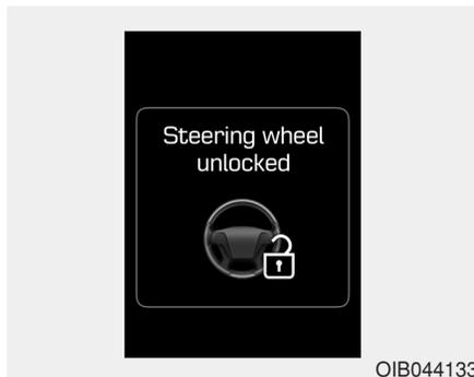
Ce message d'avertissement s'affiche si le volant ne se verrouille pas normalement lorsque le bouton de Démarrage/Arrêt du Moteur passe en position OFF.
