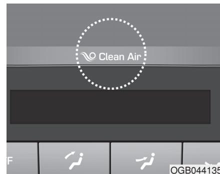
Quand le commutateur d'allumage est en position ON, la fonction d'air propre se met en marche automatiquement.
