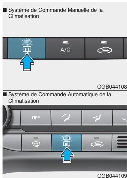
Le dispositif de dégivrage chauffe la lunette afin d'éliminer le givre, le brouillard et la fine couche de glace de la lunette arrière, pendant que le moteur tourne.
