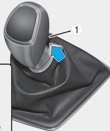
→ Il est possible d'actionner le levier de vitesses sans appuyant sur le bouton (1).
