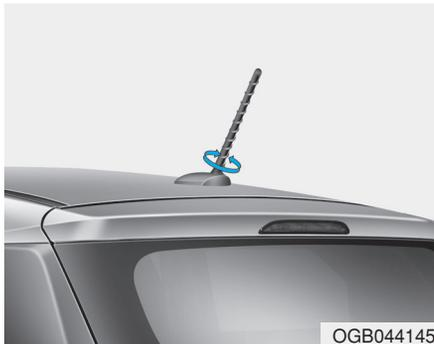
Votre véhicule est équipé d'une antenne de toit permettant de recevoir les signaux des ondes radio AM et FM. Cette antenne est amovible. Pour la retirer, tournez-la dans le sens inverse des aiguilles d'une montre. Pour l'installer, tournez-la dans le sens des aiguilles d'une montre.
