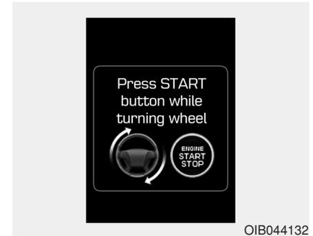
Ce message d'avertissement s'affiche si le volant ne se déverrouille pas normalement lorsque vous appuyez sur le bouton de Démarrage/Arrêt du Moteur.
