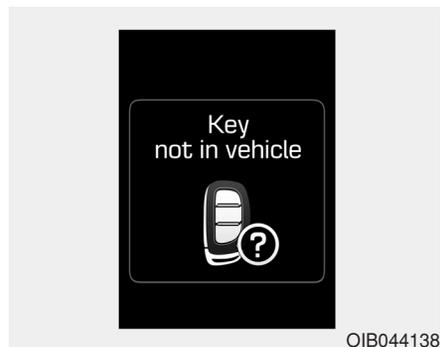
Ce message d'avertissement s'affiche si la clé intelligente ne se trouve pas dans le véhicule lorsque vous appuyez sur le bouton de Démarrage/Arrêt du Moteur.
