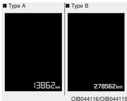
Le compteur kilométrique indique la distance totale parcourue par le véhicule et doit être utilisé pour déterminer les dates de maintenance périodique.
