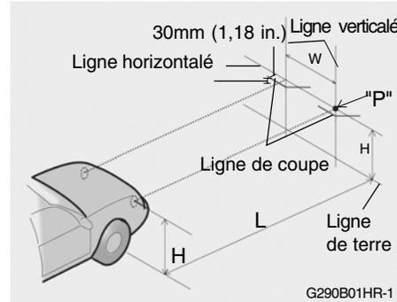
Si des réparations ont été effectuées à l'avant du véhicule et si l'ensemble de projecteur a été remplacé, vous devez vérifier le faisceau de projecteur à l'aide de l'écran comme indiqué dans l'illustration. Activez le contacteur de projecteur (position faisceau-croisement).
