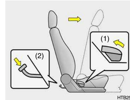
Pour accéder aux places arrière, le siège avant doit être incliné. En soulevant le levier (1) situé du côté extérieur du siège passager avant, le dossier s'incline vers l'avant et le siège avance automatiquement. Les passagers arrière peuvent incliner le dossier en appuyant sur la pédale (2), comme indiqué dans l'illustration.
