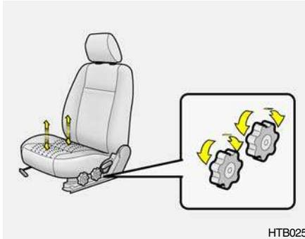
Pour régler la hauteur du coussin de siège, tourner la molette dans le sens approprié.
