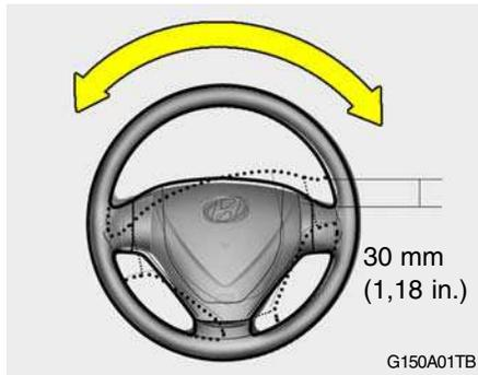
Pour contrôler la course libre du volant, immobiliser la voiture en orientant les roues dans la direction "droit devant" et tourner doucement le volant dans un sens et dans l'autre. N'appuyer que du bout des doigts pour noter le changement de résistance qui indique la limite de la course libre.
