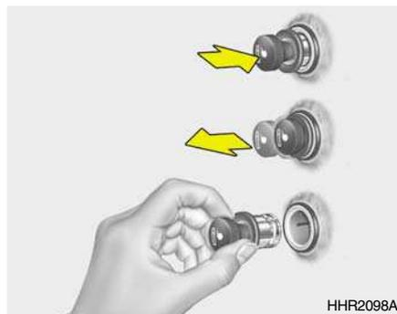
L'allume-cigare ne peut fonctionner que si la clé de contact est en position "ON" ou "ACC".
