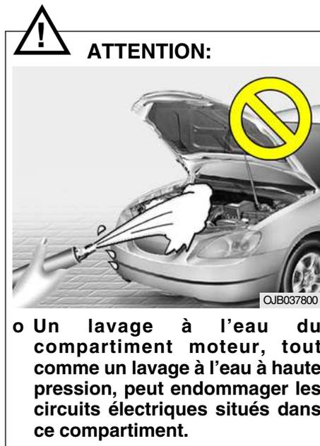
**o Ne laissez jamais de l'eau ou d'autres liquides en contact avec les composants électrique/électronique à l'intérieur du véhicule au risque de les endommager.**
