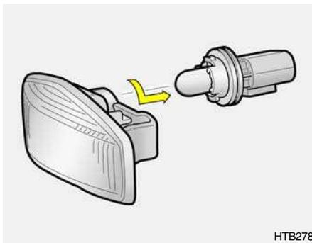
3. Remplacez par une nouvelle ampoule.
