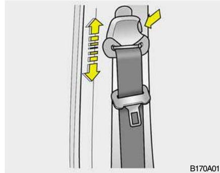
Vous pouvez régler la hauteur de l'ancrage de la ceinture-baudrier sur l'une des 4 positions.
