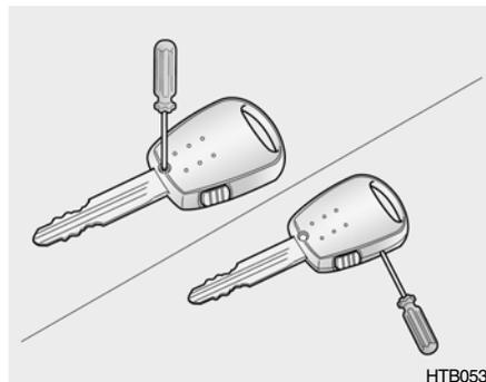
1. Déposez la vis à l'aide d'un tournevis (+).
