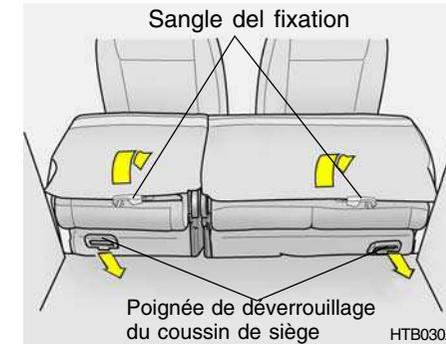
3. Tirez la poignée de déverrouillage du coussin de siège vers l'arrière, puis soulevez le coussin de siège souhaité.
