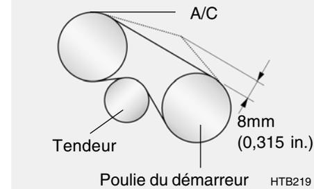
Si le conditionnement d'air est utilisé régulièrement, contrôler au moins une fois par mois la tension de la courroie d'entraînement du compresseur.
