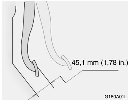
Pour effectuer ce contrôle, un assistant est nécessaire. Moteur en marche, demandez à votre assistant d'appuyer à plusieurs reprises sur la pédale puis de la maintenir enfoncée en exerçant une force d'environ 50 kg (490 N). La garde au sol de la pédale de frein est la distance entre le dessus de la pédale et le revêtement en asphalté sous le paillasson.
