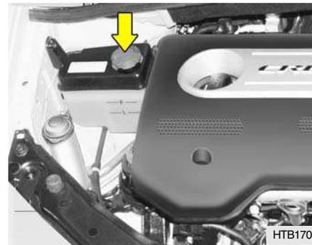
Utiliser un produit de grande qualité composé d'un mélange de 50% d'éthylène-glycol et de 50% d'eau. Le liquide de refroidissement doit être compatible avec les pièces en aluminium du moteur. Ne pas ajouter de produits anticorrosion ou autres additifs. La concentration et le type du liquide de refroidissement doivent être de nature à éviter la congélation et la corrosion du système de refroidissement.
