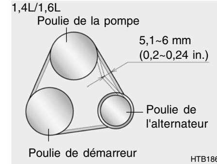
La tension des courroies doit être contrôlée périodiquement et ajustée si nécessaire. Par la même occasion, rechercher toute trace d'anomalie (fissures, usure, effilochage ou autres). Remplacer les courroies si nécessaire. La positionnement des courroies doit également être vérifié pour s'assurer qu'il n'y a pas d'interférence entre les courroies et d'autres parties dumoteur.
