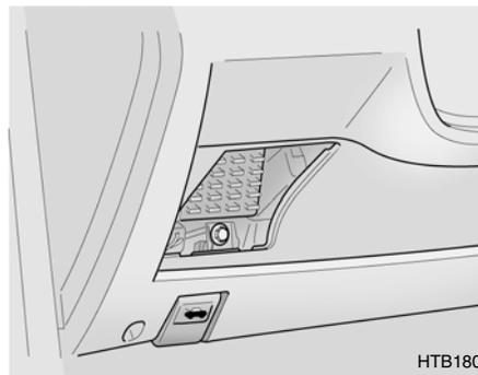
La boîte à fusibles du système d'éclairage et autres accessoires électriques se trouve sous le tableau de bord, côté conducteur. A l'intérieur du boîtier se trouve la liste des circuits protégés par les différents fusibles.
