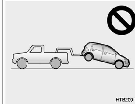
**Un véhicule équipé d'une boîte-pont automatique ne doit jamais être remorqué depuis l'arrière avec les roues avant reposant sur le sol. Cela risque de provoquer de graves dommages sur la boîte-pont.**
