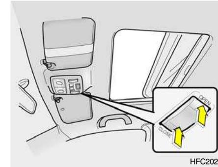
Le toit ouvrant peut être ouvert ou fermé électriquement avec la clé de contact dans la position "ON". Le toit ouvrant est déplacé vers sa position d'ouverture totale en actionnant le commutateur "OPEN" et pour s'arrêter à la position souhaitée, actionnez un commutateur (ouverture, fermeture, haut, bas). Pour fermer, actionnez et maintenez le bouton "CLOSE". Relâchez le bouton lorsque le toit ouvrant atteint la position souhaitée.
