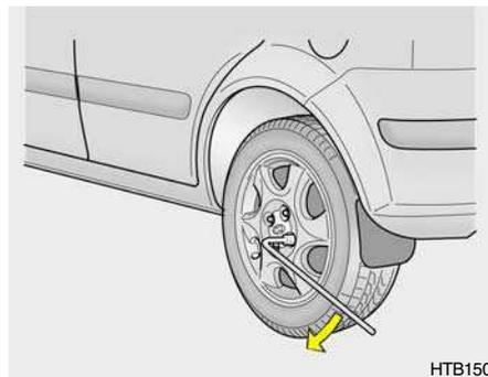
Abaissez le véhicule au sol en tournant la clé pour écrous de roue dans le sens inverse des aiguilles d'une montre. Placez alors la clé comme indiqué sur le dessin et serrez les boulons de la roue. Assurez-vous que la douille est bien enfoncée sur le boulon. Ne grimpez pas sur la clé et n'utilisez pas d'allonge pour serrer excessivement.
