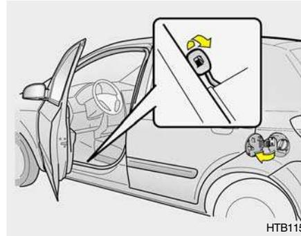
La trappe du bouchon de réservoir peut être ouverte depuis l'intérieur du véhicule en tirant vers le haut le levier d'ouverture de la trappe situé près du sol sur le côté gauche de la voiture.
