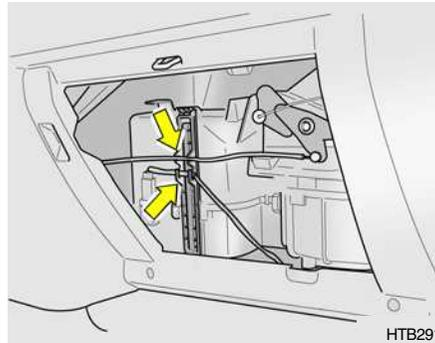
2. Déposez le câble et le câblage du couvercle de filtre.
