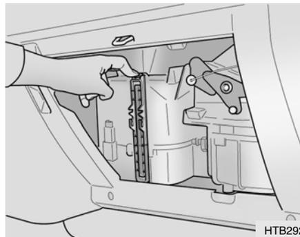
3. Déposez le couvercle de filtre pour pousser le haut du couvercle de filtre.
