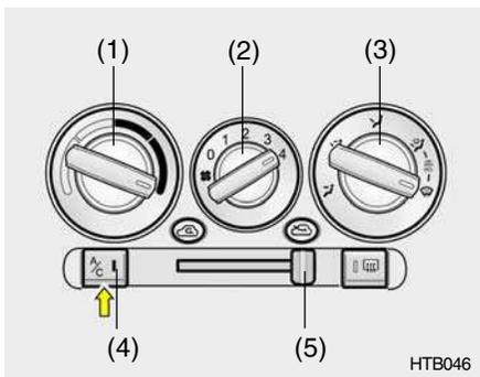
Pour refroidir la température intérieure au moyen du conditionnement d'air:
