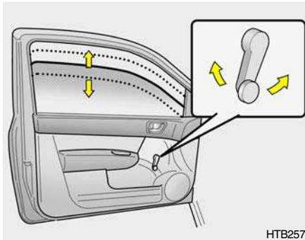
Les vitres des portières peuvent être ouvertes ou fermées en tournant la poignée de la vitre. Assurez-vous que lorsque les vitres sont fermées, rien ne se coince entre le verre et le cadre de la portière.
