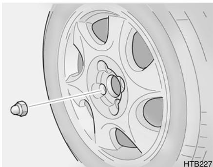
Pour reposer l'enjoliveur, tenez-le sur la roue puis vissez les écrous de roue sur les goujons et serrez-les à la main. Vous devez poser les écrous en orientant leur petit diamètre vers l'intérieur. Secouez la roue de secours pour vous assurer qu'elle repose bien en place, puis serrez de nouveau les écrous de roue à la main.
