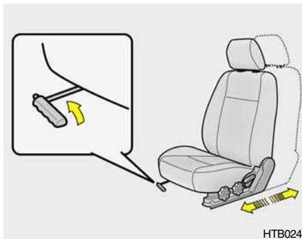
Pour avancer le siège vers l'avant ou l'arrière, tirer le levier vers le haut: Il devient alors mobile sur les rails. Pour le placer à la position voulue. Il suffit de relâcher le levier et de le bouger jusqu'au blocage final.
