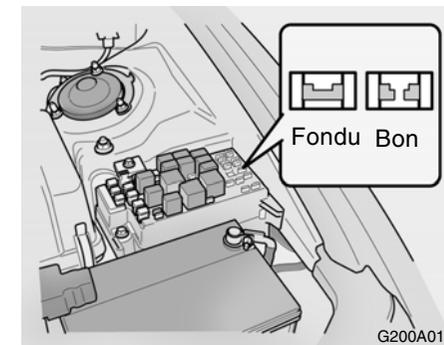
Un raccord fusible fond en cas de surcharge de l'un des circuits électriques branchés sur la batterie, de manière à éviter la destruction de tous les câblages électriques de la voiture. (La surcharge peut résulter d'un court-circuit dans le système). Si un raccord fusible venait à fondre, faire examiner la voiture par un distributeur Hyundai pour qu'il détermine l'origine du problème, répare le système concerné et remplace le raccord fusible. Les
