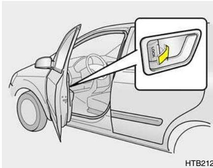
Le verrouillage central des portières fonctionne en appuyant sur l'interrupteur de verrouillage de la portière du conducteur vers l'avant ou l'arrière du véhicule. Si les portières avant et arrière des passagers sont
