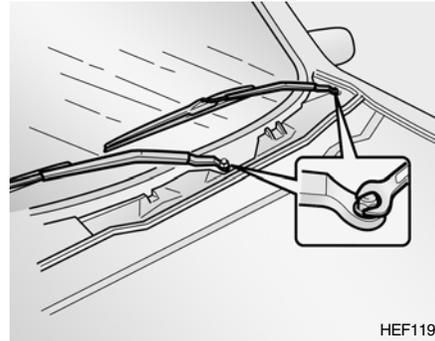
Les balais d'essuie-glace doivent être inspectés attentivement et nettoyés de temps en temps pour enlever les dépôts de poussière et autres. Pour nettoyer les balais et bras d'essuie-glace, utiliser une éponge ou un chiffon propre avec de l'eau et du savon ou un détergent doux.
