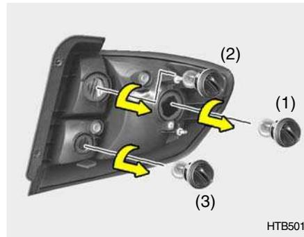
3. Remplacez par une nouvelle ampoule.
