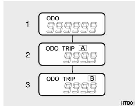
L'odomètre enregistre la distance totale en kilomètres ou miles et permet de conserver des données pour les intervalles de maintenance.
