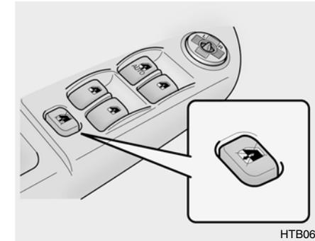
Afin d'éviter tout fonctionnement des vitres, un commutateur de verrouillage de vitre est fourni sur l'accoudoir de la porte du conducteur. Pour invalider les lève-vitres automatiques, appuyez sur le commutateur de verrouillage de vitre.
