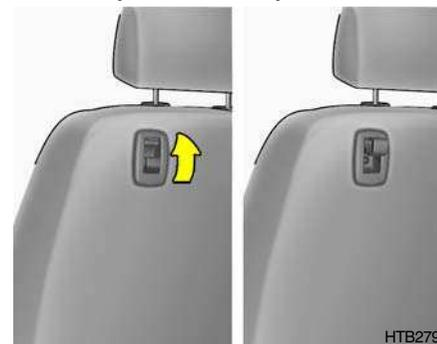
Le support du dossier de siège de passager avant permet de suspendre un sac à provision, etc. Quand vous ne les utilisez pas, ramenez-les à leur position d'origine.
