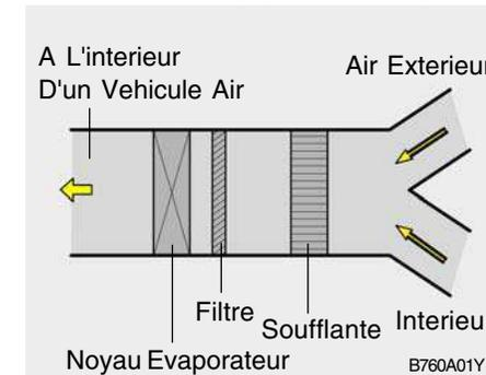
Le filtre du climatiseur est situé à l'avant de l'évaporateur derrière la boîte à gants.
