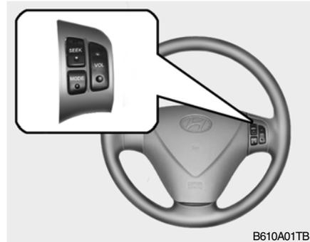
L'interrupteur à distance sur le volant sert à la sécurité lors de la conduite.
