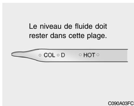
3. Assurez-vous que le niveau de liquide se situe dans la partie "HOT" sur la jauge de liquide. Si le niveau de liquide est plus bas, ajoutez le liquide spécifié dans l'orifice de remplissage. Si le niveau de liquide est plus haut, videz le liquide par l'orifice de vidange.
