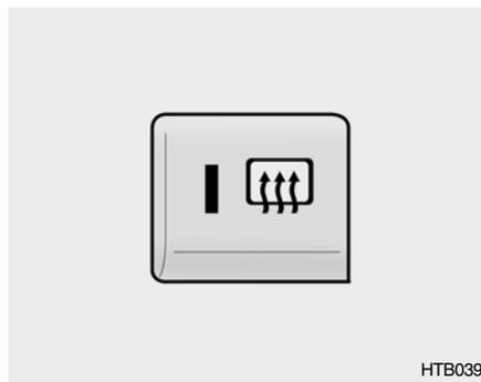
Le dégivrage de la vitre arrière est actionné en appuyant sur l'interrupteur. Pour arrêter la manoeuvre, réappuyer sur l'interrupteur. Le dégivrage de la vitre arrière s'arrête de lui-même après environ 20 minutes pour recommencer l'opération, appuyer de nouveau de l'interrupteur.
