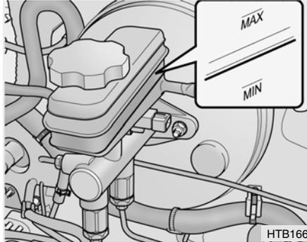
Le niveau du liquide de frein doit être contrôlé régulièrement. Il doit se situer entre les repères "MIN" et "MAX" visibles sur le côté du réservoir. Si le niveau est sur, ou sous, le repère "MIN", ajouter lentement du liquide pour amener le niveau jusqu'au repère "MAX". Ne pas dépasser la limite spécifiée.
