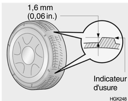
Les pneus d'origine comportent des indicateurs d'usure, qui apparaissent lorsque la profondeur des sculptures ne mesure plus que 1,6 mm. Remplacer les pneus lorsqu'ils apparaissent (barrette faisant la jonction entre deux ou plusieurs rangées de sculptures). Toujours remplacer les pneus en utilisant des pneus ayant la taille recommandée. Si vous changez les roues, utiliser uniquement des roues dont la largeur et le déport de jante sont conformes aux spécifications de Hyundai.
