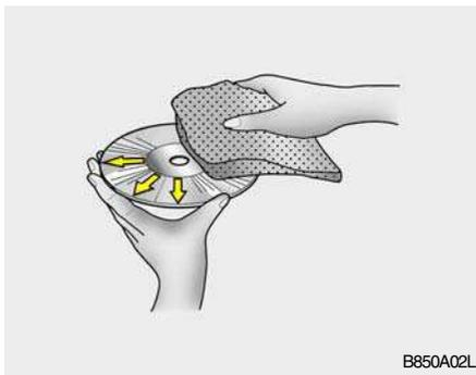
Les traces de doigts, la poussière ou la saleté pourraient causer le mal fonctionnement. Essayez la surface avec un linge propre et doux. Si la surface est très souillée, nettoyez-la avec un linge doux humecté d'une solution d'eau et de détersif doux. Voir illustration.
