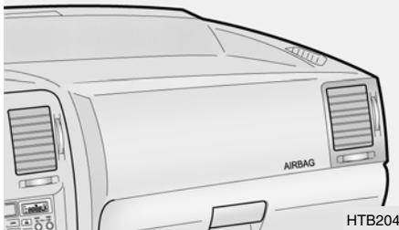
Au déploiement, les joints moulés directement dans le rembourrage se sépareront sous la pression de l'expansion des coussins gonflables; l'ouverture subséquente des rembourrages permettra le gonflage total des coussins.
