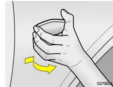
1. Poussez le couvercle vers l'avant du véhicule et déposez-le.
