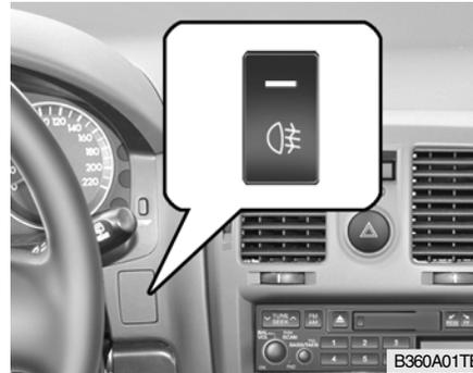
Afin d'activer les phares antibrouillards arrière, actionnez le commutateur. Ils s'allument lorsque le commutateur de phare se trouve dans la seconde position et lorsque la clé se trouve dans la position "ON".
