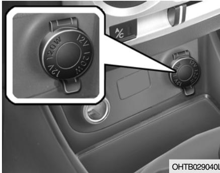
La prise électrique est située sur le tableau de bord central et dans la garniture intérieure.
