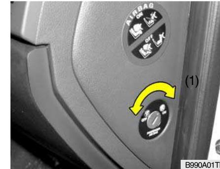
L'air bag avant du passager peut être désactivé grâce à l'interrupteur ON/OFF de l'air bag avant du passager (1) si un système de retenue pour enfants est mis en place sur le siège du passager avant ou si le siège du passager avant n'est pas occupé par une personne.
