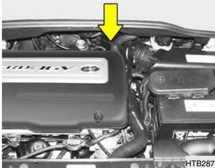
Si le témoin du filtre à carburant s'allume lorsque vous conduisez, cela signifie que l'eau s'est accumulée dans le filtre à carburant.
