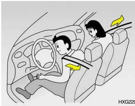
La ceinture de sécurité de pré-tendeur fonctionne de la même manière qu'un rétracteur à blocage d'urgence (ELR) de ceinture de sécurité.
