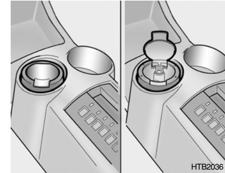
Le cendrier avant peut être ouvert en le tirant par son bord supérieur. Pour fermer le couvercle du cendrier, laissez la poignée du couvercle sortir vers l'extérieur. Pour enlever le cendrier afin de le nettoyer ou le vider, tirez le couvercle pour le sortir. Le support peut être un support pour boissons ou un support pour cendrier.
