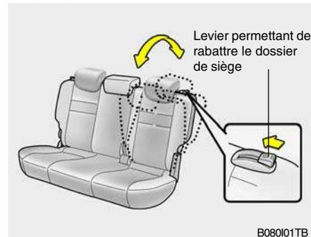
Pour incliner le dossier de siège, poussez le levier permettant de rabattre le dossier de siège vers l'appui tête et relâchez-le une fois l'angle du dossier de siège souhaité obtenu. Lorsque vous inclinez le dossier de siège à la position souhaitée, veillez toujours à ce qu'il soit bien verrouillé.
