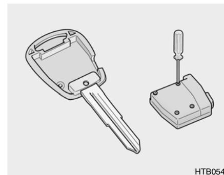
3. Déposez quatre vis à l'arrière du circuit intégré.
