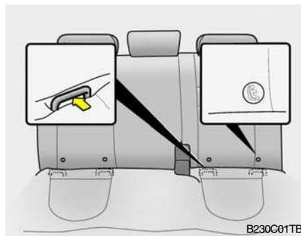
1. Pour engager le siège de retenue pour enfants dans l'ancrage ISOFIX, insérez l'attache du siège de retenue pour enfants dans l'ancrage ISOFIX. Ecoutez s'il y a un "déclic" audible.
