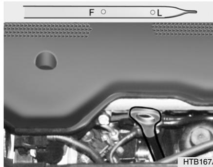
Avant de vérifier l'huile, s'assurer que la voiture est garée sur terrain horizontal et amener le moteur à sa température normale de fonctionnement. Ensuite, couper le moteur.
