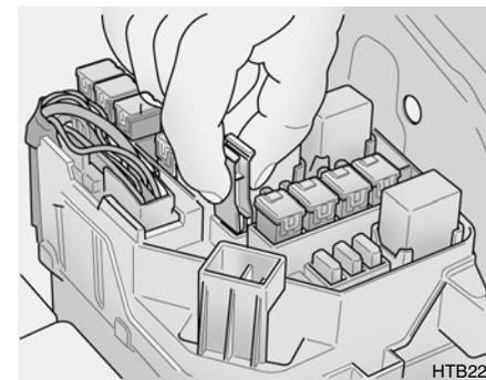
4. Remplacer le fusible fondu en introduisant à sa place un fusible en bon état. Le fusible doit s'adapter sans aucun jeu. Dans le cas contraire, faire réparer le porte-fusible par un distributeur Hyundai. Si vous n'avez pas de fusible de rechange sous la main, utilisez le fusible d'un accessoire dont vous pouvez vous passer momentanément, par exemple le fusible de la radio ou de l'allumecigare. Ne pas oublier de remplacer le fusible emprunté.
