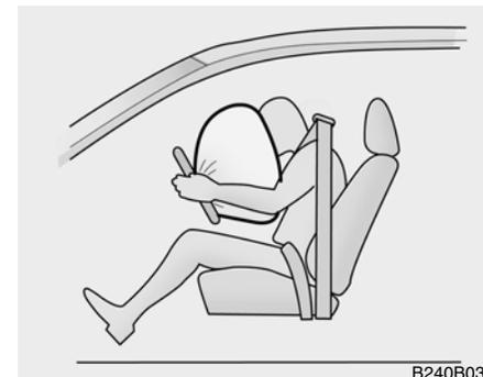
Les modules de coussin gonflable sont situés au centre du volant de direction et dans la planche de bord face au siège du passager avant. Dès que le module détecte une collision frontale considérable, il déploie automatiquement le coussin gonflable.
