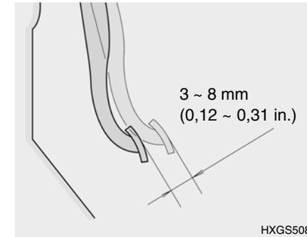
Moteur à l'arrêt, appuyez plusieurs fois sur la pédale de frein pour réduire la dépression dans le servofrein.
