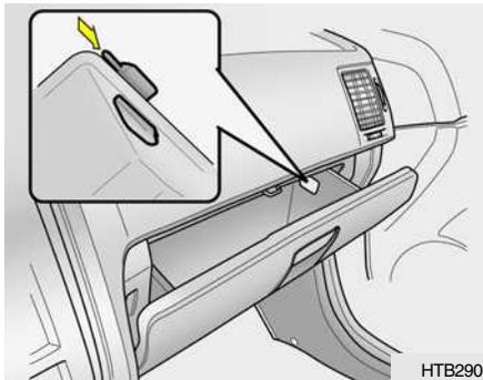
1. Déposez les goupilles de réglage des deux côtés de la boîte à gants pour ouvrir à moitié la boîte à gants.
