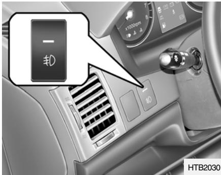
Pour activer les projecteurs antibrouillard avant, actionnez l'interrupteur dans la position « ON ». Il s'allume lorsque l'interrupteur des projecteurs se trouve dans la première ou la seconde position.
