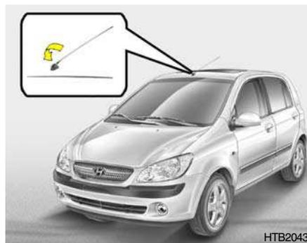
Votre véhicule utilise une antenne de toit pour recevoir les signaux de Radiodiffusion AM et FM.
