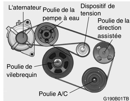
Lors de l'inspection de maintenance programmée, les craquelures, l'usure, l'effilochement ou autre signe de détérioration doivent être vérifiés sur les courroies et elles doivent être remplacées si nécessaire.
