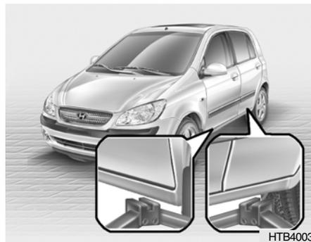
Le pied du cric doit reposer sur un sol ferme et horizontal. Positionner le cric comme indiqué dans l'illustration.
