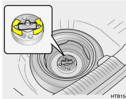
Enlever l'écrou de fixation pour retirer la roue de secours. Pour remettre la roue de secours dans son logement, serrer l'écrou à la main jusqu'à ce que la roue ne puisse plus bouger.
