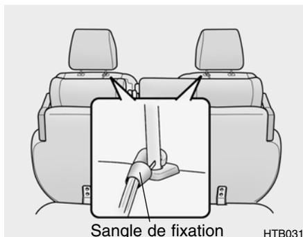
4. Pour fixer le siège, accrochez la sangle de fixation sous le dossier de siège sur le montant de l'appui-tête du siège conducteur et passager avant.
