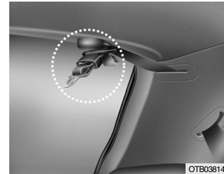
Afin d'éviter que la ceinture-baudrier ne soit endommagée, lorsque vous pliez le siège arrière, la ceinture-baudrier doit être passée via l'œillet .
