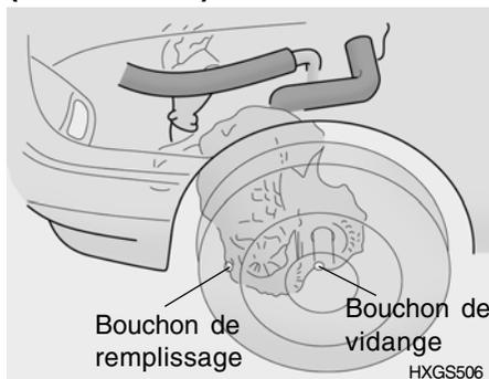
Le lubrifiant de la boîte de vitesse manuelle doit être remplacé aux intervalles spécifiés dans le tableau du programme d'entretien reproduit à la section 5.
