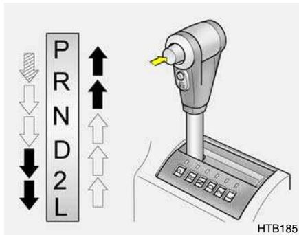
La transmission automatique extrêmement efficace de Hyundai a quatre vitesses avant et une vitesse arrière. Elle a un schéma de changement de vitesse conventionnel ainsi que montré ci-dessous. La nuit, en première position de l'interrupteur multi-fonction, le symbole approprié sur l'indicateur du schéma de changement de vitesse s'illuminera selon la vitesse sélectionnée.
