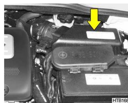
1. Déposez le couvercle du moteur (si installé)
