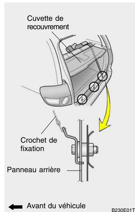
2. Déposez le couvercle du compartiment de chargement.
