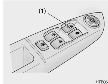
Les lève-vitres automatiques fonctionnent lorsque la clé de contact se trouve dans la position "ON". Les commutateurs principaux se trouvent sur l'accoudoir du conducteur et contrôlent les vitres avant et arrière des deux côtés du véhicule. Les vitres peuvent être ouvertes en appuyant sur le commutateur de vitre approprié et fermées en tirant sur le commutateur. Pour ouvrir la vitre du côté du conducteur, abaissez le commutateur (1). La vitre se déplace tant que le commutateur est actionné.
