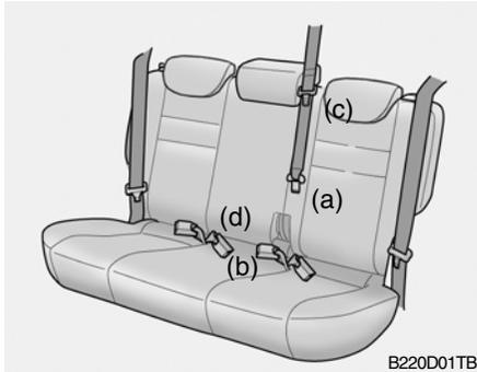
1. Avant de fixer la ceinture centrale du siège arrière, confirmez le verrouillage de la languette en métal (a) et de la boucle (b).
