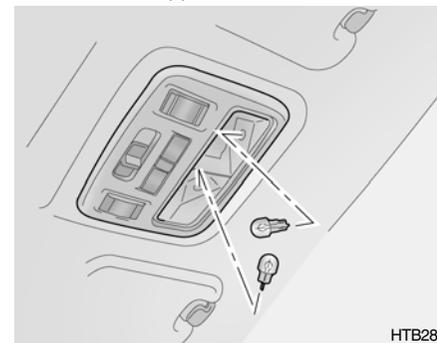
2. Remplacez par une nouvelle ampoule.
