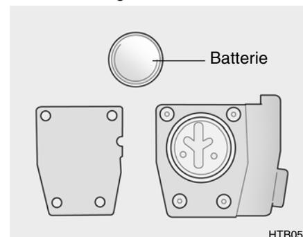
4. Déposez l'ancienne batterie du carter et notez la polarité. Assurez-vous que la polarité de la nouvelle batterie est la même (côté + dirigé vers le haut), puis insérez-la dans le transmetteur.
