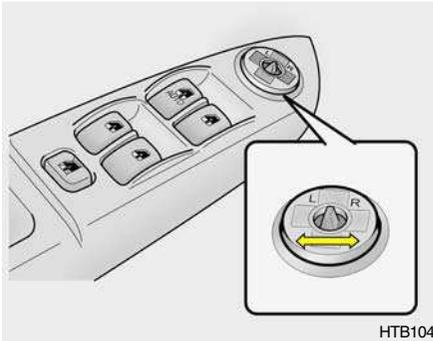
Le rétroviseur arrière externe se règle dans tous les sens pour donner la vision arrière maximum. L'interrupteur de a commande à distance du rétroviseur arrière externe commande les réglages du rétroviseur de portière coté passager. Pour régler la position de l'un des rétroviseurs:
