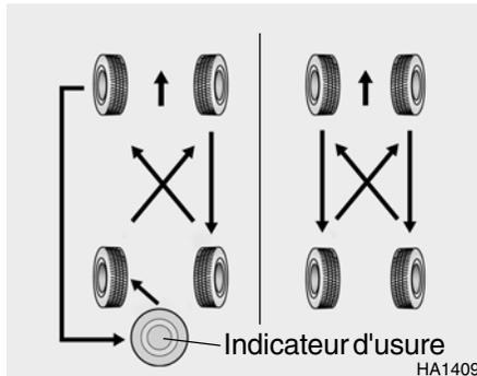
Les pneus devraient être permutés tous les 10.000 km. Si vous remarquez que les pneus s'usent de manière irrégulière, faites vérifier la voiture par un distributeur Hyundai pour remédier au problème. Après avoir permuté les pneus, ajuster la pression et contrôler le couple de serrage des écrous de roue.
