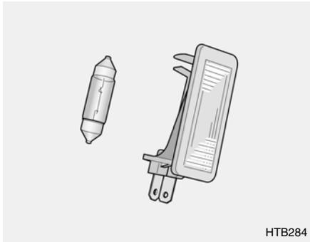
3. Remplacez par une nouvelle ampoule.
