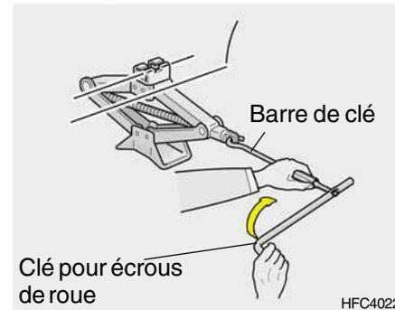
Après avoir inséré une barre de clé dans la clé pour écrous de roues, placez la barre de clé dans le cric comme indiqué dans le croquis. Pour élever le véhicule, tournez la clé pour écrous de roue dans le sens des aiguilles d'une montre.
