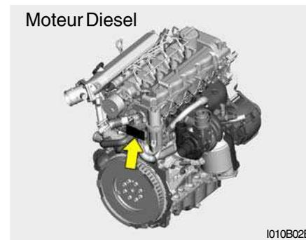
Le numéro du moteur est estampé sur le bloc moteur, à l'endroit indiqué dans l'illustration.
