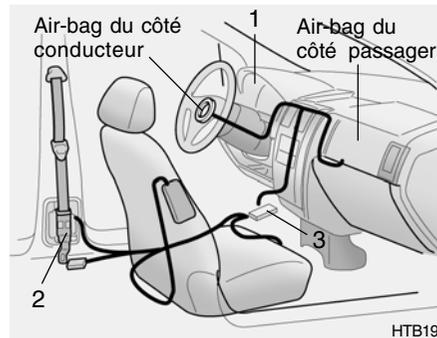
Le système de pré-tendeur de ceinture de sécurité comprend principalement les éléments suivants. Ceux-ci sont indiqués avec leur emplacement dans l'illustration.
