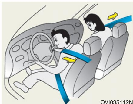
Ce véhicule est équipé de prétendeurs pour les ceintures de sécurité du conducteur et du passager avant. Les prétendeurs servent à s'assurer que les ceintures retiennent efficacement le corps de l'occupant en cas de collision frontale. Les prétendeurs de ceintures de sécurité seront activés lors d'une collision dont la gravité dépasse un niveau prédéterminé.
