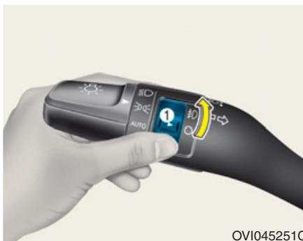
Les phares antibrouillard servent à améliorer la visibilité si les conditions sont mauvaises à cause du brouillard, de la pluie, de la neige, etc. et aident à éviter les accidents. Les phares antibrouillard s'allumeront quand les phares avant sont allumés et que le commutateur des phares antibrouillard (1) est positionné sur ON.
