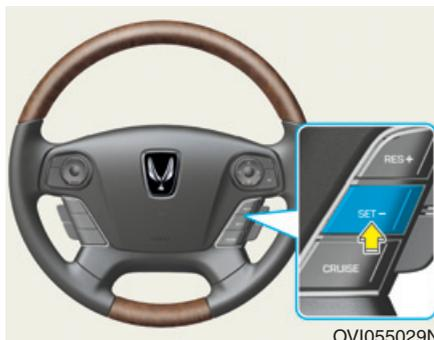
3. Appuyer sur le commutateur SET puis le relâcher à la vitesse désirée. Le voyant SET, la vitesse choisie et la distance avec le véhicule devant s'afficheront au l'écran ACL. Relâcher la pédale de l'accélérateur. Le dispositif maintiendra automatiquement la vitesse choisie.
