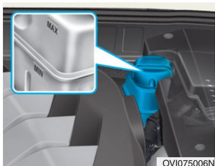
Vérifier régulièrement le niveau de liquide de frein dans le réservoir. Le niveau du liquide devrait se situer entre les marques MAX et MIN situées sur le côté du réservoir.
