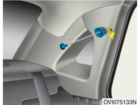
3. Enlever le bouchon, puis desserrer la vis de fixation.
