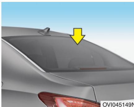
Si le commutateur de la radio est allumé et que le bouton d'arrêt/démarrage du moteur est sur la position "ON" ou "ACC", les signaux AM et FM sont reçus par l'antenne intégrée à la lunette arrière du véhicule.
