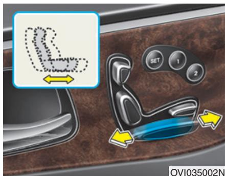
Pousser les boutons de commande vers l'avant ou vers l'arrière pour ajuster le siège à la position désirée. Relâcher le bouton quand le siège se trouve à la position désirée. La position de l'appuie-tête est modifiée simultanément.
