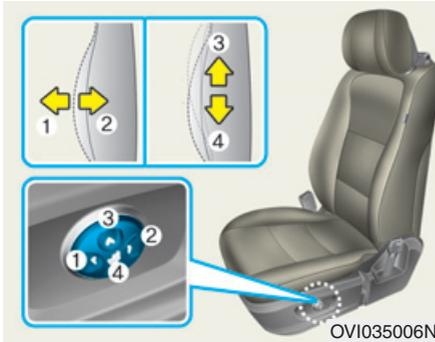
On peut régler le soutien lombaire en appuyant sur le commutateur situé sur le côté du siège du conducteur. Appuyer sur la partie avant du commutateur (1) pour augmenter le soutien lombaire ou sur la partie arrière (2) pour le réduire.
