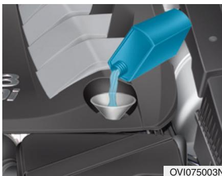
Si le niveau d'huile est proche du L ou au même niveau, ajouter de l'huile de moteur de façon à ce que le niveau atteigne F. **Ne pas dépasser de niveau.**
