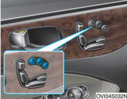
Ce dispositif mémorise la position du siège du conducteur, des rétroviseurs extérieurs et du volant, ainsi que la hauteur de l'affichage au plafond. Si la batterie est débranchée, la mémoire est effacée et la position de conduite doit être de nouveau mémorisée. Si le système ne fonctionne pas correctement, demander à un concessionnaire HYUNDAI agréé d'inspecter le véhicule.
