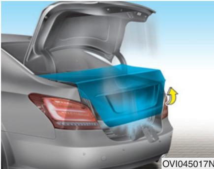
Si la trajectoire du couvercle du coffre est bloquée par quelque chose ou quelqu'un pendant l'ouverture ou la fermeture, le coffre électrique détectera la résistance, s'arrêtera et inversera sa direction pour dégager l'objet.
