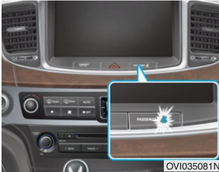
Le voyant de ceinture non bouclée de la ceinture du passager avant clignotera dès que le commutateur d'allumage est positionné sur ON, que la ceinture soit bouclée ou non. Si la ceinture du passager avant n'est pas bouclée, que le véhicule se déplace à plus de 10 km/h (6 mi/h) et que la présence du passager est détectée, le voyant clignotera jusqu'à ce que la ceinture soit bouclée.
