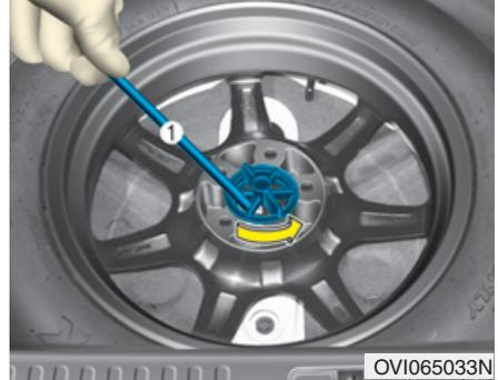
S'il est impossible de desserrer le boulon à ailettes à la main, utiliser la poignée du cric pour le desserrer.
