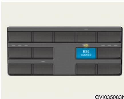
Si les réglages du siège arrière sont verrouillés, la touche RSE LOCKED s'allumera.
