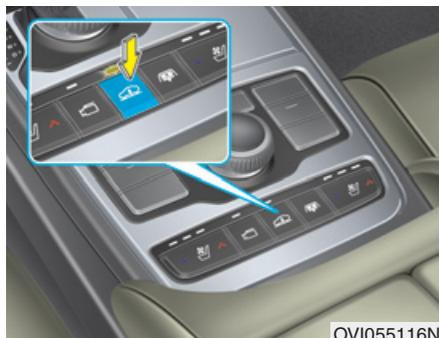
La suspension contrôlée électroniquement (ECS) contrôle automatiquement la suspension du véhicule pour maximiser le confort des passagers grâce à un ressort pneumatique et à un amortisseur réglable.
