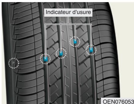
Si les pneus s'usent inégalement, un indicateur d'usure apparaîtra, montrant une ligne continue le long de la bande de roulement. Cela indique qu'il reste moins de 1,6 mm (1/16 po) sur la bande de roulement du pneu. Remplacer le pneu quand l'indicateur d'usure apparaît.
