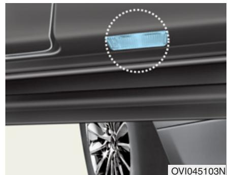
L'éclairage de courtoisie des portières s'allume quand la portière est ouverte, pour faciliter l'entrée et la sortie. Il permet également d'avertir les autres conducteurs que la portière est ouverte.
