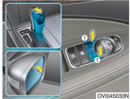
Quand le levier de vitesses est positionné sur R (marche arrière), les rétroviseurs extérieurs s'inclineront légèrement vers le bas pour aider le conducteur à effectuer sa marche arrière. La position du commutateur des rétroviseurs (1) détermine si les rétroviseurs s'inclineront vers le bas ou non :
