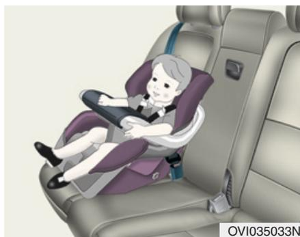
Un siège pour enfant faisant face à l'avant retient le corps de l'enfant à l'aide d'un harnais. Continuer d'utiliser un siège pour enfant faisant face à l'avant et le harnais jusqu'à ce que l'enfant atteigne les limites maximales de taille et de poids indiquées par le fabricant du siège.
