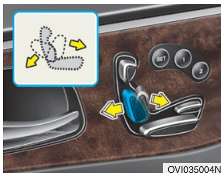
Pousser la partie supérieure du commutateur vers l'avant ou vers l'arrière pour incliner le dossier. Relâcher le commutateur quand le dossier se trouve à la position désirée.
