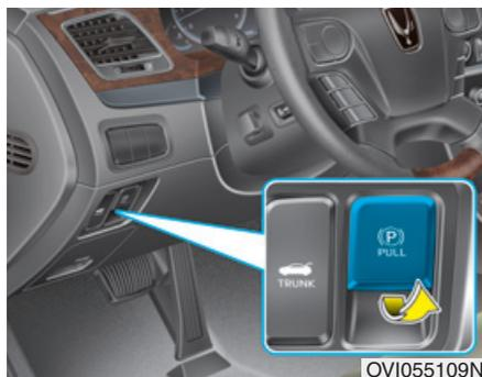
Pour enclencher le frein de stationnement électrique (EPB), appuyer d'abord sur la pédale de frein, puis tirer sur le commutateur du frein de stationnement électrique (EPB). S'assurer que le voyant s'allume.
