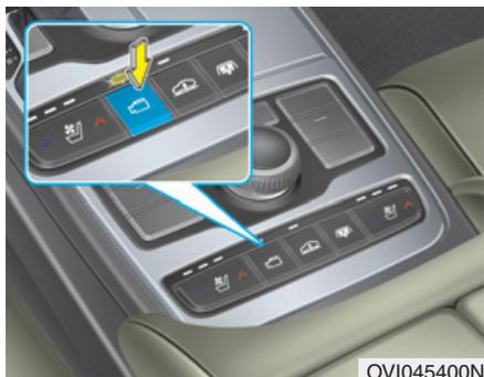
Le système de caméras multiples aide lors des manœuvres et permet au conducteur de voir tout autour de son véhicule. Pour activer les caméras, appuyer sur la touche. Appuyer de nouveau sur la touche pour désactiver les caméras.
