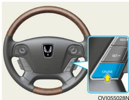
1. Appuyer sur la touche CRUISE située sur le volant pour activer le dispositif. Le voyant CRUISE s'allumera au tableau de bord.
