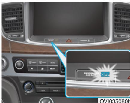
Ce véhicule est doté d'un système de classification des occupants (OCS) pour le siège du passager avant. L'OCS a pour but de détecter la présence d'un passager avant correctement assis et de déterminer si le coussin gonflable du passager avant doit être activé ou non. Le coussin gonflable du conducteur n'est ni concerné ni contrôlé par l'OCS.
