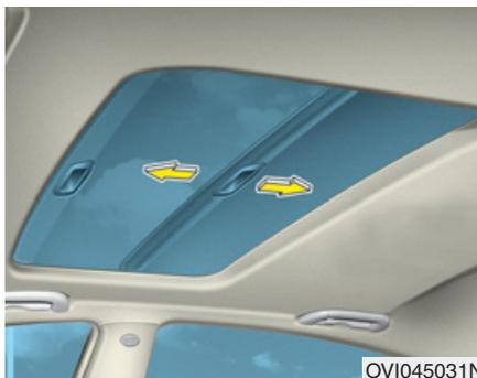
Le pare-soleil s'ouvrira automatiquement avec le toit ouvrant si le panneau en verre se déplace. Il est également possible de fermer le pare-soleil à la main. Ne pas laisser le pare-soleil fermé si le toit ouvrant est ouvert.
