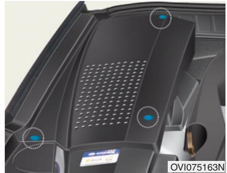
1. Appuyer sur le dessus des attaches pour retirer le couvercle.
