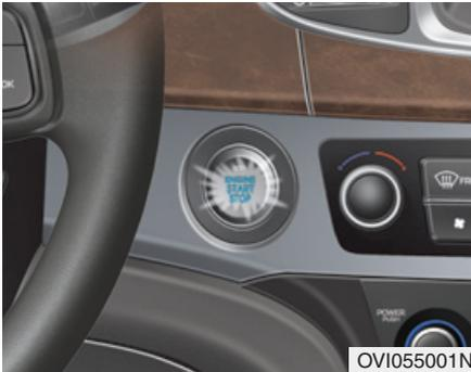
Le bouton de démarrage/arrêt du moteur s'allumera lorsqu'une portière est ouverte. L'éclairage s'éteindra 30 secondes après la fermeture de la portière.
