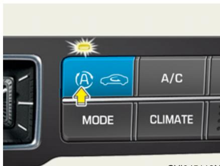
Il est possible de contrôler automatiquement la prise d'air extérieure, en appuyant sur cette touche pour activer le système de contrôle de la qualité de l'air (AQS).
