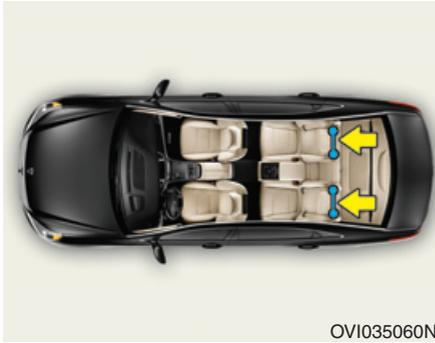
Certains fabricants font des sièges compatibles avec les dispositifs de fixation LATCH. LATCH signifie "Ancrages et attaches inférieurs pour sièges pour enfant". Ces sièges pour enfant sont dotés de deux attaches rigides ou fixées sur des courroies pouvant être attachées aux deux ancrages LATCH du véhicule. Il n'est pas nécessaire d'utiliser une ceinture de sécurité pour fixer ces sièges au siège arrière.
