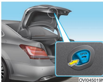
Ce véhicule est équipé d'un levier d'ouverture d'urgence, situé dans le coffre. Si quelqu'un est enfermé par inadvertance dans le coffre, il pourra l'ouvrir en soulevant le levier dans le sens de la flèche et en le poussant.
