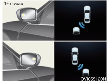
Si un véhicule est détecté dans la zone de détection, un voyant s'allumera sur le rétroviseur extérieur et sur l'affichage au pare-brise.
