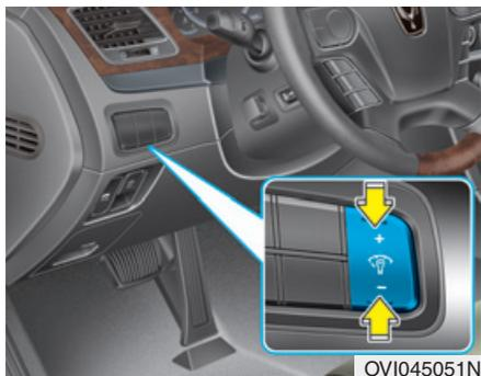
On peut ajuster la luminosité du tableau de bord en appuyant sur les touches ("+" ou "-") quand le bouton de démarrage/arrêt du moteur est sur ON et que les feux sont allumés.
