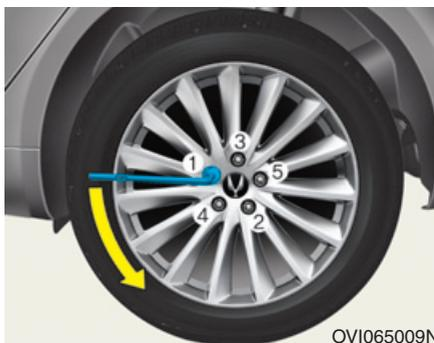
6. Desserrer les écrous de roues en les tournant dans le sens inverse des aiguilles d'une montre, dans l'ordre indiqué par les chiffres de l'illustration. Enlever les écrous uniquement lorsque la roue n'est plus en contact avec le sol.
