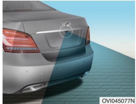
La caméra de recul s'enclenche quand le moteur est allumé et que le levier de vitesses est positionné sur R (marche arrière).
