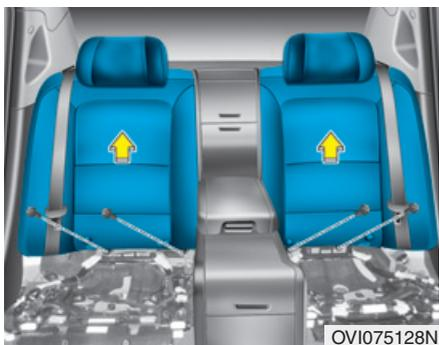
3. Desserrer les boulons de fixation, puis retirer les dossiers du siège arrière.
