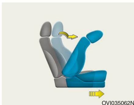
**Abaisser le siège du passager avant pour permettre le passage vers l'arrière**
