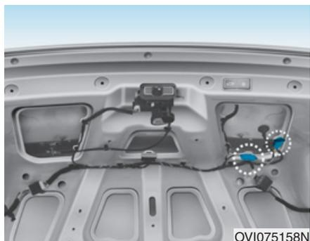
8. Desserrer les écrous et débrancher les connecteurs.
