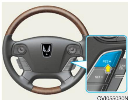
Si le conducteur annule la vitesse de conduite sans appuyer sur le commutateur CRUISE, et si le régulateur est toujours actionné, on peut reprendre la vitesse enregistrée le plus récemment en appuyant sur le commutateur RES+.
