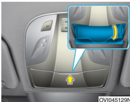
Pour ouvrir l'étui à lunettes, appuyer sur le couvercle et l'étui s'ouvrira lentement. Placer les lunettes de soleil dans l'étui avec les verres vers l'extérieur. Pour refermer l'étui à lunettes, pousser le couvercle en place.
