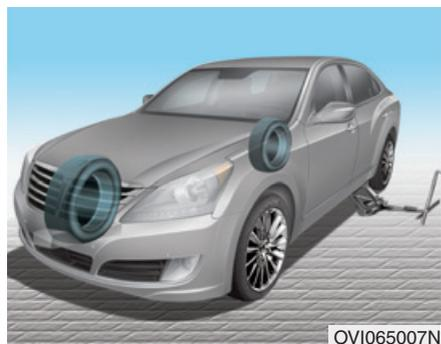
4. Enlever la clé pour écrous de roues, le cric, la poignée du cric et la roue de secours du véhicule.
