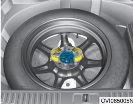
Pour dégager la roue de secours, dévisser le boulon à ailettes en le tournant dans le sens inverse des aiguilles d'une montre.
