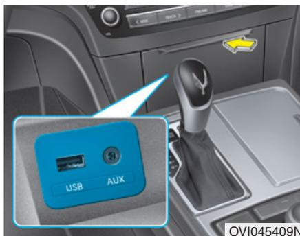
Si le véhicule est doté de ports AUX et/ou USB ou iPod®, il est possible d'utiliser le port AUX pour brancher des appareils audio, le port USB pour brancher une clé USB et le port iPod® pour brancher un iPod®.
