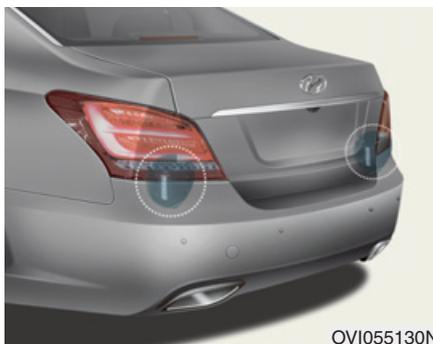
Les capteurs sont situés dans le pare-chocs arrière.
