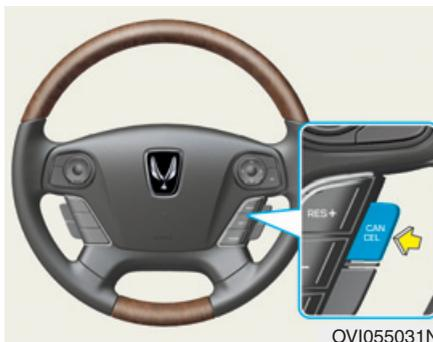
**Le régulateur de vitesse intelligent sera annulé manuellement dans les situations suivantes :**
