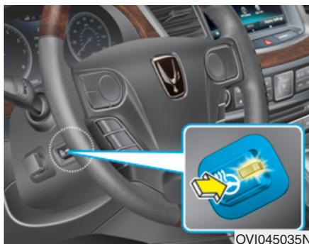
Avec le bouton de démarrage/arrêt du moteur sur ON, appuyer sur la touche de chauffage du volant pour le réchauffer. Le voyant s'allumera. Pour éteindre le chauffage du volant, appuyer de nouveau sur la touche. Le voyant s'éteindra. Le chauffage du volant s'éteindra automatiquement après environ 30 minutes.
