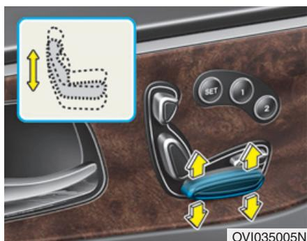
Pousser la portion avant du commutateur vers le haut pour soulever la partie avant du coussin ou vers le bas pour l'abaisser. Pousser la portion arrière du commutateur vers le haut pour soulever la partie arrière du coussin ou vers le bas pour l'abaisser. Relâcher le commutateur quand le siège se trouve à la position désirée.
