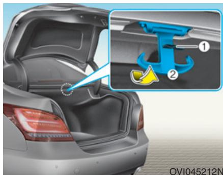
Tirer sur la courroie (1) pour accrocher un sac au crochet (2).
