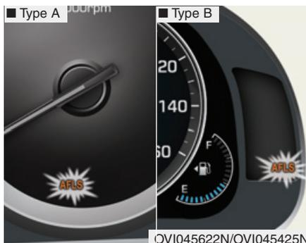
Si le voyant AFLS s'allume, cela signifie que l'AFLS ne fonctionne pas correctement. Garer le véhicule dans un endroit sécuritaire et éteindre le moteur. Rallumer ensuite le moteur. Si le voyant reste allumé en continu, demander à un concessionnaire HYUNDAI agréé d'inspecter le véhicule.
