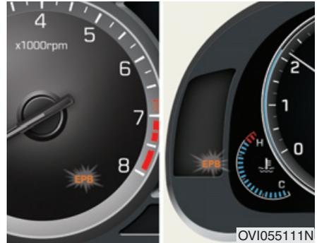
Si le frein de stationnement électrique fonctionne correctement, le voyant s'allumera pendant environ 3 secondes après que le bouton de démarrage/arrêt du moteur est placé sur ON.
