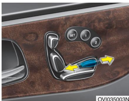
Pousser le commutateur vers l'avant ou vers l'arrière pour augmenter ou réduire la longueur du coussin. Relâcher le commutateur quand la longueur du coussin se trouve à la position désirée.
