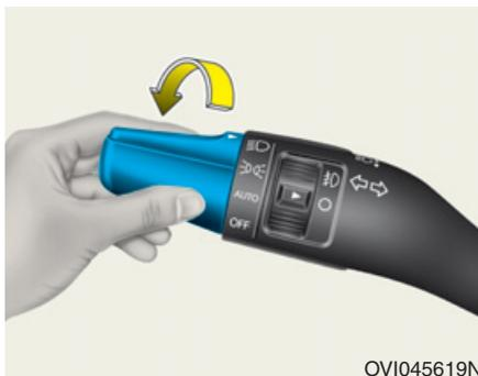
Si le commutateur des phares est en position des feux de route, les phares avant, les feux arrière, l'éclairage de la plaque d'immatriculation et l'éclairage du tableau de bord seront allumés.
