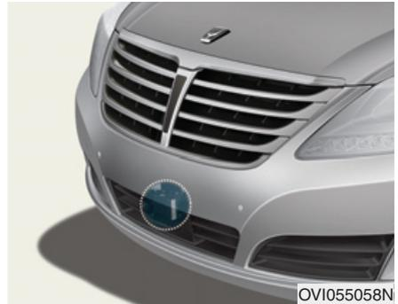
Ce capteur calcule la distance entre ce véhicule et le véhicule devant.
