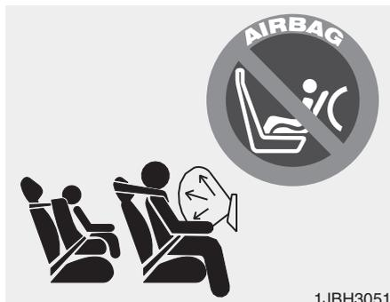
Ne jamais mettre un siège pour enfant faisant face à l'arrière sur le siège du passager avant. Si un coussin gonflable se déploie, l'impact sur le siège pour enfant faisant face à l'arrière pourrait provoquer des blessures graves ou mortelles. Ne pas non plus mettre de siège pour enfant faisant face à l'avant sur le siège du passager avant, car l'enfant pourrait subir des blessures graves ou mortelles à cause du déploiement du coussin gonflable.
