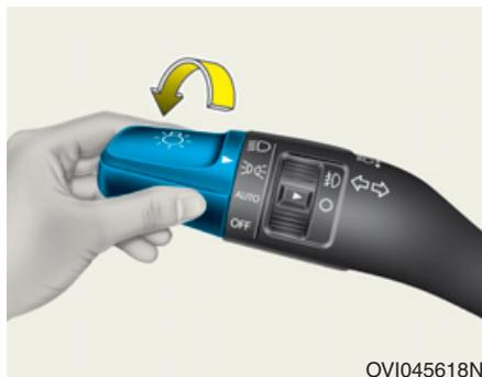
Si le commutateur des phares est en position des feux de position, les feux arrière, les feux de position, l'éclairage de la plaque d'immatriculation et l'éclairage du tableau de bord seront allumés.
