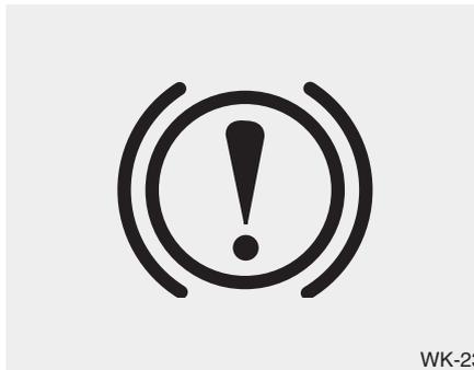
Vérifiez le témoin du frein en tournant le commutateur d'allumage sur ON (ne lancez pas le moteur). Ce voyant sera lumineux lorsque le frein de stationnement est actionné avec le contacteur d'allumage sur START ou ON.
