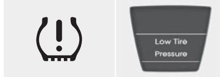
Lorsque l'indicateur du système de contrôle de la pression des pneus s'allume, et qu'un message d'avertissement s'affiche sur l'écran LCD du combiné, cela signifie qu'un ou plusieurs de vos pneus ne sont pas assez gonflés.
