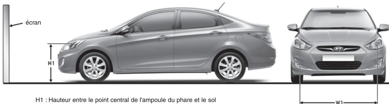
H1 : Hauteur entre le point central de l'ampoule de phare et le sol
