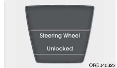
Lorsque le volant ne se verrouille pas, le voyant s'allume pendant 10 secondes sur l'écran LCD.
