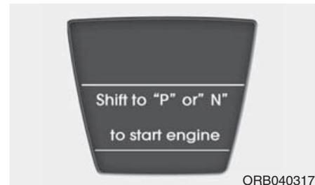
Si vous tentez de démarrer le moteur alors que le levier de vitesses n'est pas en position P (Parking) ou N (Point mort), le voyant s'allume pendant 10 secondes sur l'écran LCD.
