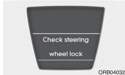
Lorsque le volant ne se verrouille pas, le voyant s'allume pendant 10 secondes sur l'écran LCD.
