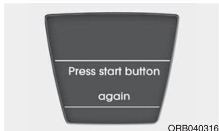
Si le système du bouton de démarrage/d'arrêt du moteur rencontre un dysfonctionnement, le voyant s'allume pendant 10 secondes pour indiquer que vous pouvez démarrer le moteur en appuyant sur le bouton de démarrage/d'arrêt du moteur, tout en appuyant sur la pédale de frein.
