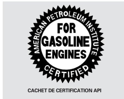
L'huile à moteur Honda est le lubrifiant 0W-20 préféré pour ce véhicule. Il est fortement recommandé d'utiliser l'huile à moteur Honda dans ce véhicule pour une protection maximale du moteur. Assurer que le sceau de certification API porte la mention "pour moteurs à essence".
