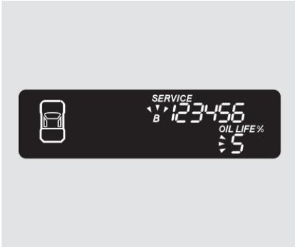
3. Appuyer sur le bouton “TRIP/RESET” pendant environ 10 secondes. La durée utile de l’huile à moteur et le(s) code(s) de l’article d’entretien clignoteront.
