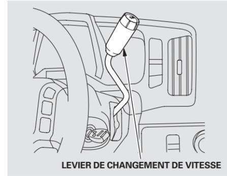
Pour embrayer de n'importe quelle position, enfoncer la pédale des freins fermement et tirer le levier vers soi. On ne peut embrayer hors de "Park" quand l'interrupteur d'allumage est à ANTIVOL (0) ou ACCESSOIRE (I).
