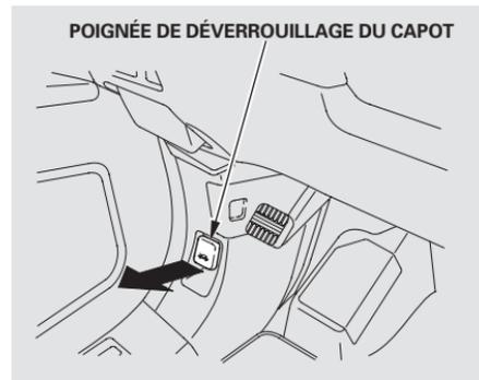
1. Stationner le véhicule et serrer le frein de stationnement. Tirer la poignée de déverrouillage du capot située sous le coin inférieur gauche sous le tableau de bord. Le capot s'entrouvre.
