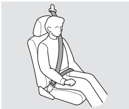
Faire passer la partie sous-abdominale de la ceinture le plus bas possible en travers des hanches, puis tirer sur le baudrier pour bien ajuster la ceinture. De cette façon, le bassin amortira la force lors d'une collision et réduira les risques de blessures internes.
