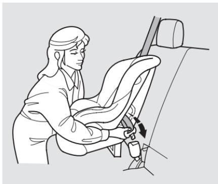
1. Quand le siège d'enfant est à la position souhaitée à l'arrière, acheminer la ceinture de sécurité dans le siège d'enfant conformément aux directives du fabricant du siège puis insérer la languette dans le fermoir et bien serrer la partie abdominale de la ceinture de sécurité.
