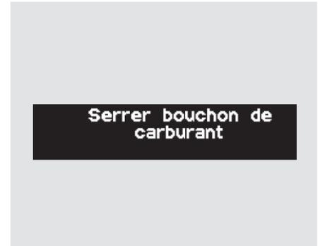
Le système de diagnostic à bord du véhicule détectera un bouchon du réservoir à essence manquant ou desserré en tant que fuite du système d'évaporation. La première fois qu'une fuite est détectée, un message "Serrer bouchon de carburant" paraîtra sur l'affichage multi-information.
