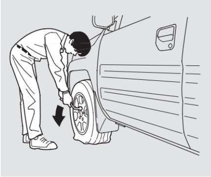
8. Desserrer chaque écrou de roue un demi-tour avec la clé pour écrou de roue.
