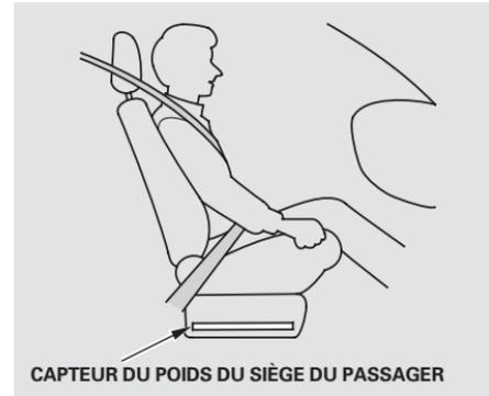
Le système intelligent du coussin gonflable avant du passager comporte des capteurs du poids sous le siège. Bien que Honda ne recommande pas qu'un bébé ou qu'un enfant de petite taille prenne place à l'avant, si les capteurs détectent qu'un bébé ou qu'un enfant de petite taille (jusqu'à environ 29 kg ou 65 livres) est sur le siège, le système annulera automatiquement le coussin gonflable avant du passager.
