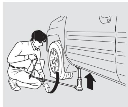
13. Tourner la molette du cric (clé pour écrous de la roue) vers la droite, tel que représenté, pour lever le véhicule jusqu'à ce que le pneu crevé soit loin du sol.
