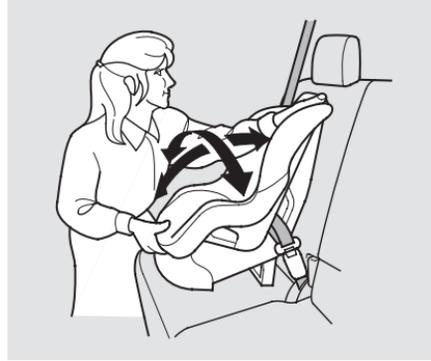
5. Pousser et tirer le siège d'enfant vers l'avant et d'un côté et de l'autre pour confirmer qu'il reste parfaitement en place lors de manoeuvres normales. Si le siège d'enfant n'est pas assez solide, détacher la ceinture, la laisser s'enrouler complètement puis répéter ces étapes.
