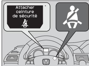
Le véhicule surveille l'utilisation des ceintures de sécurité avant. Si le commutateur d'allumage est en position MARCHE **(II)** avant que la ceinture de sécurité du conducteur ne soit bouclée, un signal sonore se fera entendre et le témoin clignotera. Si le conducteur ne boucle pas la ceinture avant l'arrêt du signal sonore, le témoin restera allumé.
