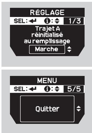
6. Appuyer sur le bouton / et sélectionner **Marche**, puis appuyer sur le bouton **SEL/RESET** (sélectionner/réinitialiser).
