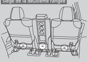
Chaque place assise de la deuxième et de la troisième rangée est pourvue d'un point d'ancrage de sangle d'attache à l'arrière. Un siège de sécurité pour enfant muni d'une sangle d'attache et qui est installé à l'aide d'une ceinture de sécurité doit utiliser la sangle d'attache pour une sécurité accrue.
