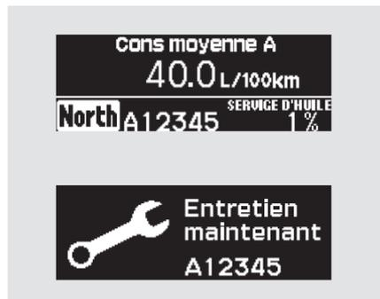
Quand la durée utile de l'huile à moteur est de moins de 5 pour cent, on verra l'affichage ci-dessus. L'affichage passe à "Entretien maintenant". L'entretien indiqué doit être effectué le plus tôt possible.
