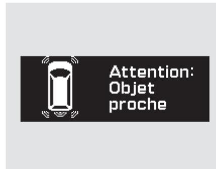
Ce message et le témoin à gauche du message font partie du système des capteurs du stationnement. Si on se rapproche trop d’un obstacle, le message “Attention: Objet proche” s’affiche et un signal sonore se fait entendre. Consulter la page 353 pour de plus amples renseignements.
