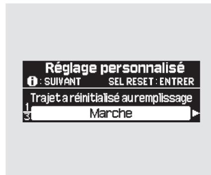
Appuyer sur le bouton “SEL/RESET”. L’affichage change tel que représenté ci-dessus. Le segment inférieur passe de “Marche” à “Arrêt” chaque fois qu’on appuie sur le bouton INFO. Programmer le choix en appuyant sur le bouton “SEL/RESET”.
