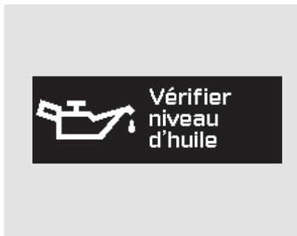
Si le niveau de l'huile à moteur est très bas ou manque de pression, "Vérifier niveau d'huile" paraîtra sur l'affichage multi-information. Le témoin de la basse pression d'huile clignotera ou restera allumé sur le tableau de bord. Si ce message paraît, il faut prendre des mesures immédiates car le moteur pourrait subir des dommages graves. Suivre la procédure de la page 471.
