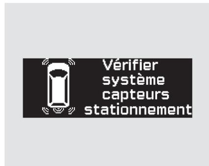
Si le système de capteurs du stationnement est défectueux, l'affichage multi-information montre le message "Vérifier système capteurs stationnement". Consulter la page 354 pour de plus amples renseignements.
