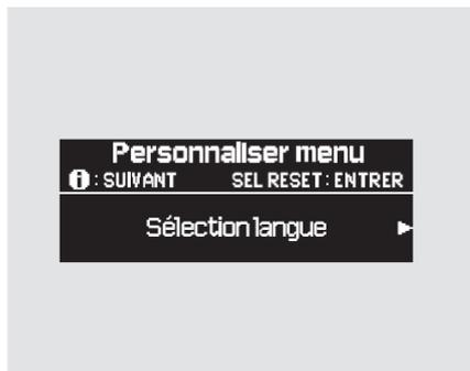
Pendant que l'affichage multi-information montre "Réglage indicateurs", appuyer sur le bouton "SEL/RESET" sur le volant. L'affichage passe à "Sélection langue". Appuyer sur le bouton "SEL/RESET" de nouveau pour programmer le mode du choix de la langue.
