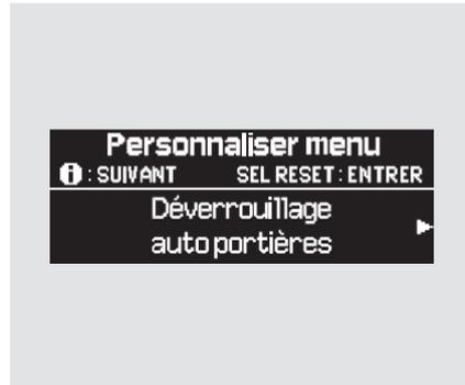
Pendant que l'affichage multi-information montre “Réglage portes/vitres”, appuyer sur le bouton “SEL/RESET” sur le volant. Puis, appuyer une fois sur le bouton INFO. L'affichage passe à “Déverrouillage auto portières” tel que représenté ci-dessus.
