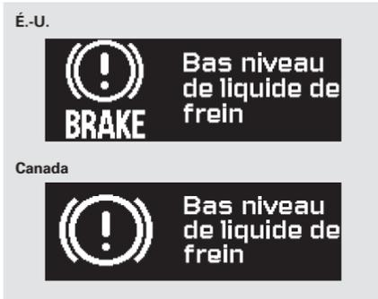
Si le niveau du liquide des freins est au repère MIN ou sous ce dernier sur le côté du réservoir du liquide des freins dans le compartiment moteur, “Bas niveau de liquide de frein” s’affiche. Si ce message paraît, faire vérifier le système des freins par le concessionnaire (consulter la page 473).
