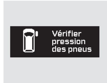
Quand la pression de l'un des pneus est basse, l'indicateur de la basse pression des pneus/TPMS s'allume sur le tableau de bord, l'affichage multi-information courant est interrompu et le message "Vérifier pression des pneus" s'affiche. On peut voir une ou plusieurs positions de pneus dégonflés surbrillés dans l'affichage en même temps que le message.
