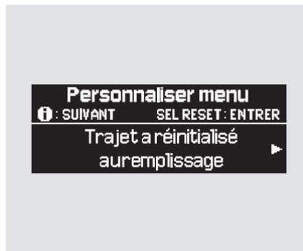
Avec l’affichage multi-information à “Réglage indicateurs” de “Personnaliser groupe”, appuyer sur le bouton “SEL/RESET” sur le volant. L’affichage passe à “Personnaliser menu”. Appuyer sur le bouton INFO de manière répétée jusqu’à ce que “Trajet a réinitialisé auremplissage” paraisse sur le segment du bas tel que représenté ci-dessus.
