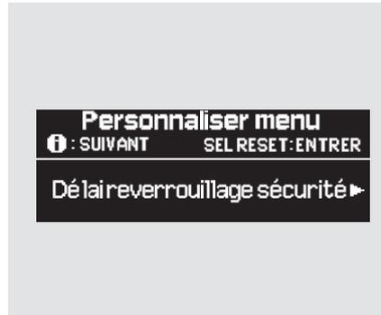
Pendant que l'affichage multi-information montre "Réglage portes/vitres", appuyer sur le bouton "SEL/RESET" sur le volant. Puis, appuyer sur le bouton INFO de manière répétée jusqu'à l'affichage de "Délai reverrouillage sécurité" tel que représenté ci-dessus.
