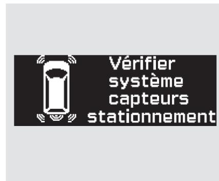
Si le système est défectueux, le message “Vérifier système capteurs stationnement” paraîtra sur l’affichage multi-information et un signal sonore se fait entendre continuellement. Bien souvent, un capteur couvert de boue, de glace, de neige, etc., est la cause de ce message. Vérifier tout d’abord les capteurs. Si le message reste affiché ou que le signal sonore n’arrête pas, faire vérifier le système par le concessionnaire.
