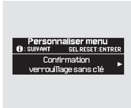
Pendant que l'affichage multi-information montre “Réglage portes/vitres”, appuyer sur le bouton “SEL/RESET” sur le volant. Puis, appuyer sur le bouton INFO de manière répétée pour voir “Confirmation verrouillage sans clé” tel que représenté ci-dessus.
