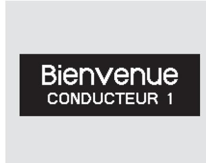
Quand on déverrouille et qu'on ouvre la portière du conducteur avec l'émetteur à distance, l'affichage montre "Bienvenue CONDUCTEUR 1" ou "Bienvenu CONDUCTEUR 2" selon l'émetteur à distance utilisé. L'identification du conducteur est détectée par l'émetteur. Pour de plus amples renseignements sur l'identification du conducteur, consulter la page 149.
