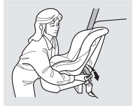
1. Quand le siège d'enfant est à la position souhaitée à l'arrière, faire passer la ceinture de sécurité dans le siège conformément aux directives du fabricant du siège puis insérer la languette dans le fermoir.
