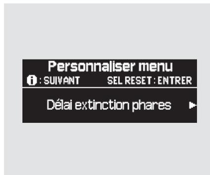
Pendant que l'affichage multi-information montre "Réglage éclairage", appuyer sur le bouton "SEL/RESET" sur le volant. Puis, appuyer sur le bouton INFO pour afficher "Délai extinction phares" tel que représenté ci-dessus.
