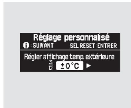
Appuyer sur le bouton "SEL/RESET". L'affichage change tel que représenté ci-dessus. Le chiffre surbrillé est l'ajustement courant audessus ou sous la température extérieure. Appuyer sur le bouton INFO de manière répétée jusqu'à l'affichage du chiffre exact et appuyer sur le bouton "SEL/RESET" pour programmer le choix.
