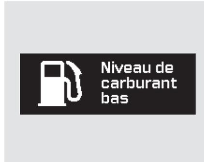
Si le niveau d’essence est bas dans le réservoir, “Niveau de carburant bas” s’affiche et il faut faire le plein le plus tôt possible. Le témoin du bas niveau de l’essence du tableau de bord s’allumera aussi.
