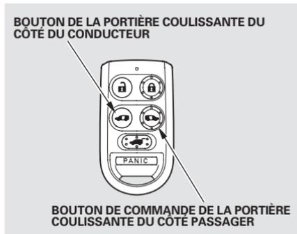
On peut ouvrir ou fermer chaque porte coulissante arrière avec l'émetteur à distance quand les portières sont déverrouillées. Appuyer de manière continue sur le bouton droit pour ouvrir ou fermer la portière du côté du passager et sur le bouton gauche pour ouvrir ou fermer la portière du côté conducteur.
