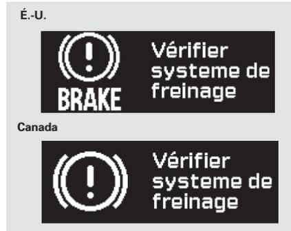
Si le système des freins est défectueux, “Vérifier système de freinage” paraîtra sur l’affichage multi-information. Les témoins du frein de stationnement et du système des freins s’allumeront sur le tableau de bord. Consulter la page 473 pour de plus amples renseignements.
