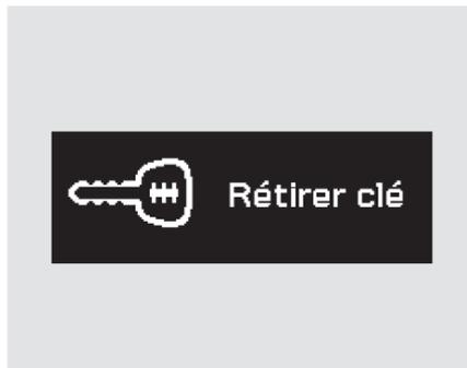
Si on laisse la clé dans l'interrupteur d'allumage à la ANTIVOL (0) ou ACCESSOIRE (I) et qu'on ouvre la portière du conducteur, "Rétirer clé" s'affichera et un signal sonore se fera entendre.
