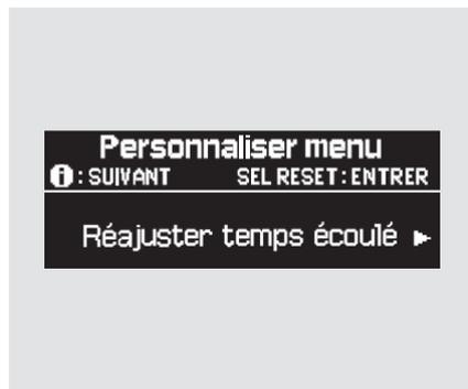
Avec l'affichage multi-information à "Réglage indicateurs" de "Personnaliser groupe", appuyer sur le bouton "SEL/RESET" sur le volant. L'affichage passe à "Personnaliser menu". Appuyer sur le bouton INFO de manière répétée jusqu'à ce que "Réajuster temps écoulé" paraisse sur le segment inférieur tel que représenté ci-dessus.
