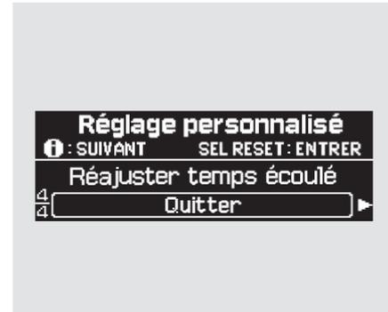
Pour quitter "Réajuster temps écoulé" appuyer sur le bouton INFO jusqu'à l'affichage de "Quitter" et appuyer sur le bouton "SEL/RESET".
