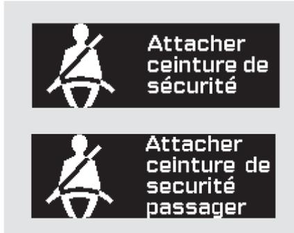
En plus du témoin des ceintures de sécurité sur le tableau de bord, l'affichage multi-information interrompt l'affichage courant et indique "Attacher ceinture de sécurité" ou "Attacher ceinture de sécurité passager" si la ceinture de sécurité n'est pas attachée pendant la conduite. Ce message est répété s'il est ignoré et que l'occupant ne porte pas sa ceinture de sécurité pendant que le véhicule est en marche.
