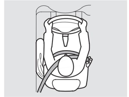
Dans le cas d'un choc latéral modéré à grave, des capteurs détectent le ralentissement rapide et commandent à l'unité de contrôle de déployer instantanément le coussin gonflable latéral du conducteur ou du passager et d'activer l'enrouleur de la ceinture de sécurité sur le côté affecté.
