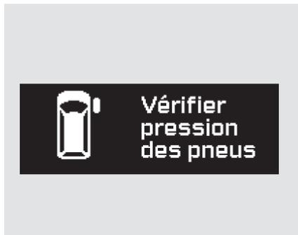
Si la pression de l’un ou plusieurs des pneus du véhicule est basse, le message “Vérifier pression des pneus” s’affiche. Consulter la page 391 pour de plus amples renseignements sur le système de surveillance de la pression des pneus (TPMS).
