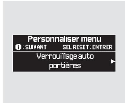
Pendant que l'affichage multi-information montre "Réglage portes/vitres", appuyer sur le bouton "SEL/RESET" sur le volant. L'affichage passe à "Verrouillage auto portières" tel que représenté ci-dessus.
