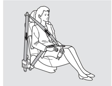
Pour une protection accrue, les ceintures de sécurité avant sont équipées d'enrouleurs automatiques. Quand ils sont activés, les enrouleurs tendent immédiatement les ceintures afin de retenir le conducteur et le passager avant en place.
