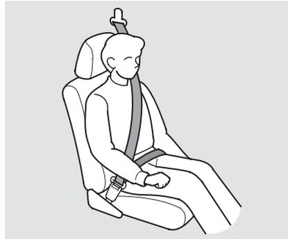
Faire passer la partie sous-abdominale de la ceinture le plus bas possible en travers des hanches, puis tirer sur le boudrier pour bien ajuster la ceinture. De cette façon, le bassin amortira la force lors d'une collision et réduira les risques de blessures internes.
