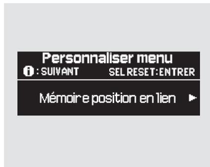
Pendant que l'affichage montre “Réglage position”, appuyer sur le bouton “SEL/RESET” sur le volant. L'affichage passe à “Mémoire position en lien” tel que représenté ci-dessus.
