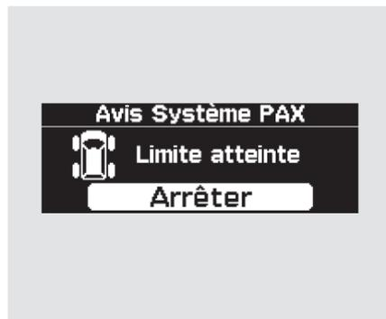
Si le message ci-dessus paraît sur l'affichage multi-information, la limite du roulement à plat a été atteinte et il faut arrêter immédiatement. Sinon, le niveau du bruit et de la vibration du pneu augmentera substantiellement et le pneu ne pourrait peut-être pas être réparé.
