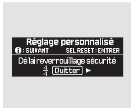
Pour quitter "Délai reverrouillage sécurité", appuyer sur le bouton INFO jusqu'à l'affichage de "Quitter", puis appuyer sur le bouton "SEL/RESET".
