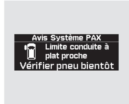
Si l'affichage passe au message ci-dessus, cela veut dire que "Conduite à plat" approche de sa limite et qu'il faudra bientôt arrêter. Confier le véhicule à un concessionnaire Honda ou à un détaillant agréé du système Michelin PAX le plus tôt possible.
