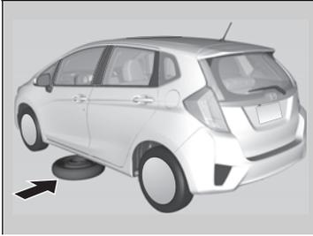
5. Placer le pneu de secours compact (roue vers le haut) sous la carrosserie du véhicule, près du pneu à remplacer.
