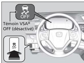
Ce bouton se trouve sur le panneau de commandes côté conducteur. Pour activer et désactiver le système VSA®, maintenir le bouton enfoncé jusqu'à l'obtention d'un signal sonore.
