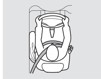
En cas de choc latéral modéré à grave, les capteurs détecteront l'accélération rapide et transmettront un signal à l'unité de contrôle de déployer instantanément le coussin gonflable latéral du conducteur ou du passager.
