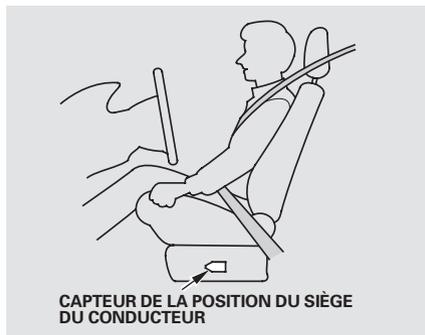
**CAPTEUR DE LA POSITION DU SIÈGE
