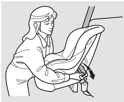
1. Quand le siège d'enfant est à la position souhaitée à l'arrière, acheminer la ceinture de sécurité dans le siège d'enfant conformément aux directives du fabricant du siège puis insérer la languette dans le fermoir et bien serrer la partie abdominale de la ceinture de sécurité.
