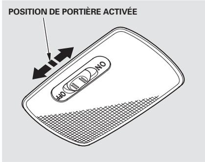
Le plafonnier est doté d'un interrupteur à trois positions: "ON" (allumé), "Door Activated" (allumé par la portière) et "OFF" (éteint). À la position "Door Activated" (au centre), la lampe s'allume quand:
