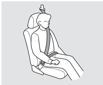
Faire passer la partie sous-abdominale de la ceinture le plus bas possible en travers des hanches, puis tirer sur le baudrier pour bien ajuster la ceinture. De cette façon, le bassin amortira la force lors d'une collision et réduira les risques de blessures internes.
