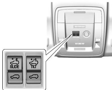
Selon l'équipement, le toit ouvrant fonctionne si l'interrupteur d'allumage est en position ON/RUN (en fonction/marche) ou ACC/ACCESSORY (accessoires) ou lorsque le mode de prolongation de l'alimentation des accessoires (RAP) est activé. Se reporter à *Prolongation de l'alimentation des accessoires (RAP)* à la page 9-35.
