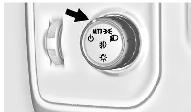
La commande d'éclairage extérieur se trouve sur le tableau de bord, à gauche du volant.
