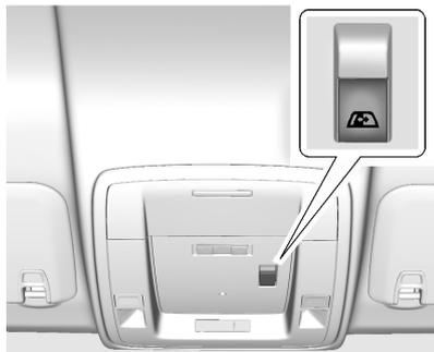
Si le véhicule en est équipé, la glace arrière coulissante à commande électrique fonctionne quand le commutateur d'allumage est en position ACC/ACCESSORY (accessoires) ou ON/RUN (en fonction/marche) ou quand la prolongation de l'alimentation des
