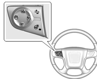
Appuyer sur le bouton d'alerte de collision qui se trouve sur le volant de direction pour régler le minutage du FCA sur Far (loin), Medium (moyen), Near (proche) ou Off (arrêt). Une première pression du bouton affiche le réglage actuel de la commande sur le centralisateur informatique de bord (CIB). Des pressions additionnelles du bouton changera ce réglage. Le réglage choisi demeurera le même jusqu'à ce qu'il soit changé et affectera le
