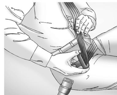
Lorsque vous utiliser la ceinture à trois points en position centrale arrière dans une cabine multiple, si la ceinture s'arrête avant d'atteindre la boucle, incliner la plaque de blocage et continuer à tirer la ceinture jusqu'à ce que vous puissiez la boucler.
