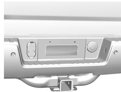
Pour les véhicules équipés d'un dispositif de remorquage pour service intensif, le connecteur de faisceau est monté dans le parechoc. Le faisceau à sept fils contient les circuits de remorquage suivants :
