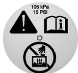
**Bouchon du réservoir d'expansion du liquide de refroidissement léger.**
