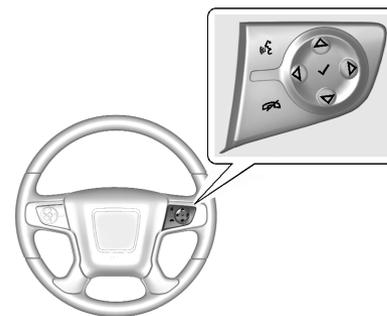
Certaines commandes audio peuvent s'effectuer au volant, si le véhicule est équipé en conséquence.
