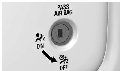
Pour désactiver le sac gonflable frontal du passager externe, introduire la clé de contact dans le commutateur et tourner le commutateur en position d'arrêt.
