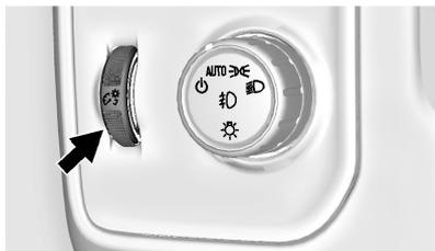
Ce dispositif contrôle l'intensité de l'éclairage du volant et du tableau de bord. La commande d'éclairage du tableau de bord se trouve près de la commande d'éclairage extérieur.
