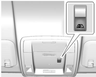
Si le véhicule en est équipé, la glace arrière coulissante à commande électrique fonctionne quand la clé de contact occupe les positions ACC/ACCESSORY (accessoires), ON/RUN (marche) ou quand la prolongation de l'alimentation des accessoires
