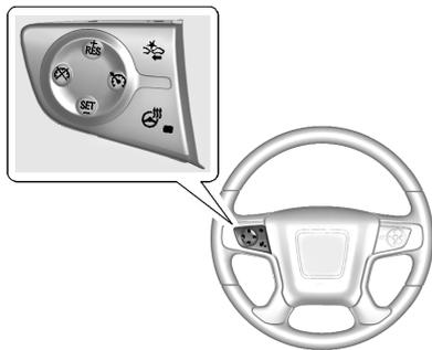
**➡ (marche/arrêt):** Presser pour activer ou désactiver le régulateur de vitesse. Le témoin s'allume en blanc lorsque le régulateur de vitesse est activé et s'éteint lorsqu'il ne l'est pas.
