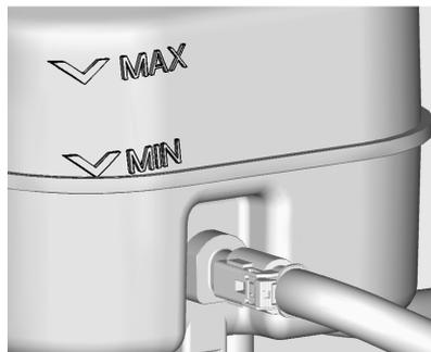
Le niveau de liquide doit se trouver au-dessus du repère MIN (minimum). Sinon, faire vérifier le circuit hydraulique de frein pour s'assurer de l'absence d'une fuite.
