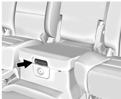
Selon l'équipement d'un rangement de la console de plancher sur le siège avant, déverrouiller avec la clé de contact, appuyer sur le bouton et soulever pour ouvrir.
