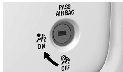
Pour désactiver le sac gonflable du passager avant externe, introduire la clé de contact dans le commutateur et tourner le commutateur en position de marche.
