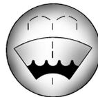
Enlever le bouchon marqué du symbole de lave-glace. Ajouter du liquide jusqu'à ce que le réservoir soit plein. Se reporter à *Aperçu du compartiment moteur* à la page 10-6 pour connaître l'emplacement du réservoir.
