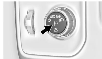
Sur les véhicules équipés de feux antibrouillard, la commande se trouve au centre de la commande d'éclairage extérieur, à gauche de la colonne de direction.
