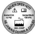
1. Vous pouvez enlever le bouchon de pression de radiateur lorsque le système de refroidissement, y compris la durite supérieure du radiateur, est refroidi. Tourner lentement le bouchon de pression dans le sens inverse des aiguilles d'une montre, d'environ un tour complet.
