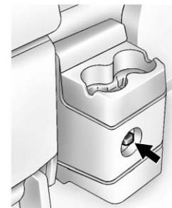
5. Placer le couvercle et insérer et serrer l'écrou à oreille pour le fixer.
