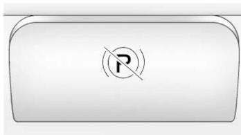
Pour desserrer le frein de stationnement, maintenir enfoncée la pédale des freins ordinaires. Tirer sur le bord inférieur du levier, qui se trouve au-dessus de la pédale du frein de stationnement et qui affiche le symbole du frein de stationnement, directement vers l'arrière pour desserrer le frein de stationnement.
