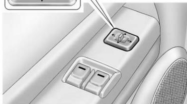
Les commandes des rétroviseurs extérieurs à commandes électriques se trouvent sur l'accoudoir de la porte du conducteur.
