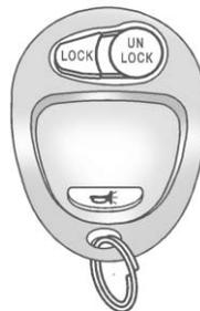
**UNLOCK (déverrouillage):** Presser pour déverrouiller la porte du conducteur et allumer l'éclairage intérieur. Les feux de stationnement peuvent également clignoter et l'avertisseur sonore se déclencher lorsque ce bouton est pressé.
