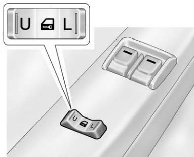
Les véhicules à serrures électriques, les commutateurs se trouvent sur l'accoudoir des portes avant.
