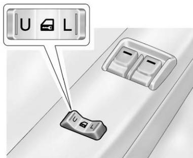
Sur les véhicules équipés de serrures électriques, les commutateurs se trouvent sur l'accoudoir des portes avant.
