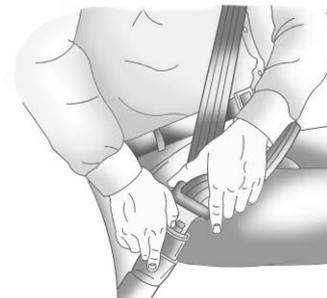
Pour détacher la ceinture, pousser le bouton de la boucle. La ceinture doit revenir en position de rangement. Relever la plaque de verrouillage sur la sangle lorsque la ceinture n'est pas utilisée. La plaque de verrouillage doit reposer sur la couture de la ceinture, près de la boucle de guidage de la paroi latérale.
