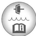
Le bouchon du réservoir du liquide d'embrayage hydraulique arbore ce symbole. Se reporter à la rubrique *Aperçu du compartiment moteur à la page 10-6* pour connaître l'emplacement du réservoir.
