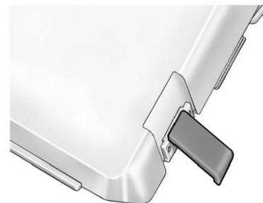
Pour ouvrir un casier de rangement, décrocher la partie inférieure des loquets et lever les loquets de part et d'autre du casier de rangement.
