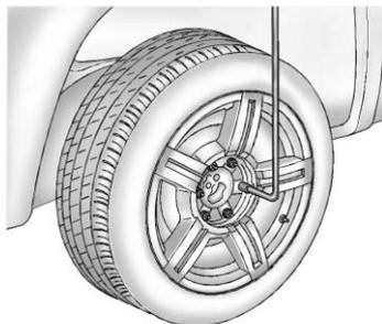
3. Tourner la clé de roue vers la gauche pour desserrer tous les écrous de roue. Ne pas enlever les écrous de roue tout de suite.
