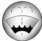
Enlever le bouchon marqué du symbole de lave-glace. Ajouter du liquide jusqu'à ce que le réservoir soit plein. Se reporter à *Aperçu du compartiment moteur à la page 10-6* pour connaître l'emplacement du réservoir.
