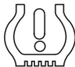
Si le témoin reste allumé pendant la conduite, vérifiez la pression des pneus. À cet effet, consultez la rubrique *Vérification de la pression de gonflage* de ce chapitre. Le témoin s'allumera aussi lorsque le pneu de secours temporaire est utilisé; consultez la rubrique *Changement d'un pneu* du chapitre *Dépannage*.
