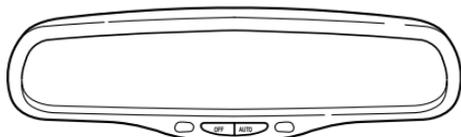
Le rétroviseur reprend sa position normale lorsque la boîte de vitesses passe en marche arrière (lorsque le rétroviseur est en fonction), ce qui assure une bonne visibilité vers l'arrière pendant le recul.
