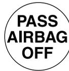
Le capteur de poids du passager avant est conçu pour désactiver le sac gonflable frontal du passager avant lorsqu'un siège d'enfant orienté vers l'arrière, un siège d'enfant orienté vers l'avant ou un rehausseur est détecté. Si un dispositif de retenue pour enfant est installé et que le témoin est éteint, coupez le contact, retirez le dispositif de retenue pour enfant du véhicule et installez-le de nouveau en suivant les directives du fabricant.
