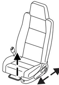
Tirez le levier situé sur le côté du coussin du siège vers le haut pour ajuster le dossier.
