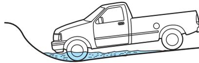
Après avoir traversé un plan d'eau, essayez toujours les freins, car des freins humides ne sont pas aussi efficaces que des freins secs. Pour accélérer le séchage des freins, freinez doucement à quelques reprises tout en roulant à basse vitesse.
