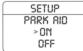
2. Appuyez sur la touche RESET (réinitialisation) pour mettre le sonar de recul en fonction ou hors fonction.
