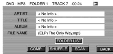
**COMP (compression) :** Cette fonction permet de diminuer l'écart de volume entre les passages doux et les passages forts afin d'harmoniser l'écoute des disques compacts et des disques MP3 en mode lecteur de disques compacts. Appuyez sur la touche COMP (compression) pour activer ou désactiver cette fonction.
