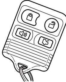
La fonction de verrouillage et de déverrouillage de l'entrée sans clé à télécommande fonctionne dans toutes les positions du commutateur d'allumage. La fonction de la glace de hayon est accessible tant que la vitesse du véhicule est inférieure à 5 km/h (3 mi/h). La fonction d'alarme de détresse est disponible lorsque le commutateur d'allumage est en position OFF/LOCK (arrêt-antivol) (1).
