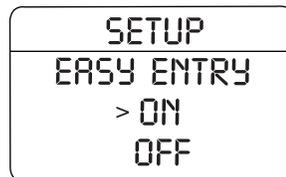
2. Appuyez sur la touche RESET pour activer ou désactiver le recul automatique du siège à l'entrée et à la sortie.
