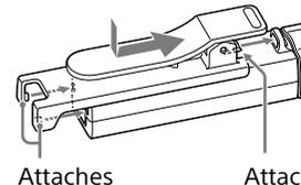
Placez le bandeau ajustable comme illustré et glissez-le dans la direction indiquée par la flèche jusqu'à ce que les trois attaches soient fermement fixées.
