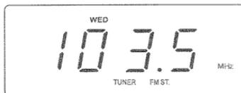
5.) Quelques secondes après avoir relâché les boutons de réglage, l'affichage des fréquences radio retournera à l'affichage de l'heure. Pour voir la fréquence radio de nouveau, appuyez sur le bouton **Time (Heure)** sur le panneau supérieur. L'affichage de l'heure changera pour l'affichage des fréquences radio durant quelques secondes puis retournera de nouveau à l'affichage de l'heure.
