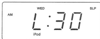
3.) Pour changer la durée d'endormissement, appuyez et maintenez le bouton Sleep et appuyez sur les boutons **Tuning/Skip (Réglage/Saut)**  $\wedge$  ou  $\vee$  +/- du panneau supérieur ou les boutons **◀ / ▶** de la télécommande pour augmenter ou réduire la durée d'endormissement de "01" minute à "99" minutes.
