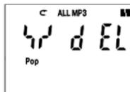
4. Pressez MODE pour confirmer. Si «No» est sélectionné, l'appareil retourne au mode précédent, si vous sélectionnez «Yes», «DEL» va s'afficher et le fichier en cours sera supprimé.
