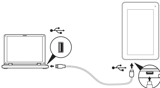
En utilisant le câble micro USB à USB, connectez l'extrémité micro dans votre tablette et l'autre extrémité dans votre ordinateur.
