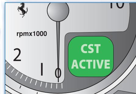
Dans des conditions de faible ou basse adhérence (chaussée mouillée, verglacée, sable, etc.) il ne faut pas désactiver le système CST.
