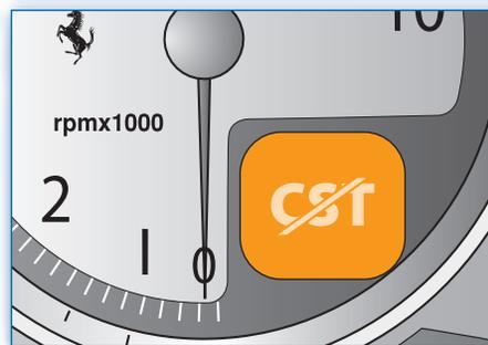
Si le système CST est activé, le déclenchement est signalé par le clignotement du témoin correspondant sur le tableau de bord et de l'idéogramme **CST ACTIVE** de couleur verte sur l'afficheur à fonctions multiples pendant un délai minimum de 4 secondes.
