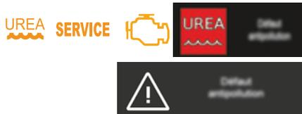
Les témoins UREA, SERVICE et autodiagnostic moteur s'allument, accompagnés d'un signal sonore et de l'affichage du message "Défaut antipollution". L'alerte se déclenche en roulant, lorsque le dysfonctionnement est détecté pour la première fois, puis à la mise du contact lors des trajets suivants, tant que la cause du dysfonctionnement persiste.
