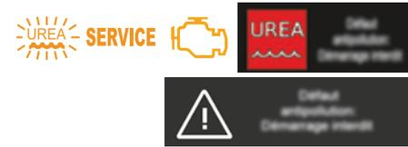
A chaque mise du contact, les témoins SERVICE et autodiagnostic moteur s'allument et le témoin UREA clignote, accompagnés d'un signal sonore et de l'affichage du message "Défaut antipollution : Démarrage interdit".
