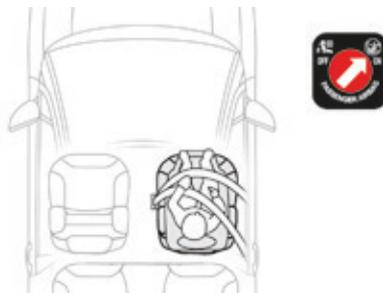
Lorsqu'un siège enfant "face à la route" est installé en **place passager avant**, réglez le siège du véhicule en position longitudinale intermédiaire, position la plus haute, dossier redressé et laissez l'airbag frontal passager actif.
