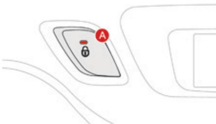
Système pour verrouiller ou déverrouiller manuellement et complètement les portes de l'intérieur.
