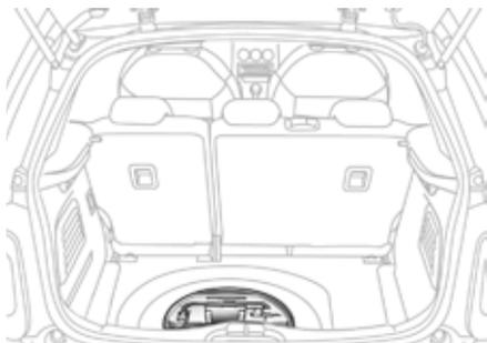
Les outils sont installés dans le coffre sous le plancher.
