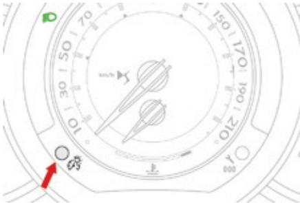
Système pour adapter manuellement l'intensité lumineuse du poste de conduite en fonction de la luminosité extérieure.
