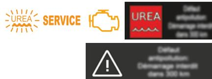
Si la défaillance du système SCR est confirmée (après 50 km parcourus avec l'affichage permanent du signalement d'un dysfonctionnement), les témoins SERVICE et autodiagnostic moteur s'allument et le témoin UREA clignote, accompagnés d'un signal sonore et de l'affichage d'un message (ex : "Défaut antipollution : Démarrage interdit dans 300 km") indiquant l'autonomie de roulage exprimée en kilomètres ou miles.
