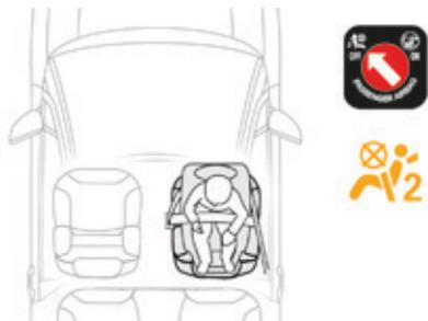
Lorsqu'un siège enfant "dos à la route" est installé en **place passager avant**, réglez le siège du véhicule en position longitudinale intermédiaire, position la plus haute, dossier redressé.
