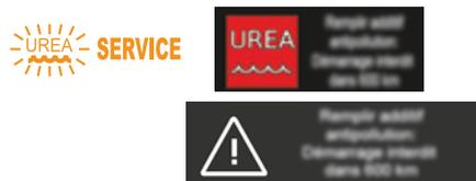
Dès la mise du contact, le témoin SERVICE s'allume et le témoin UREA clignote, accompagnés d'un signal sonore et de l'affichage d'un message (ex : "Remplir additif antipollution : Démarrage interdit dans 600 km") indiquant l'autonomie de roulage exprimée en kilomètres ou miles.
