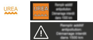
Dès la mise du contact, le témoin UREA s'allume, accompagné d'un signal sonore et de l'affichage d'un message (ex : "Remplir additif antipollution : Démarrage interdit dans 1 500 km") indiquant l'autonomie de roulage exprimée en kilomètres ou miles.
