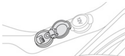
Ce boîtier de connexion, composé d'une prise JACK et d'un port USB, est situé sur la console centrale.
