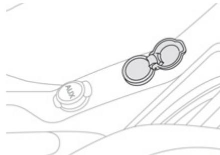
☞ Pour brancher un accessoire 12 V (puissance maxi : 120 Watts), retirez l'obturateur et branchez l'adaptateur adéquat.
