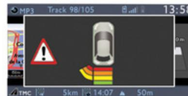
Lorsque la distance «arrière véhicule/obstacle» est inférieure à trente centimètres, le signal sonore devient continu et le symbole «Danger» apparaît sur l'écran multifonction. En fin de manœuvre, lorsque vous quittez la marche arrière, le système redevient inactif.
