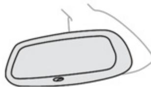
Grâce à un capteur, mesurant la luminosité provenant de l'arrière du véhicule, ce système assure automatiquement et progressivement le passage entre les utilisations jour et nuit.
