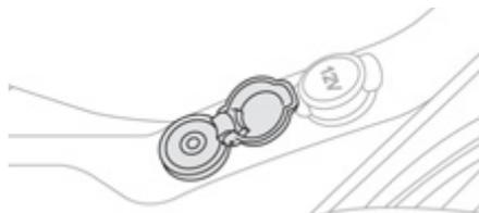
Ce boîtier de connexion, composé d'une prise JACK, est situé sur la console centrale.
