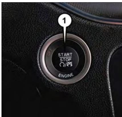
1 - Bouton Engine Start/Stop (Démarrage et arrêt du moteur)
