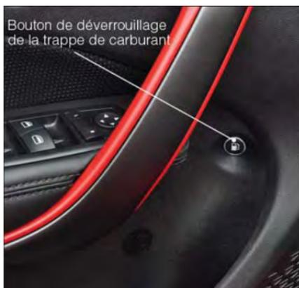
Bouton de déverrouillage de la trappe de carburant
