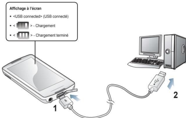
1. Branchez l'extrémité la plus étroite du câble USB sur le port de connexion USB situé dans la partie inférieure du lecteur.
