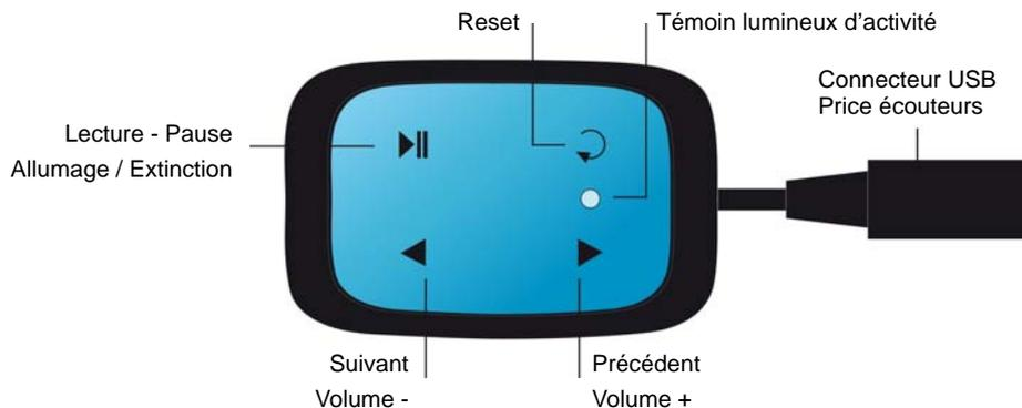
3. **Connexion des écouteurs** : insérez la fiche audio des écouteurs dans le câble d'extension audio étanche du lecteur
