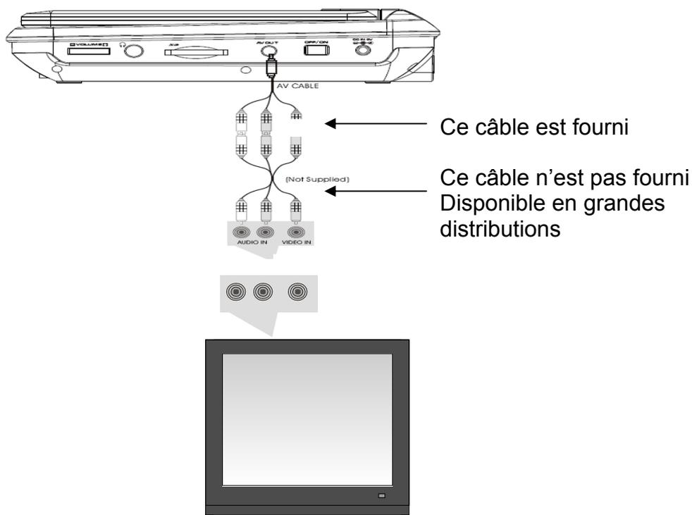
Utilisez le câble A/V pour relier l'appareil au téléviseur. Assurez-vous qu'il est correctement branché
