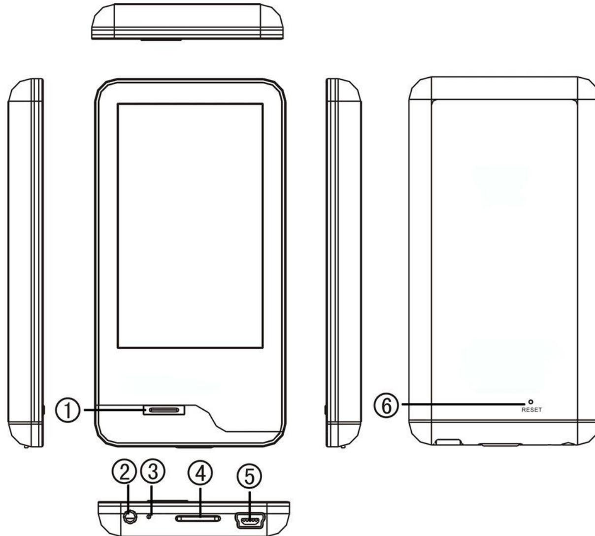
1. Marche/Arrêt (appui long 3 secondes environ) – Verrouillage/Déverrouillage de l'écran.
