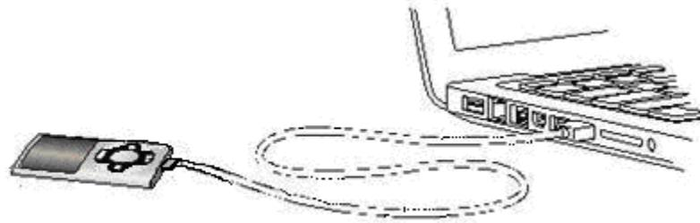
**Note :** Le temps de charge ne doit pas dépasser 3 heures. Il est recommandé d'éteindre l'appareil avant de le charger
