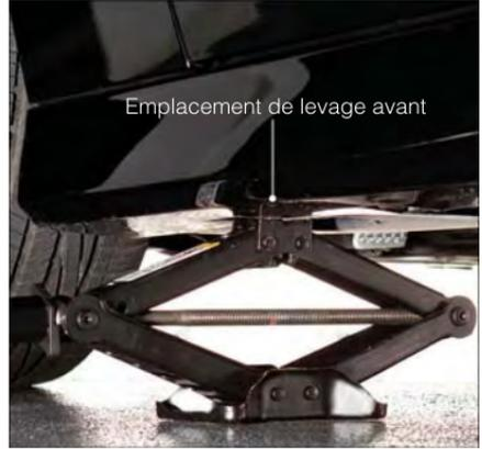
5. Soulevez le véhicule juste assez pour qu'il ne touche plus le sol, retirez la roue dont le pneu est crevé et installez la roue de secours.
