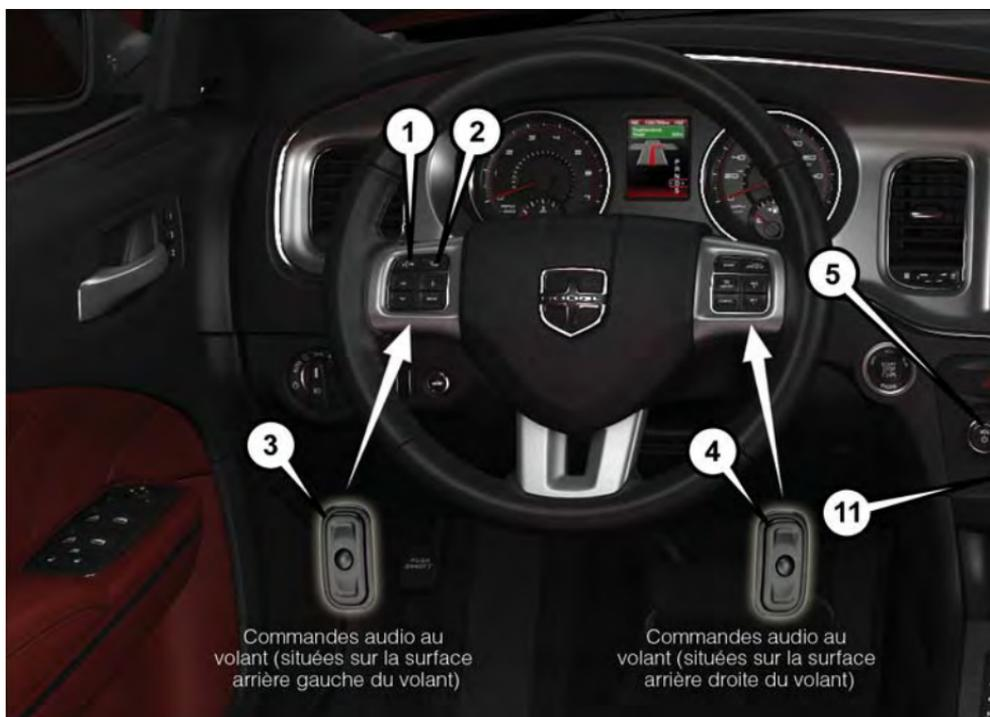
Commandes audio au volant (situées sur la surface arrière gauche du volant)
