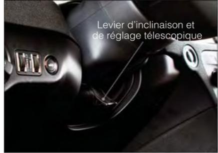
Levier d'inclinaison et de réglage télescopique
