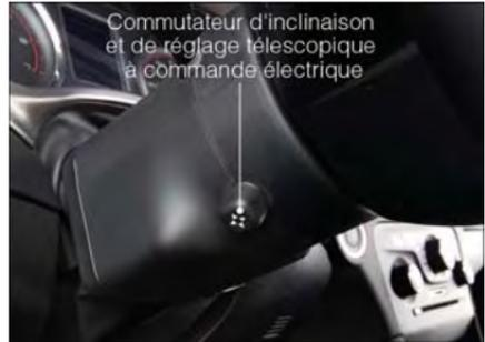
Commutateur d'inclinaison et de réglage télescopique à commande électrique
