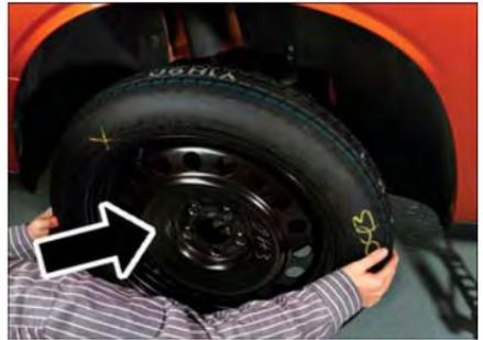
8. Installez les écrous de roue en dirigeant l'extrémité conique de l'écrou vers la roue. Serrez légèrement les écrous de roue.
