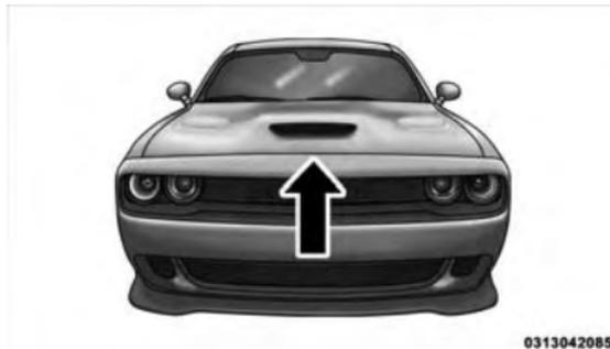
Emplacement du crochet de sécurité du capot
