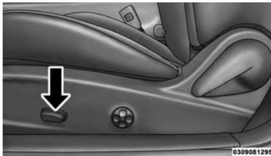
**Commutateur de siège à commande électrique**
