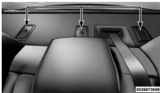
Ancrages de courroie d'attache
