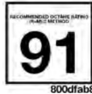
Ces moteurs sont conçus en conformité avec tous les règlements antipollution et offre une économie de carburant et un rendement excellents avec du supercarburant sans plomb de qualité supérieure d'un indice d'octane de 91 tel qu'indiqué par la méthode (R+M)/2. L'utilisation du supercarburant d'un indice d'octane de 91 ou plus est nécessaire pour ces moteurs.
