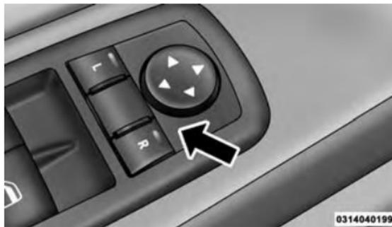
Commandes des rétroviseurs électriques
