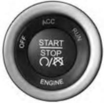
Cette fonction permet au conducteur d'actionner le commutateur d'allumage en enfonçant un bouton, pourvu que le bouton ENGINE START/STOP (DÉMARRAGE ET ARRÊT DU MOTEUR) soit en place et que la télécommande du système de démarrage à distance ou du système d'accès et de démarrage sans clé Keyless Enter-N-Go se trouve dans l'habitacle.
