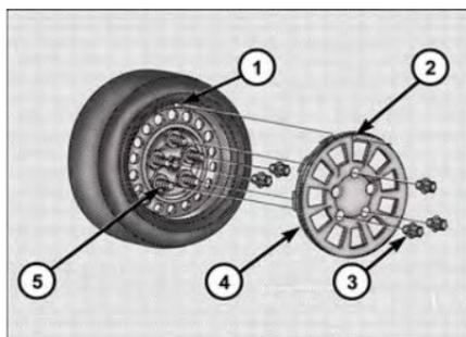
4. Installez les écrous de roue restants en orientant l'extrémité de l'écrou en forme de cône vers la roue. Serrez légèrement les écrous de roue.
