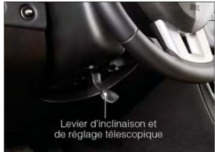
Levier d'inclinaison et de réglage télescopique
