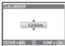
Permet d'afficher la pression atmosphérique et l'altitude/ profondeur pendant la prise de vue (de -10 m à 5 000 m). Un message d'avertissement s'affiche lorsqu'une profondeur sous l'eau proche de 10 m est atteinte.
