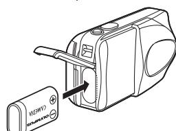
Cuando utilice una pila de litio CR-V3. Inserte la pila de la manera indicada en la ilustración.
