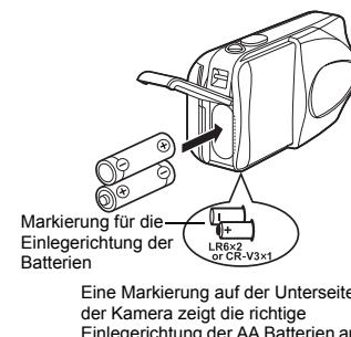
Bei Verwendung einer CR-V3 Lithium-Blockbatterie
