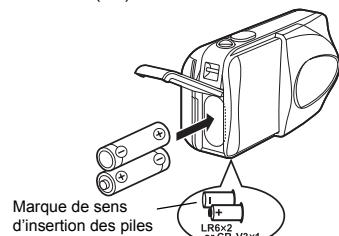
Une marque indique le sens d'insertion des piles AA en bas de l'appareil photo.
