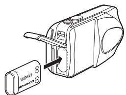
**4 Zum Schließen des Batteriefachdeckels drücken Sie ihn nach unten und schieben Sie ihn wie gezeigt in die richtige Richtung .**
