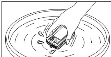
Suivez les étapes ① à ④, puis vérifiez que le couvercle de l'objectif fonctionne correctement. Si le couvercle de l'objectif ne bouge pas facilement, rincez la surface de l'objectif en le plaçant directement sous le puissant jet d'eau d'un robinet et appuyez plusieurs fois sur la touche ON/OFF.
