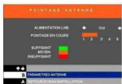
Quand le niveau est au vert et aux alentours de 3, l'installation est bien réglée et vous pouvez fixer la parabole dans cette position.
